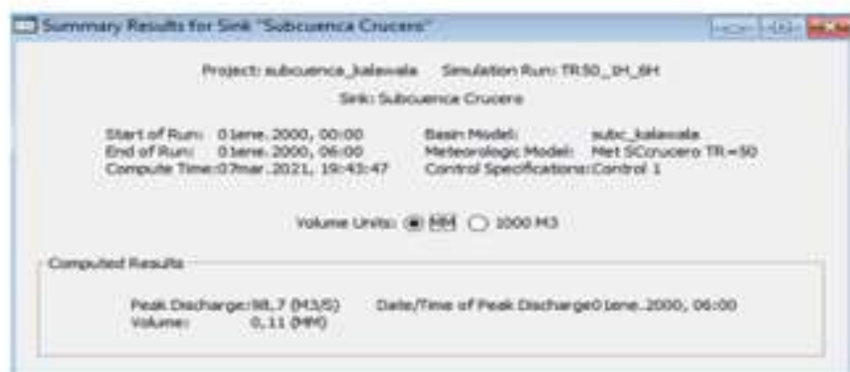
Figura 22. Caudal Máximo resultante para un T.R=50 Años Subcuenca Crucero.
