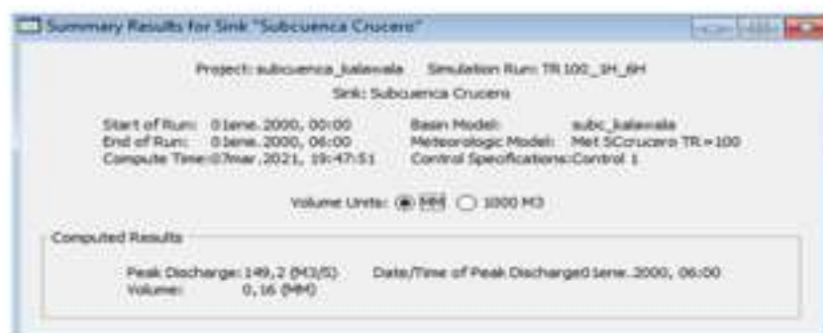
Figura 23. Caudal Maximo Resultante para un T.R = 100 Años Subcuenca Crucero
