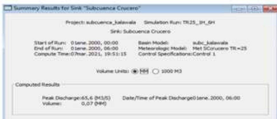
Figura 21. Caudal Máximo Resultante para un T.R=25 Años Subcuenca Crucero.
