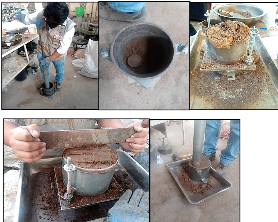
Figura 25 Compactado con el pison, enrasado de muestra y extracción
