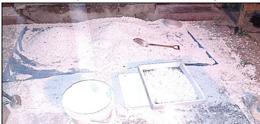
Figura 14 Trituración y molienda de los residuos de ignimbrita (sillar)
