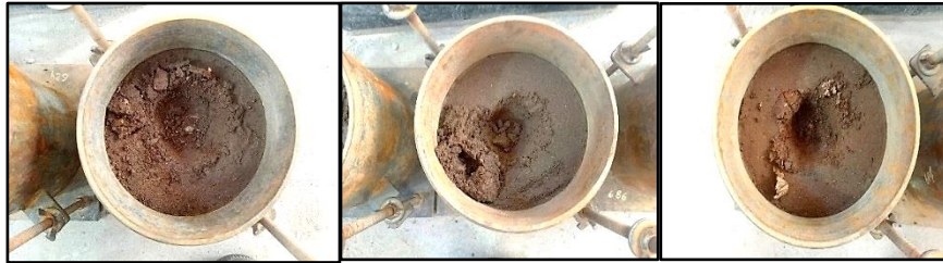
Figura 28 Probetas después de la penetración
