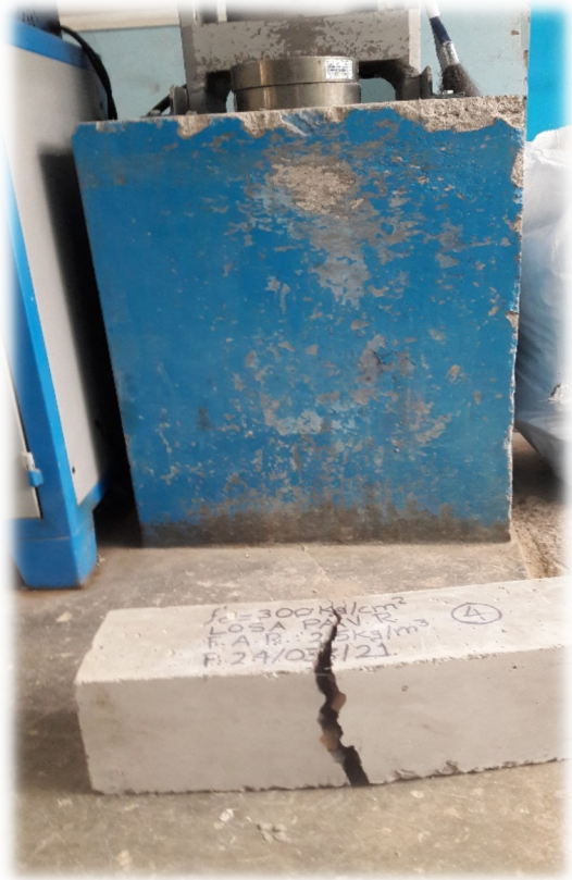
FOTO 23: Viga después de ser ensayada (25kg/m 3 )
