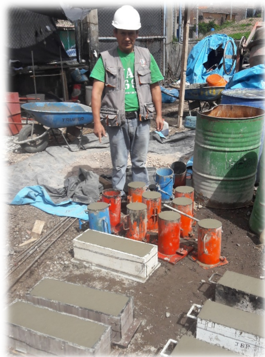
FOTO 10: Elaboración de briquetas cilíndricas y vigas
