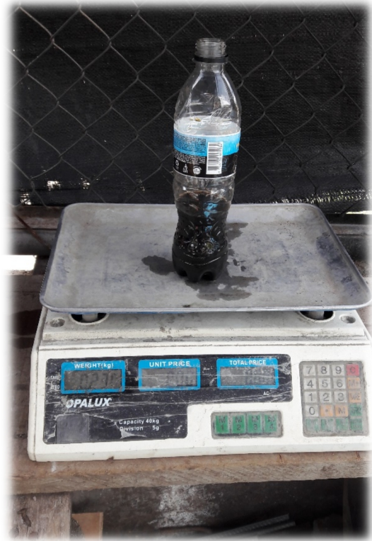
FOTO 7: Dosificación de aditivo Superplastificante DRAMIC
