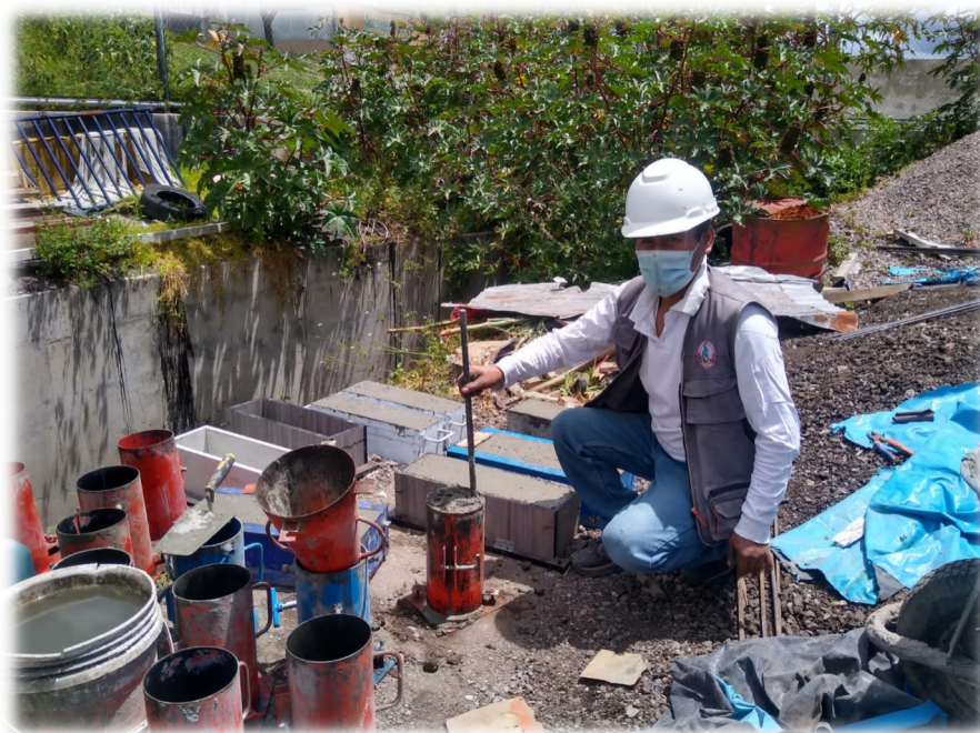
Figura N° 05: Elaboración de las muestras cilíndricas y prismáticas de concreto.
