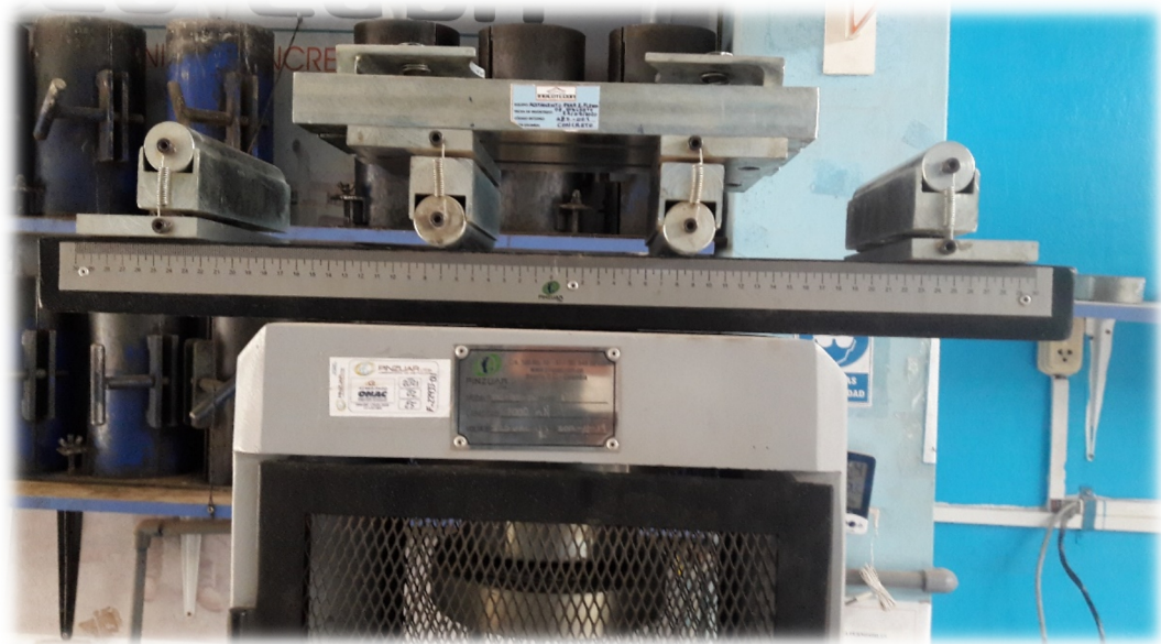
FOTO 20: Equipo adecuado para ensayar a flexión vigas con cargas a los tres tercios
