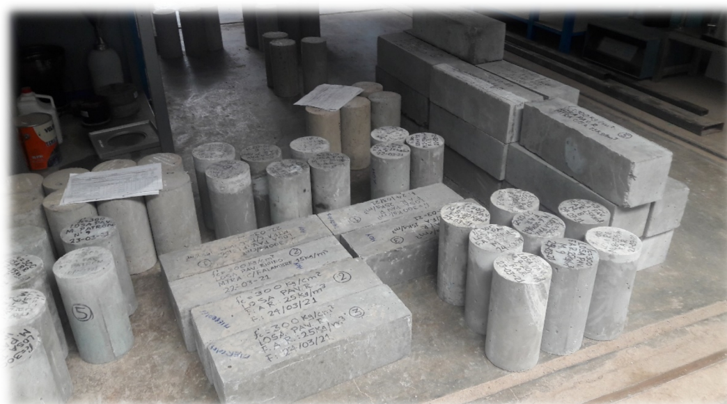
FOTO 14: Briquetas cilíndricas y prismáticas (viga) en las instalaciones del Laboratorio INGEOTECON
