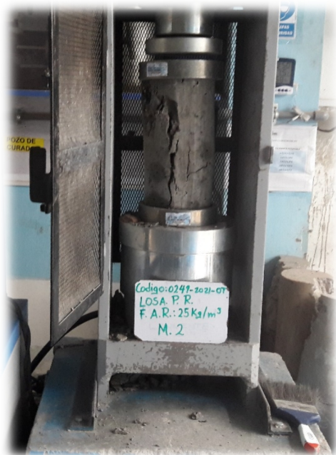
FOTO 17: Ensayo de resistencia a la compresión
