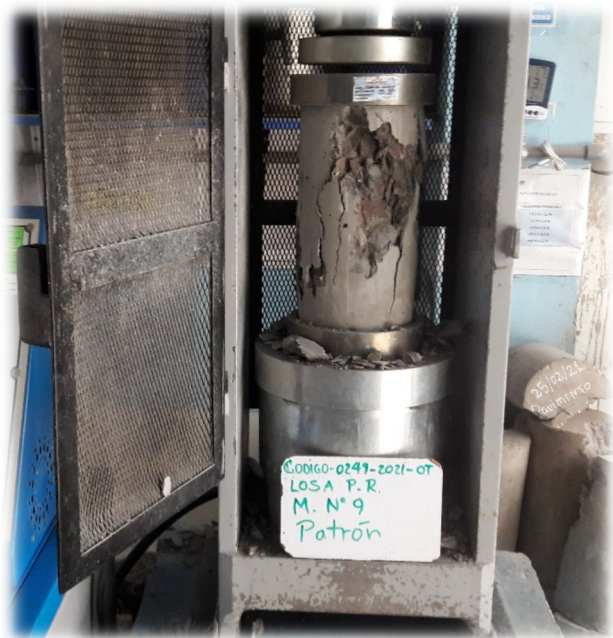
FOTO 18: Ensayo de resistencia a la compresión
