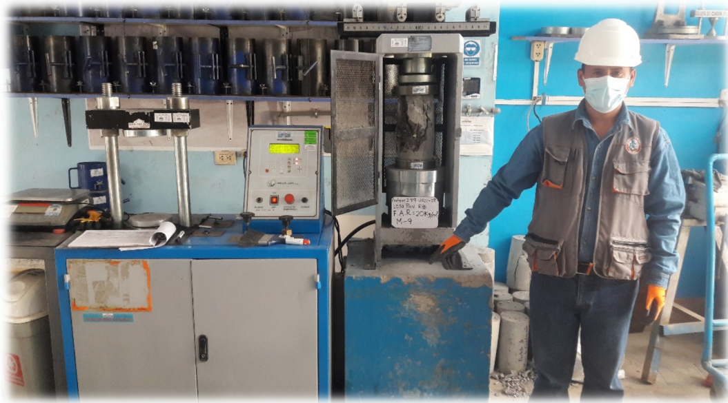
FOTO 19: Ensayo de resistencia a la compresión del espécimen con incorporación de 20kg/m 3 de fibras de alambre reciclado
