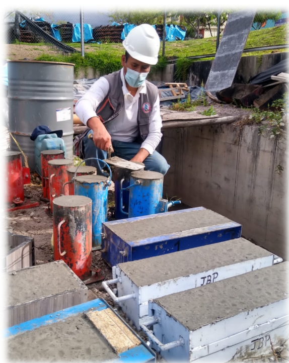
FOTO 11: Elaboración de briquetas cilíndricas y vigas
