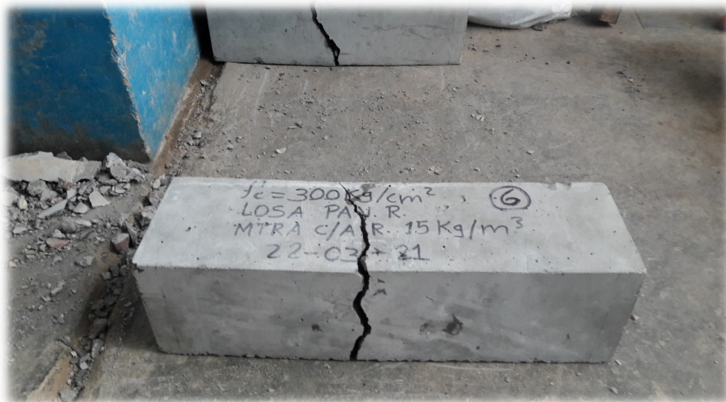
FOTO 21: Viga después de ser ensayada con incorporación de 15kg/m 3 de fibras de alambre
