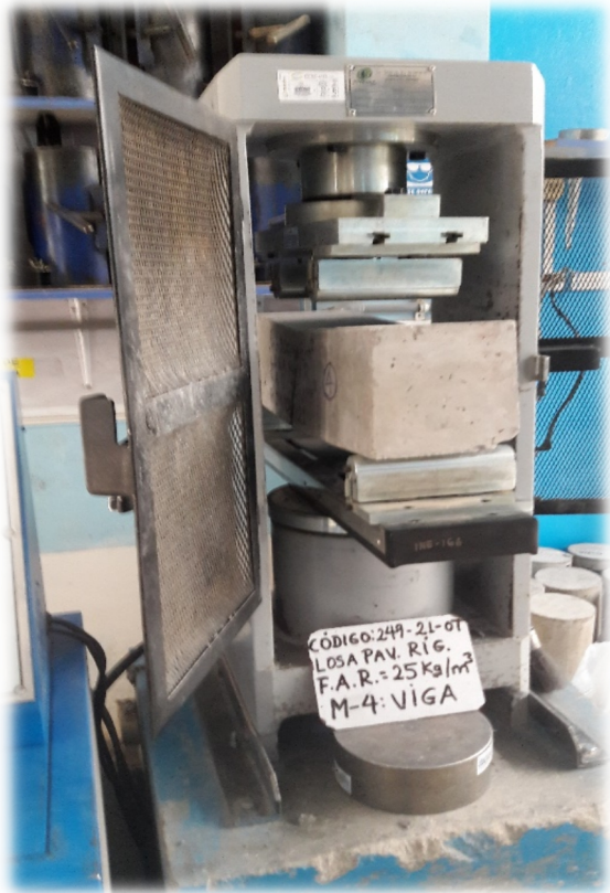
FOTO 22: Ensayo de resistencia a la flexión M -
