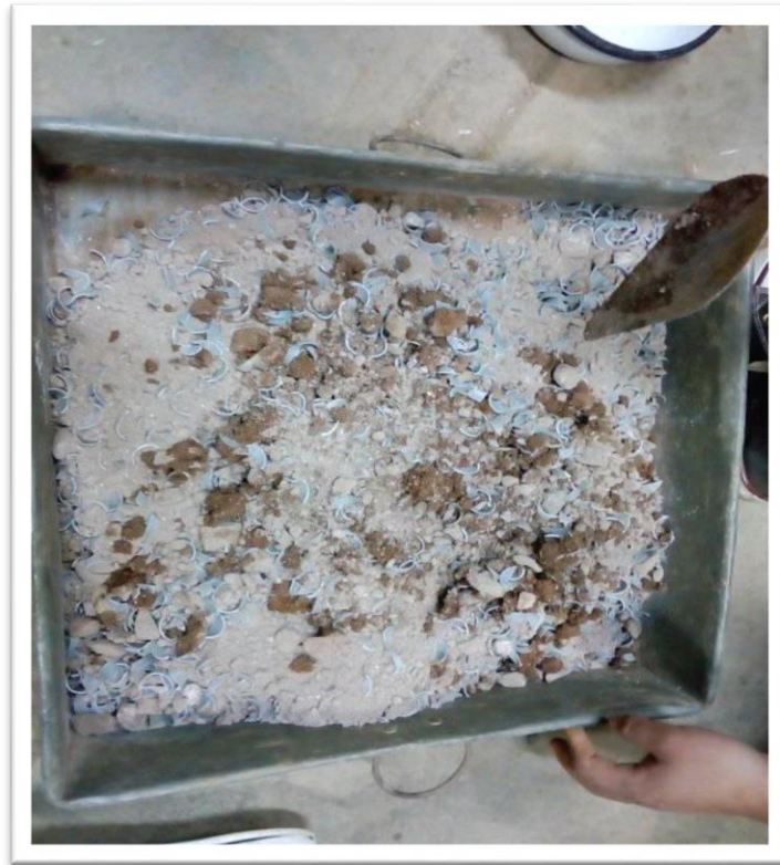
Mezcla del policloruro de vinilo y cal viva para el ensayo del Proctor Modificado.
