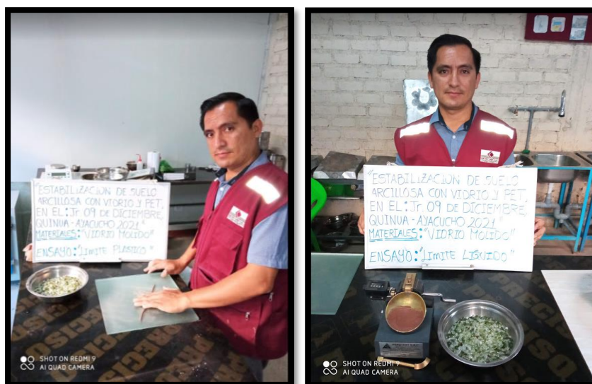
Figura 20. Ensayo limite plástico izquierda y limite liquido derecha.
