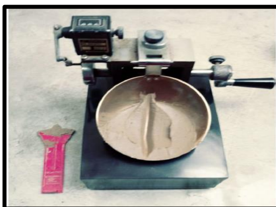
Figura 2. Cuchara Casagrande para determinar el límite líquido de un suelo
