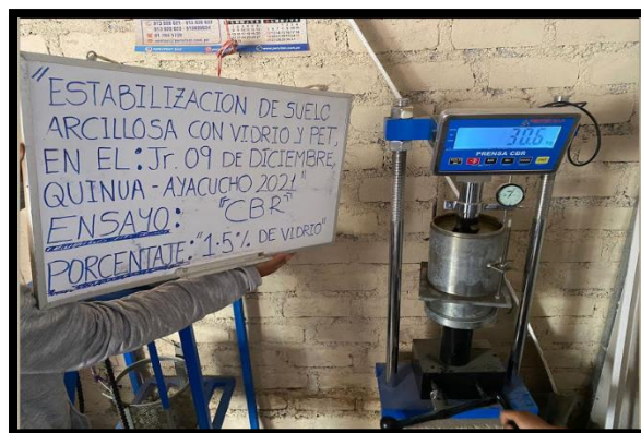
Figura 51. Muestra M-01 + 1.5% de vidrio en Ensayo CBR
