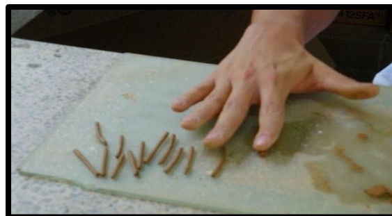
Figura 4. Ensayo de limite plástico en laboratorio.
