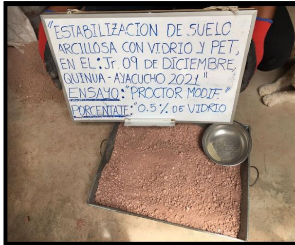
Figura 25. muestra M-01 + 0.5 % de vidrio para ensayo proctor.
