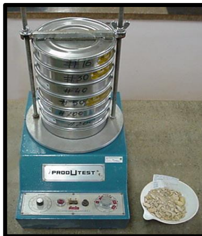
Figura 5. Columna de tamices para ensayo granulométrico
