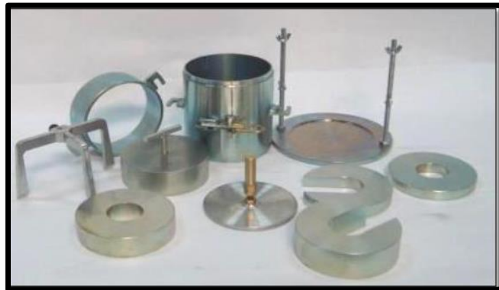
Figura 8. Molde y trípode de CBR.
