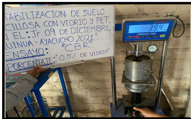
Figura 41. Muestra M-01 + 0.5% de vidrio en Ensayo CBR.
