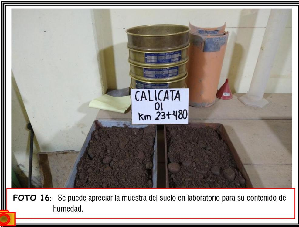
**FOTO 16:** Se puede apreciar la muestra del suelo en laboratorio para su contenido de humedad.
