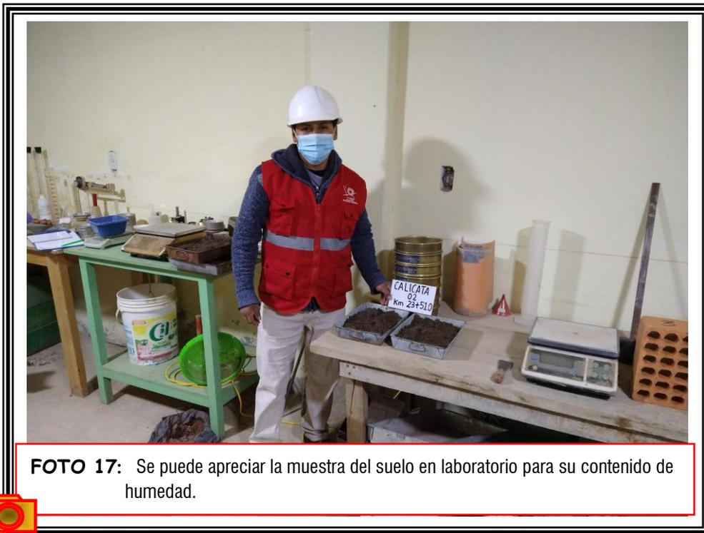
**FOTO 17:** Se puede apreciar la muestra del suelo en laboratorio para su contenido de humedad.
