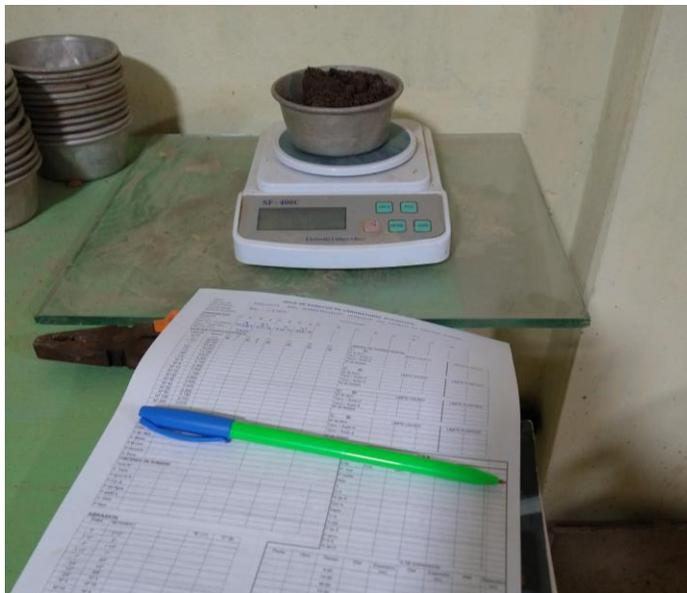
**FOTO 18:** Se puede apreciar tomando datos de los pesos de la humedad natural del suelo.
