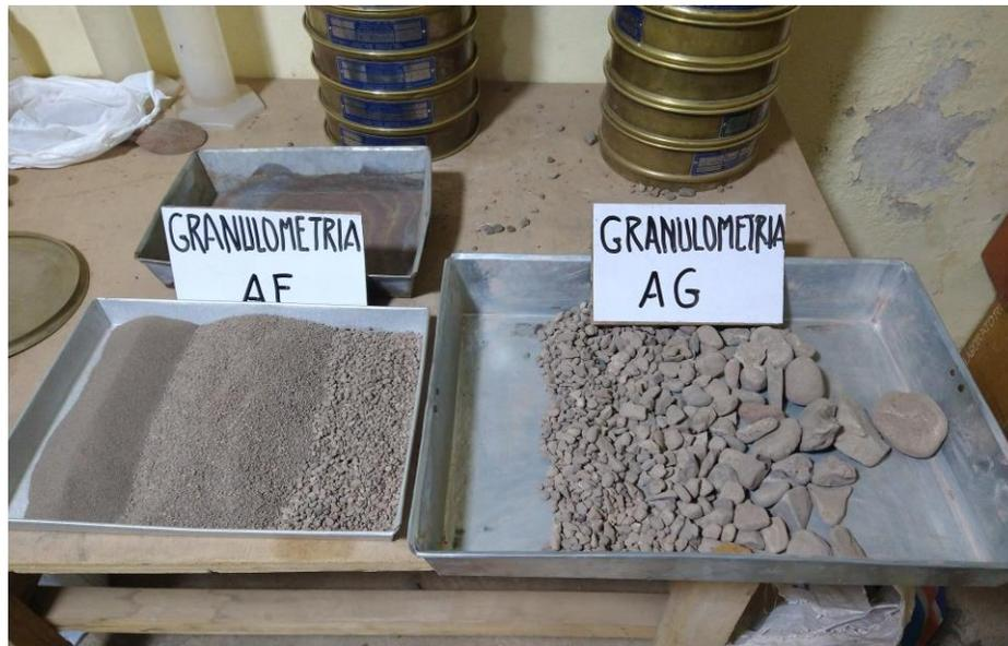
**FOTO 14:** Se puede apreciar la clasificación de la granulometría del tipo de suelo que como resultado de la clasificación SUCS (ASTM D-3282) GP.
