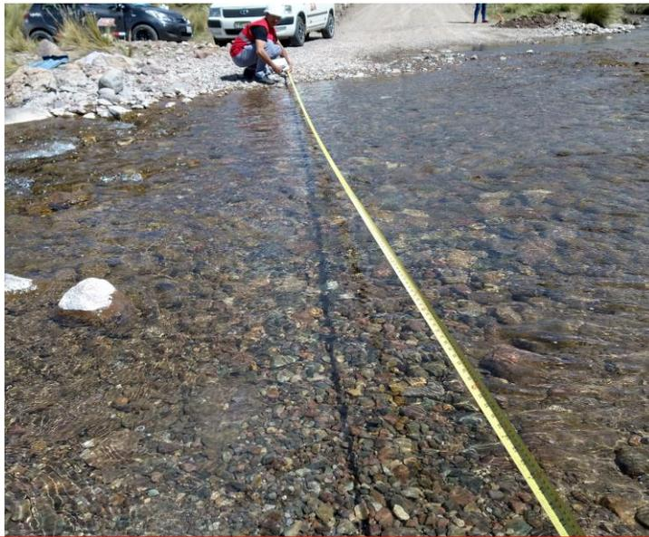
**FOTO 5:** Se puede observar tomando la medida del ancho del cauce del río en la progresiva 23+480 al 23+493.
