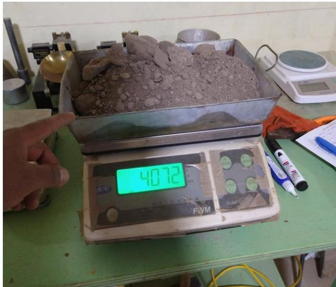
**FOTO 14:** Se puede apreciar tomando datos de la muestra su peso seco para la granulometría.
