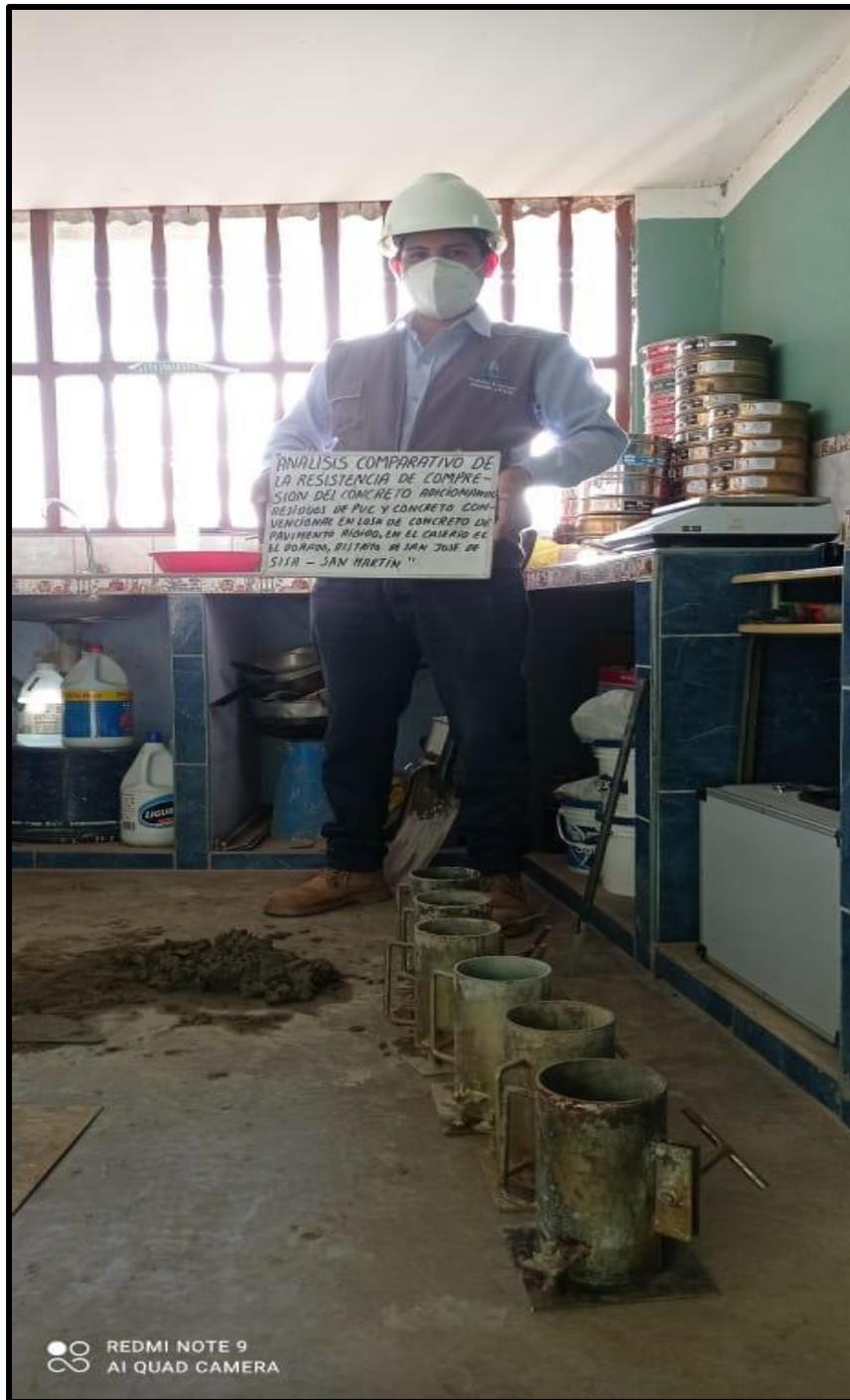
**Figura 15.** Llenado de probetas con concreto adicionando residuos de PVC
