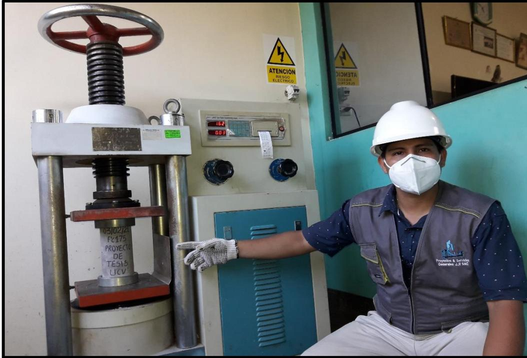
**Figura 19.** En la imagen se demuestra la rotura de testigos de concreto convencional
