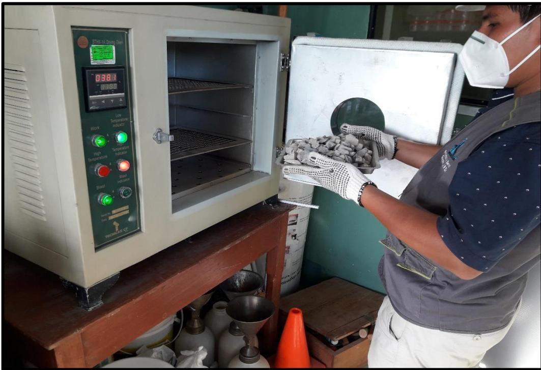
**Figura 5.** Colocación de la grava al horno para realizar la humedad natural
