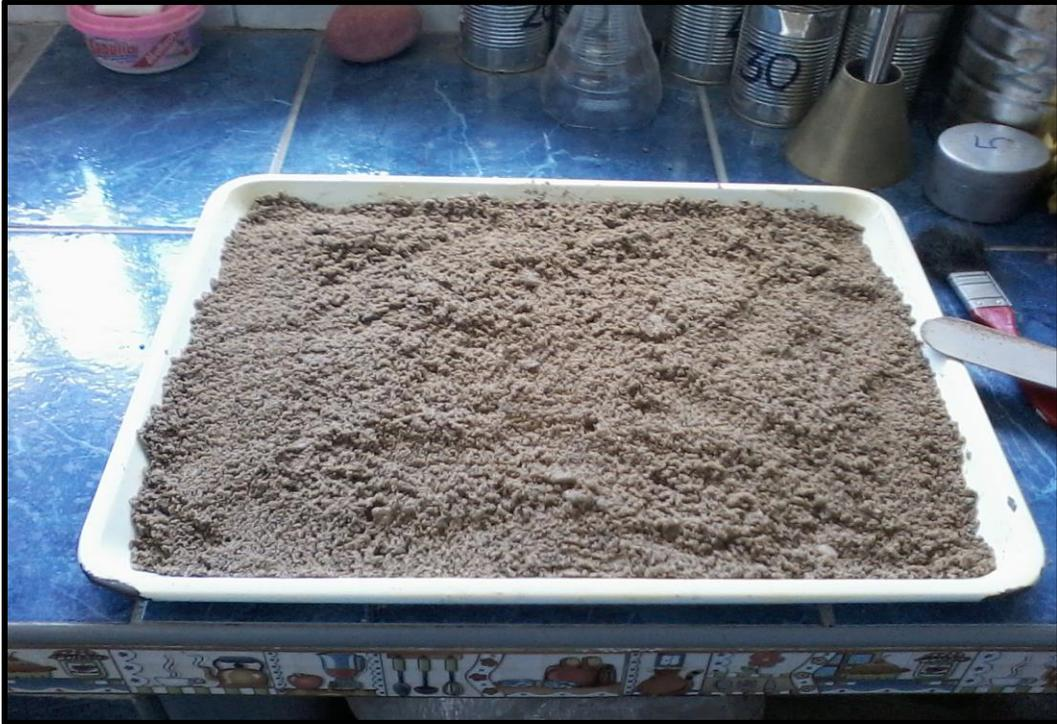
**Figura 10.** Fotografía demostrando el agregado fino para el ensayo de absorción
