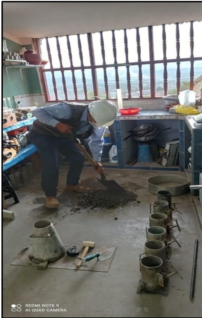
**Figura 13.** Preparación del diseño de mezcla adicionando los residuos de PVC
