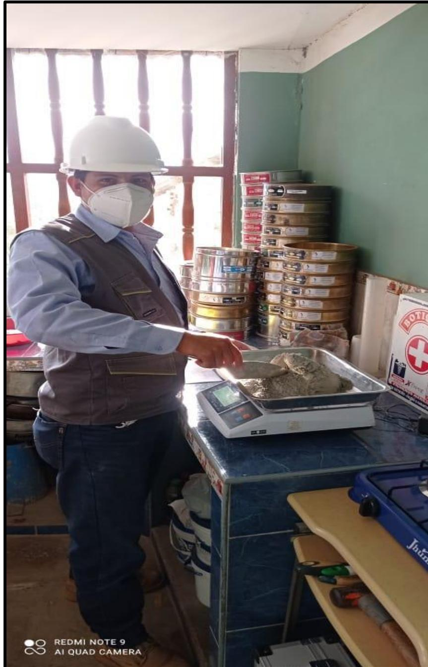
**Figura 9.** Se demuestra el peso del cemento para realizar el diseño de mezcla
