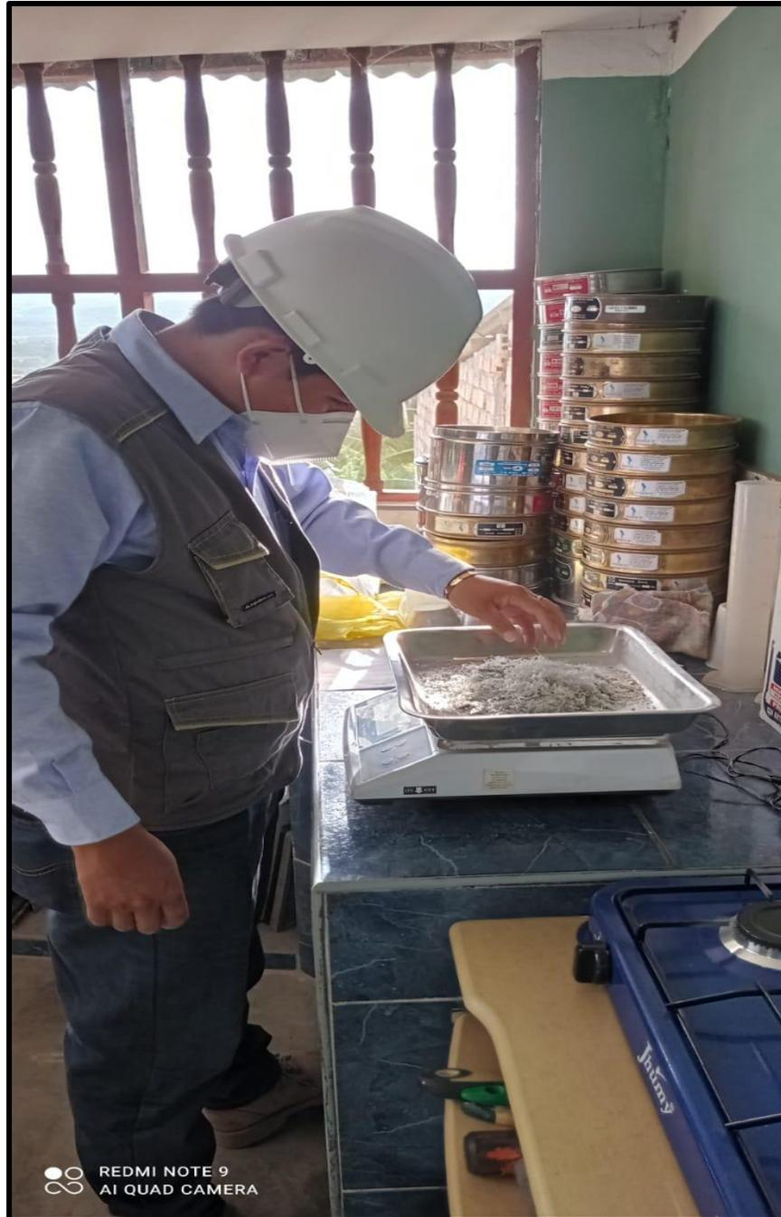
**Figura 3.** Peso de los residuos de PVC para adicionar al concreto convencional
