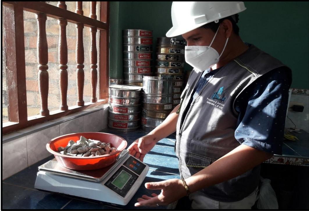
**Figura 4.** Peso de la grava para realizar el ensayo de peso unitario
