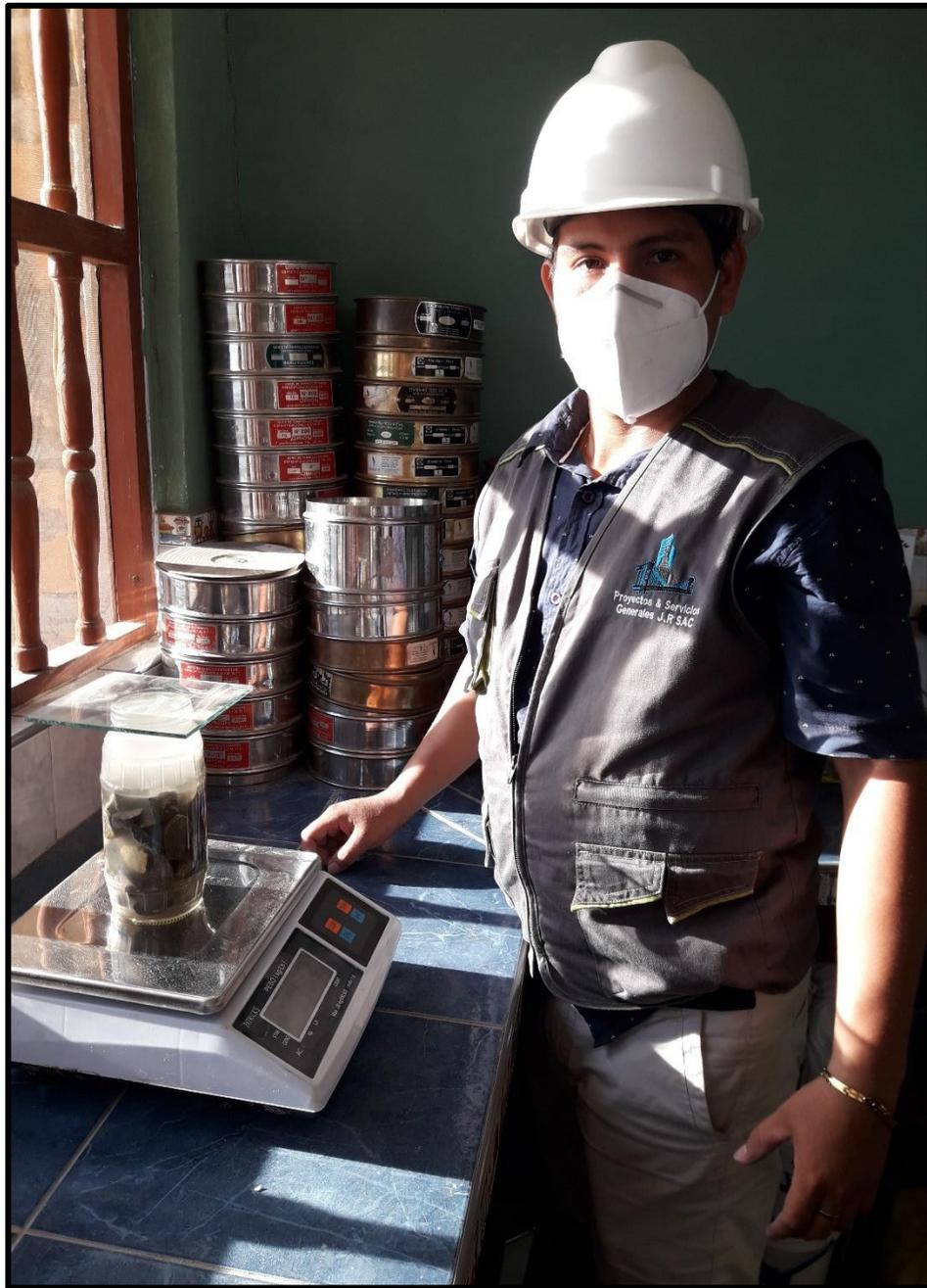
**Figura 6.** En la fotografía se demuestra el peso específico de la grava
