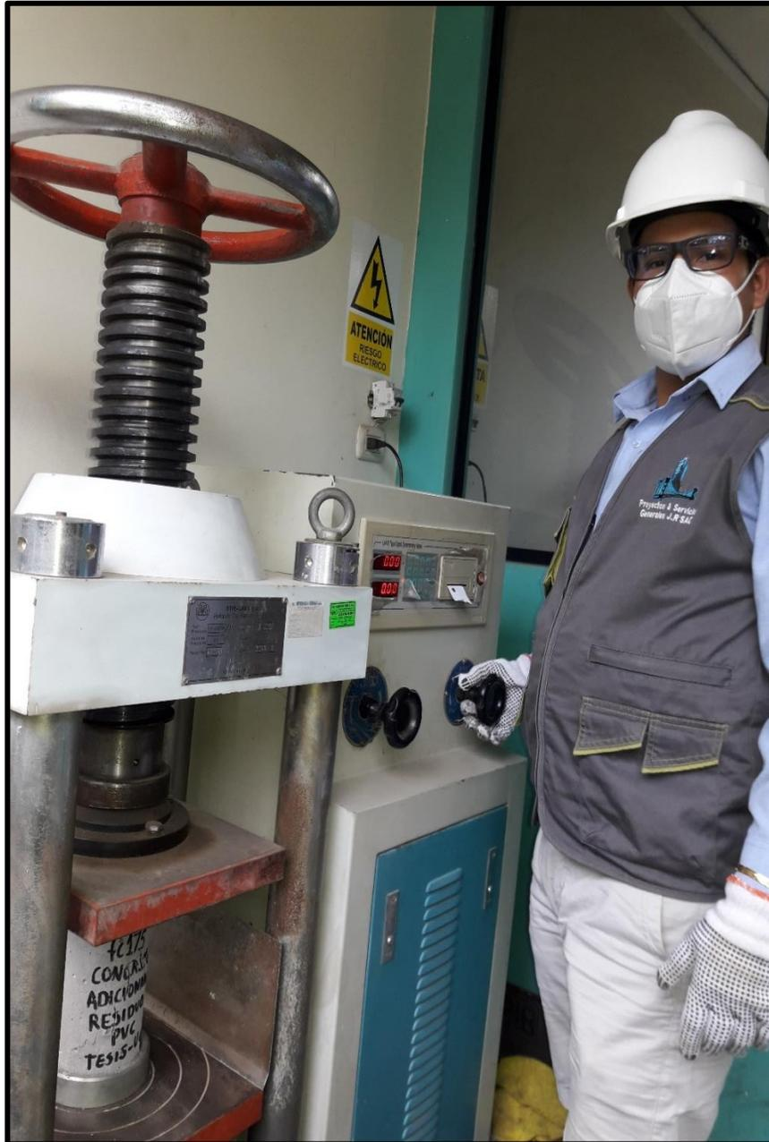
**Figura 18.** Rotura a la compresión del concreto adicionando residuos de PVC
