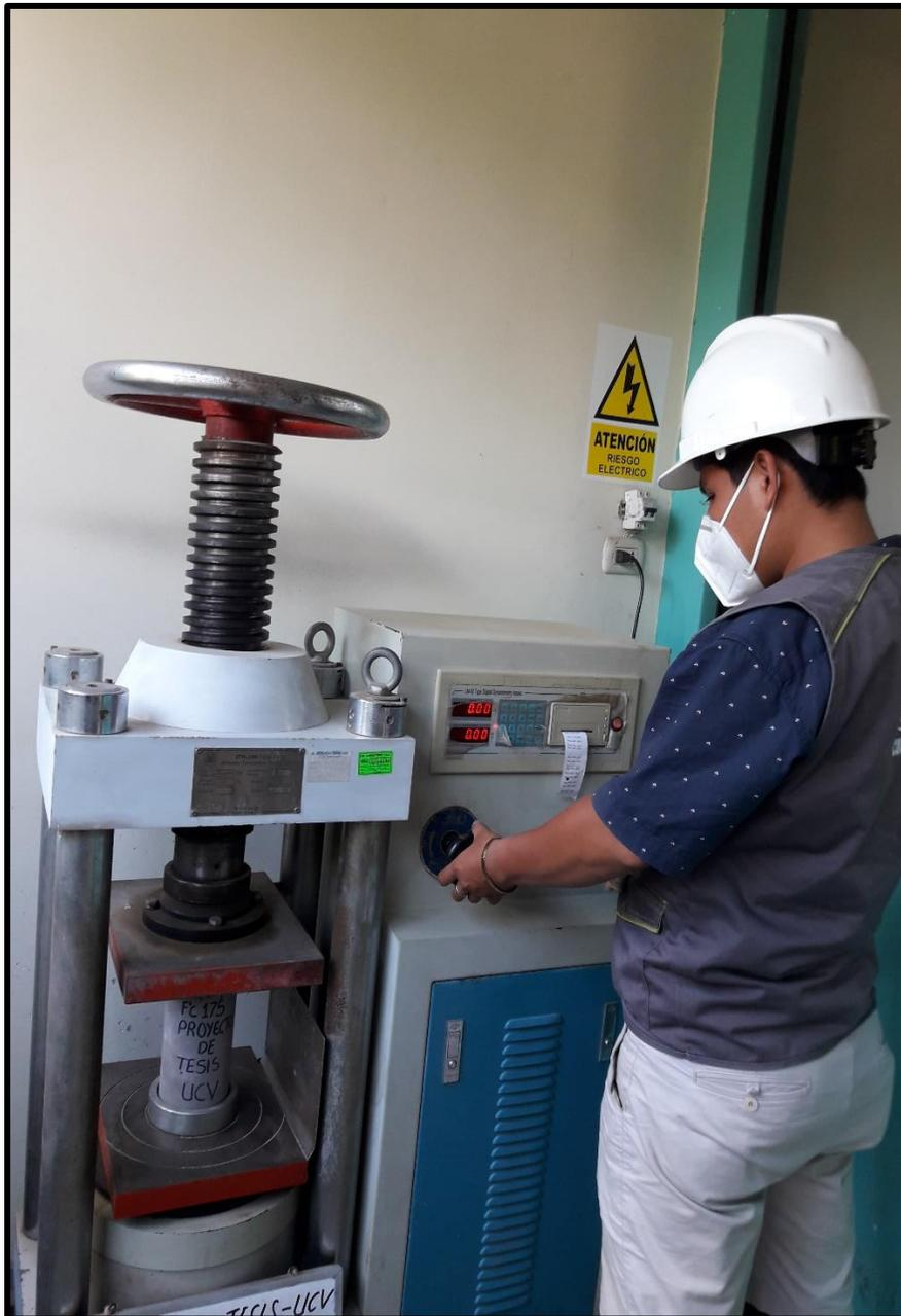
**Figura 17.** Rotura a la compresión del concreto convencional
