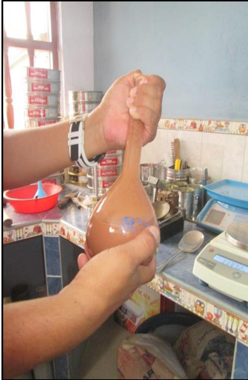
**Figura 7.** Demostración del peso específico del agregado fino
