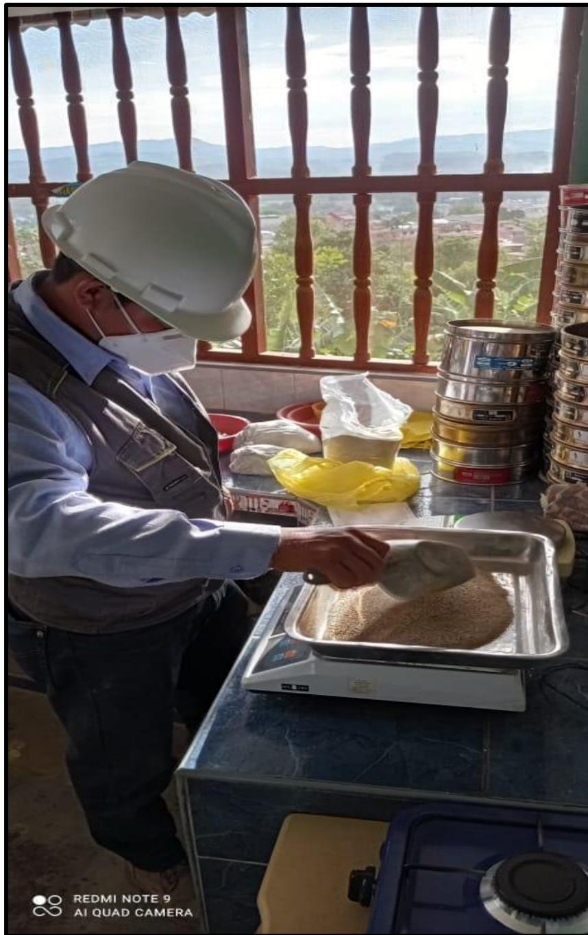
**Figura 1.** Peso de la arena para determinar la granulometría
