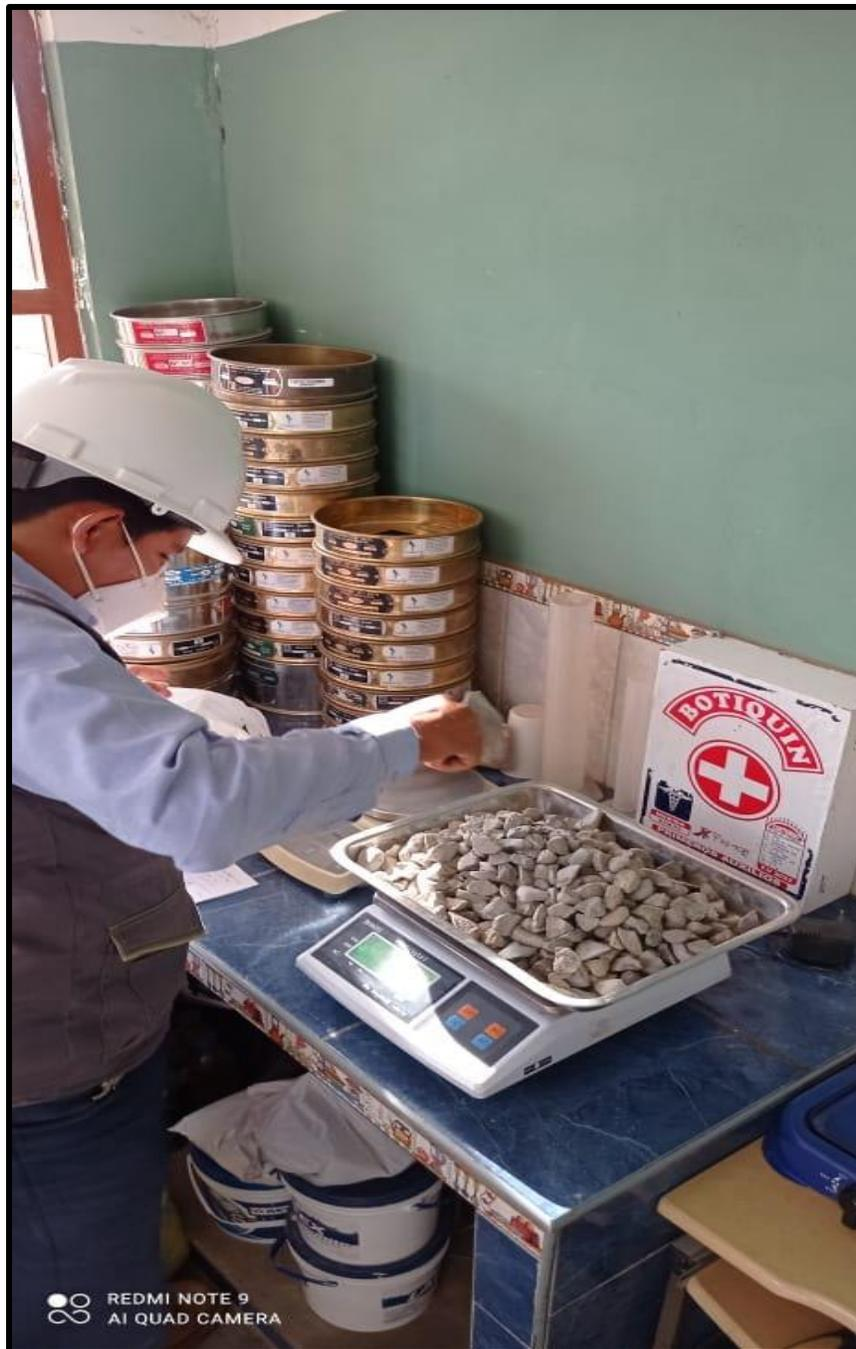
**Figura 2.** Peso de la piedra chancada para determinar la granulometría
