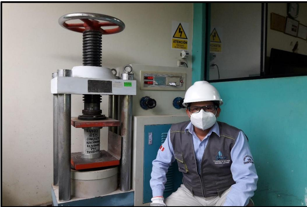
**Figura 20.** Demostración de la rotura de probetas con residuos de PVC
