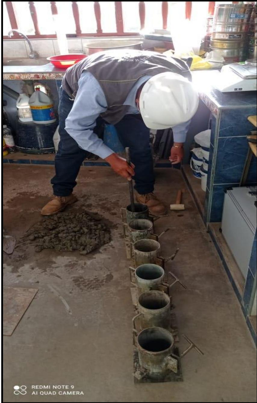
**Figura 14.** Toma de muestras de concreto convencional
