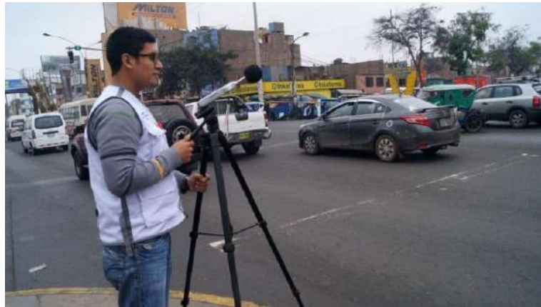
Figura 26. Medición de puntos críticos de contaminación sonora en el distrito de Comas.
