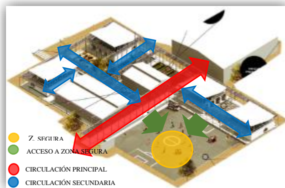
Figura 17. Caso 1. Esquema de circulación. Fuente: Redfundamentos.com; [07/2014], imágenes, diagrama de usos y materialidad - adaptación.
