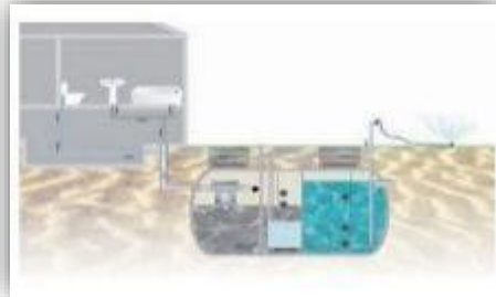
Figura 6. Estación Regeneradora de Aguas Grises, 500 Litros/Día. Fuente: Mister agua.
