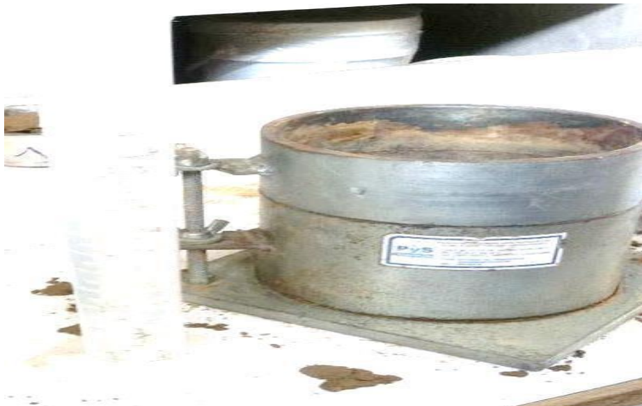
Foto N° 14: Ensayo de Proctor modificado
