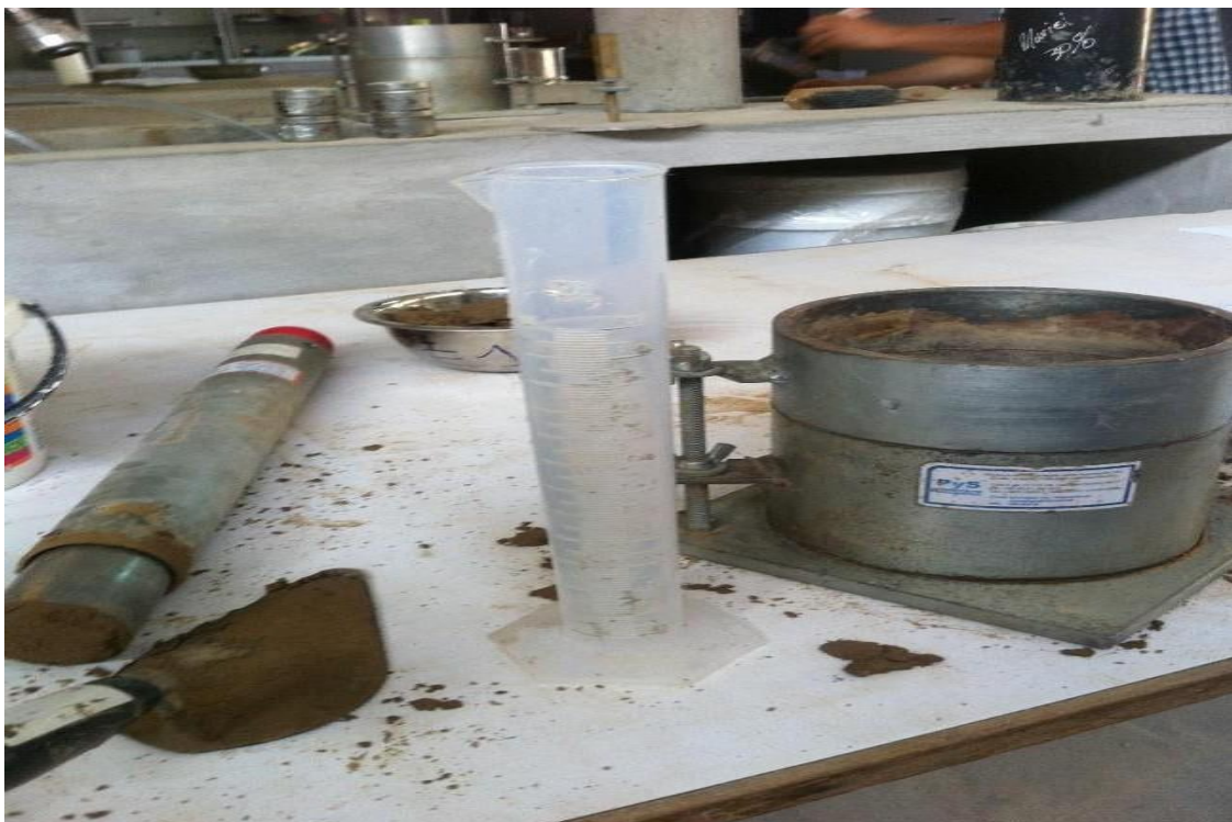
Foto N° 12: Realizando ensayo para Proctor modificado
