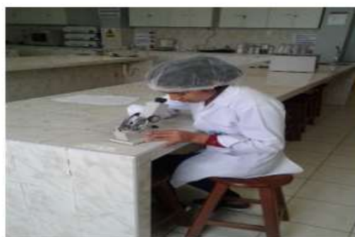
Análisis de solidos solubles en refractómetro ocular
