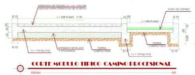
CORTE DE MODULO TIPO DE VEREDA - SARDINEL - JARDINERA PISO ASENTADO DE PIEDRA
