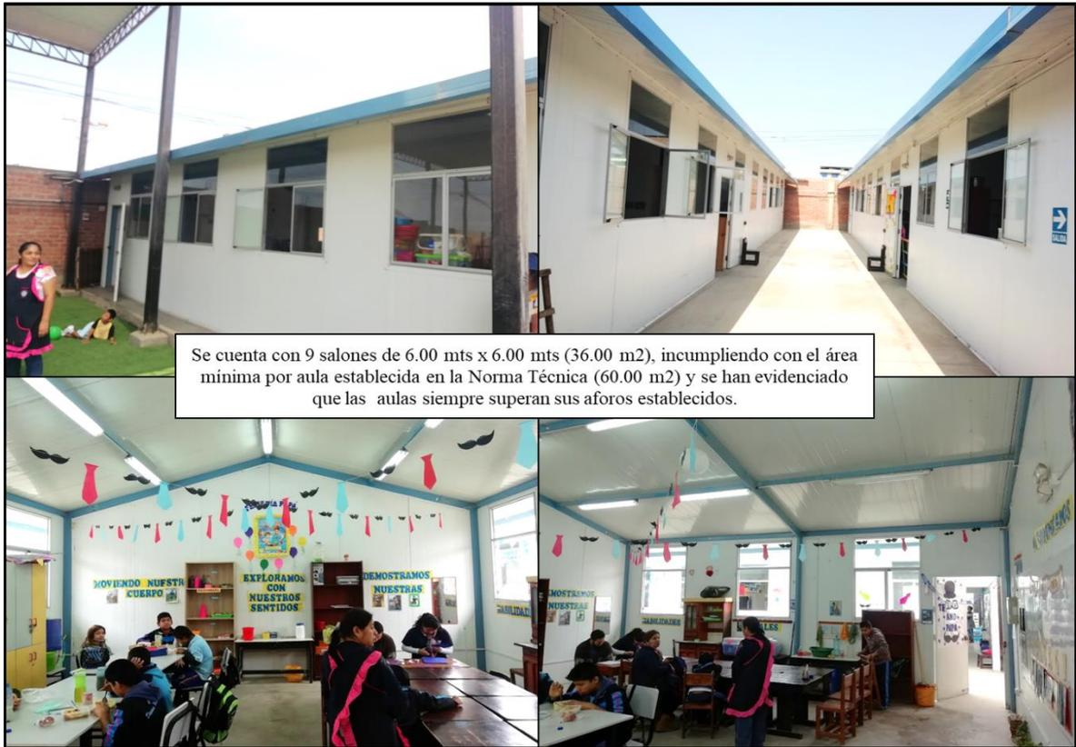
*FIGURA 33.* Las Aulas prefabricadas presentan mejor condición que cualquier otro ambiente dentro del CEBE, pero no cumplen con el área mínima según la N.T.
