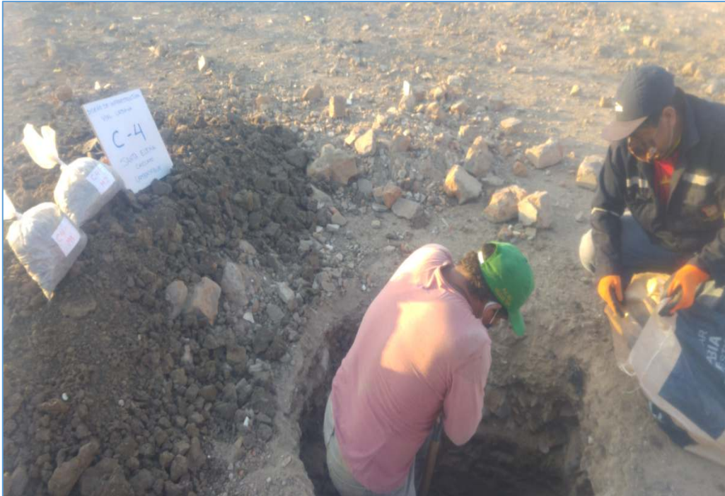
FOTO N° 07 - Vista a cielo abierto de la excavación y extracción de muestras en C - 04
