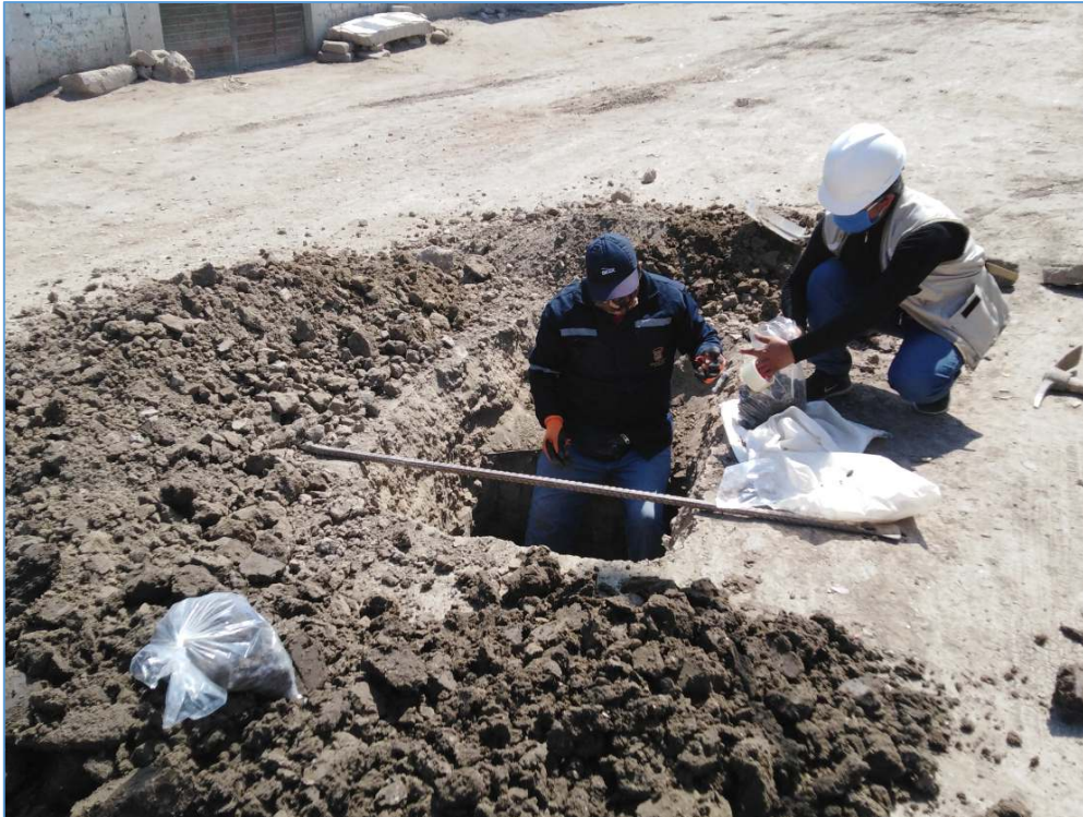
FOTO N° 05 - Vista a cielo abierto de la excavación y extracción de muestras en C - 03
