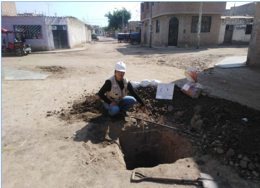
FOTO N° 14 - Vista a cielo abierto de las muestras extraídas y profundidad en C - 07
