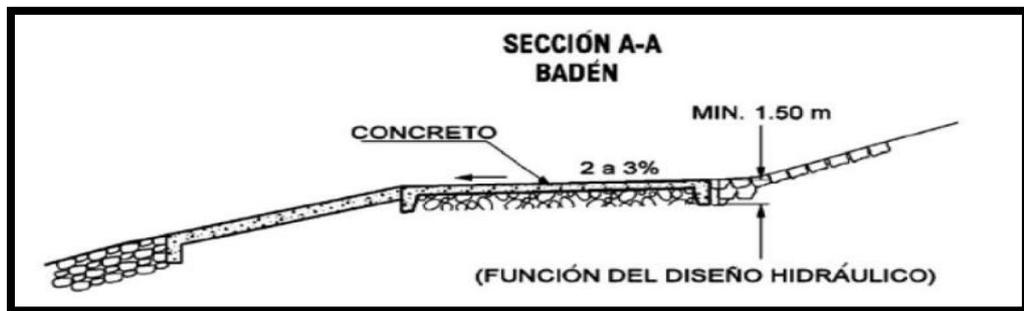
*Figura 22: Corte transversal de un badén típico*
