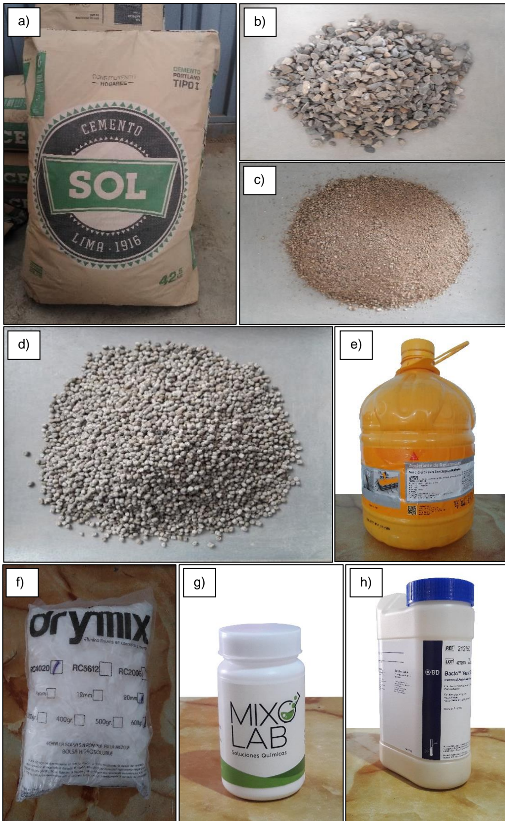
Figura 13. Materiales: a) Cemento Sol Tipo I. b) Agregado grueso. c) Agregado fino. d) Arcilla Expandida. e) SikaRapid®-1. f) SikaFiber®PE. g) Lactato de Calcio. h) Extracto de levadura.
