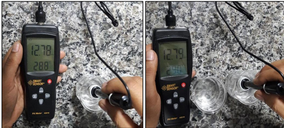
Figura 54. Lectura de pH del concreto patrón
