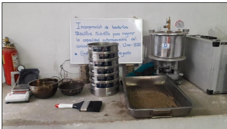
Figura 15. Granulometría de agregado fino.
