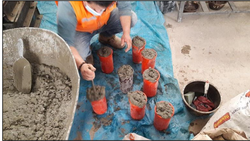
Figura 35. Varillado de especímenes cilíndricos.
