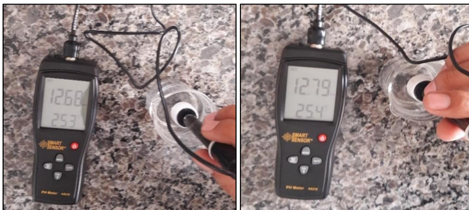
Figura 55. Lectura de pH del concreto con dosificación 1 \times 10^9 cel/ml
