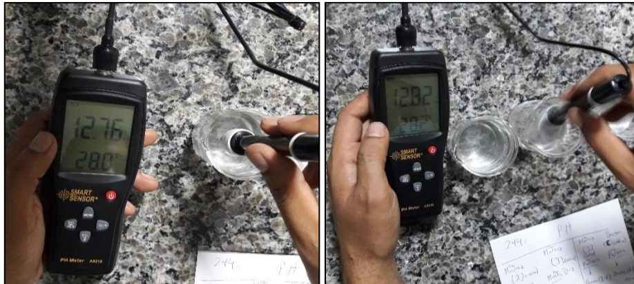
Figura 56. Lectura de pH del concreto con dosificación 1 \times 10^{12} cel/ml
