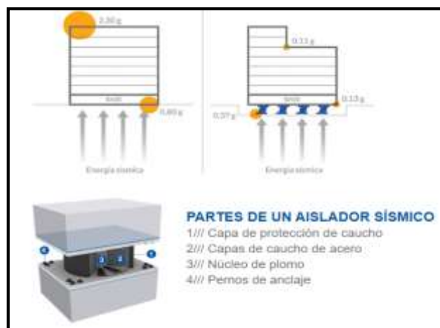
Figura 4: Aislador con núcleo de plomo - Fuente: CDV Ingeniería Antisísmica.
