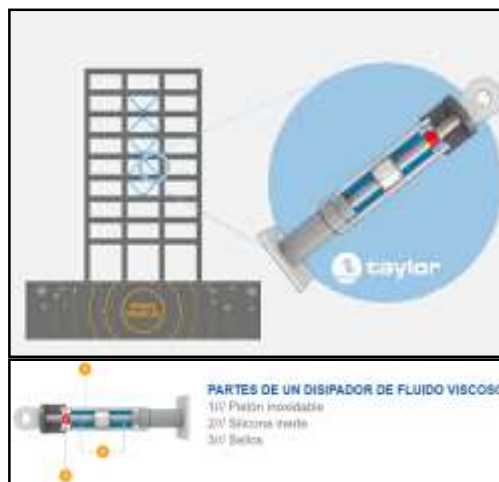
Figura 2: Disipador de fluido-viscoso – Fuente: CDV Ingeniería Antisísmica
