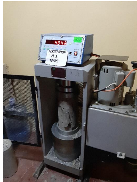
Fotografía N° 62: Rotura de probetas del concreto agua Acraybamba Simita a los 7 días
