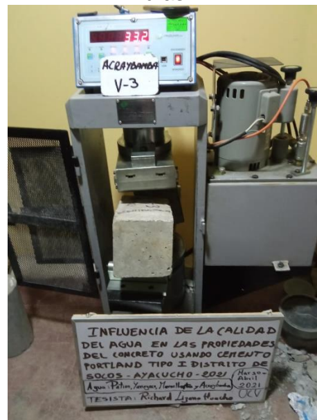
Figura 47. Rotura de prismas del concreto agua Acraybamba Simita a los 14 días
