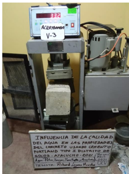
Fotografía N° 74: Rotura de prismas del concreto agua Acraybamba Simita a los 14 días
