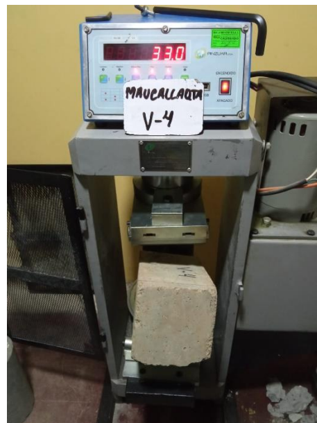
Figura 41. Rotura de prismas del concreto agua Maucallaqta a los 7 días
