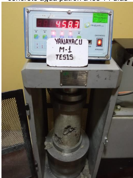
Fotografía N° 69: Rotura de probetas del concreto agua Yanayacu a los 14 días
