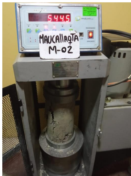
Figura 33. Rotura de probetas del concreto agua Maucallaqta a los 14 días
