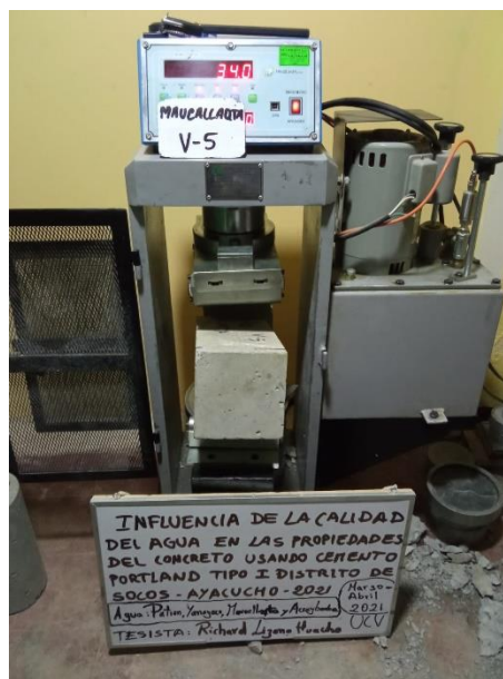
Fotografía N° 72: Rotura de prismas del concreto agua Maucallaqta a los 14 días
