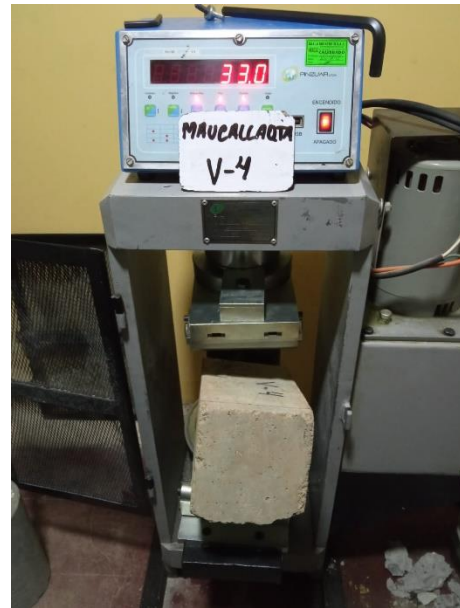
Fotografía N° 64: Rotura de prismas del concreto agua Maucallaqta a los 7 días
