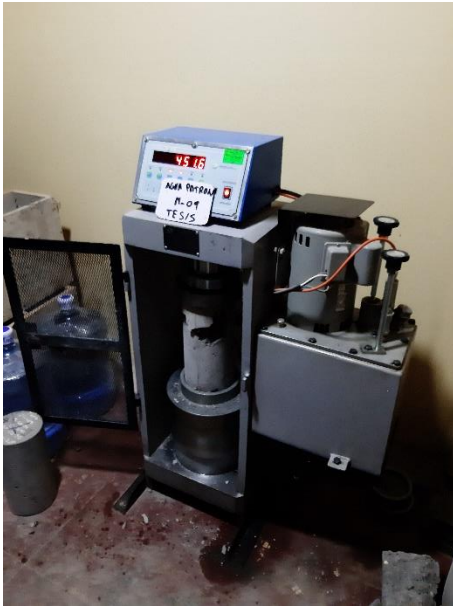
Figura 28. Rotura de probetas del concreto agua patrón a los 7 días
