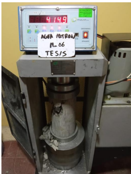
Figura 32. Rotura de probetas del concreto agua patrón a los 14 días
