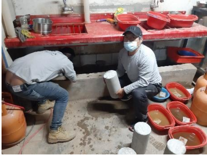
Fotografía N° 53: Colocacion de las probetas y briquetas para el curado final para los periodos de 7, 14 y 28 dias
