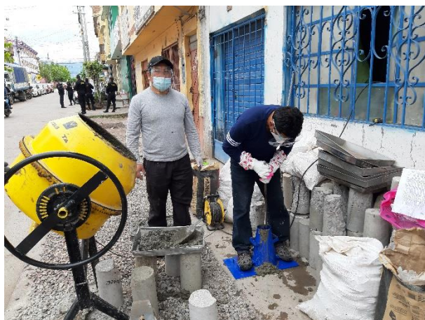
Figura 26. Ensayo de Asentamiento para el concreto preparado con agua del afluente PTAR Acraybamba Simita
