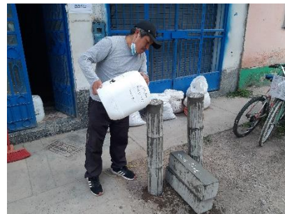
Fotografía N° 52: Curado de las probetas y briquetas de concreto
