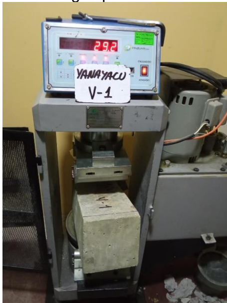
Figura 42. Rotura de prismas del concreto agua Yanayacu a los 7 días
