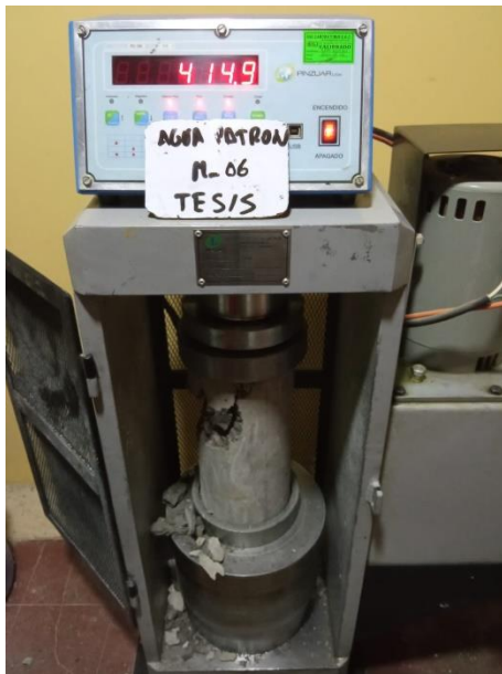
Fotografía N° 67: Rotura de probetas del concreto agua patrón a los 14 días
