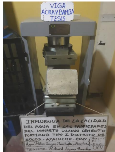
Figura 51. Rotura de prismas del concreto agua Acraybamba Simita a los 28 días
