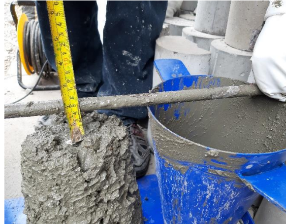
Fotografía N° 48: Medición de la altura del slump para el concreto preparado con agua de la Laguna de Yanayacu con resultado de 2.5"
