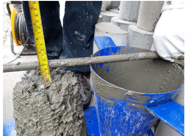
Figura 25. Medición de la altura del slump para el concreto preparado con agua de la Laguna de Yanayacu con resultado de 2.5"
