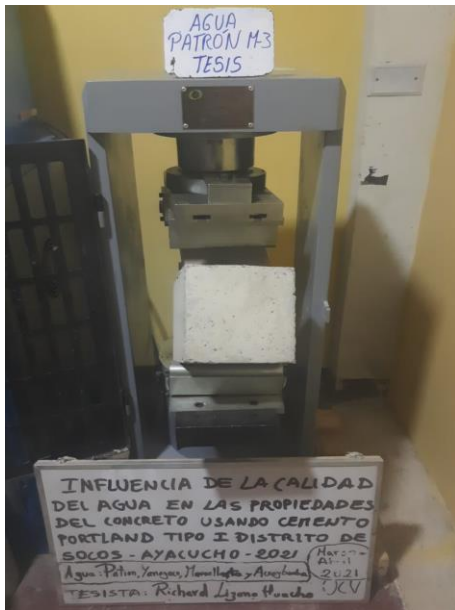
Figura 48. Rotura de prismas de concreto agua patrón a los 28 días
