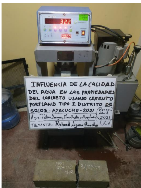
Fotografía N° 73: Rotura de prismas del concreto agua Yanayacu a los 14 días
