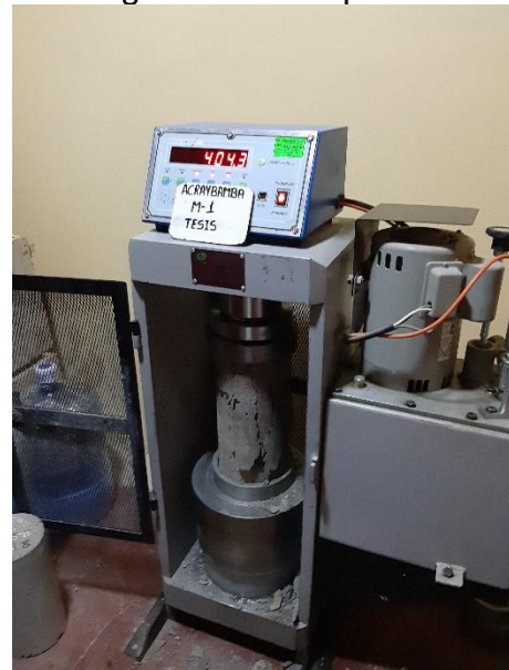
Figura 31. Rotura de probetas del concreto agua Acraybamba Simita a los 7 días
