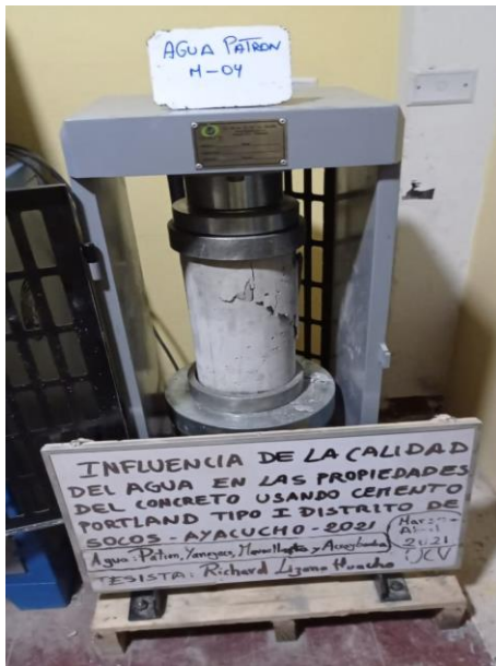
Fotografía N° 75: Rotura de probetas del concreto agua patrón a los 28 días
