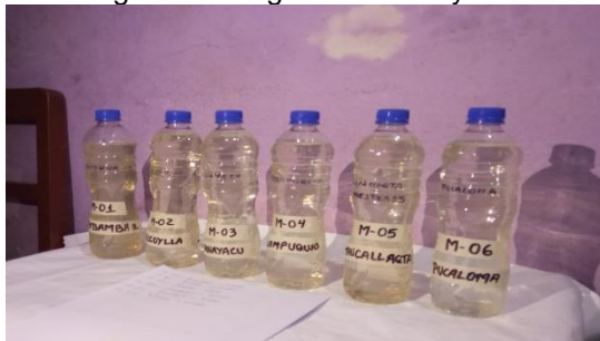
Fotografía N° 15: Vista de las 06 muestras de fuente de agua del distrito de socos, listos para el análisis químico de laboratorio, selección y preparado del concreto f'c = 210 \text{ kg/cm}^2
