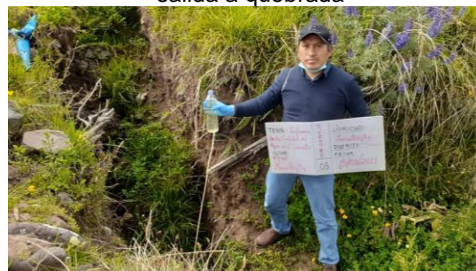
Fotografía N° 06: Recolección de muestra de agua residual del efluente de la PTAR Maucallaqta -salida a quebrada
