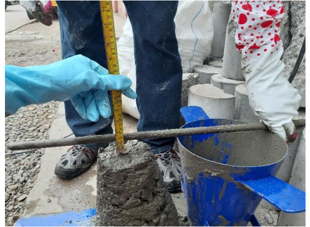
Figura 23. Medición de la altura del slump para el concreto preparado con agua del afluente PTAR Maucallaqta con resultado de 1.5"
