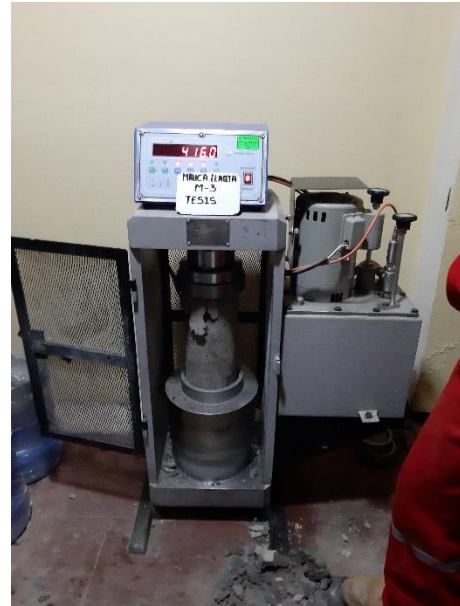
Figura 29. Rotura de probetas del concreto agua Maucallaqta a los 7 días
