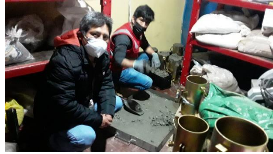
Fotografía N° 34: Vista de la preparación de las muestras de concreto en las probetas y vigueta
