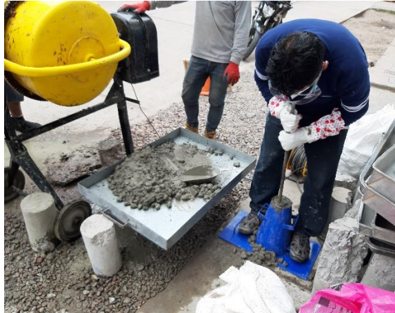
Fotografía N° 47: Ensayo de Asentamiento para el concreto preparado con agua de la Laguna de Yanayacu
