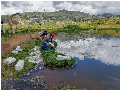
Fotografía N° 57: Curado final para los periodos de 7, 14 y 28 dias para el concreto preparado con agua de la laguna de Yanayacu
