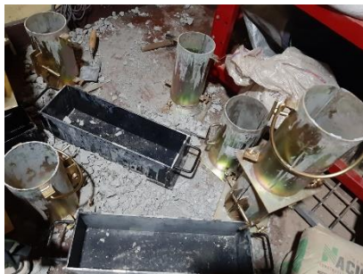
Fotografía N° 51: Desencofrado o desmoldado de las probetas cilíndricas y briquetas de concreto
