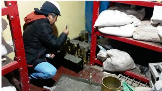
Fotografía N° 35: Vista de la preparación de las muestras de probetas y vigueta de concreto
