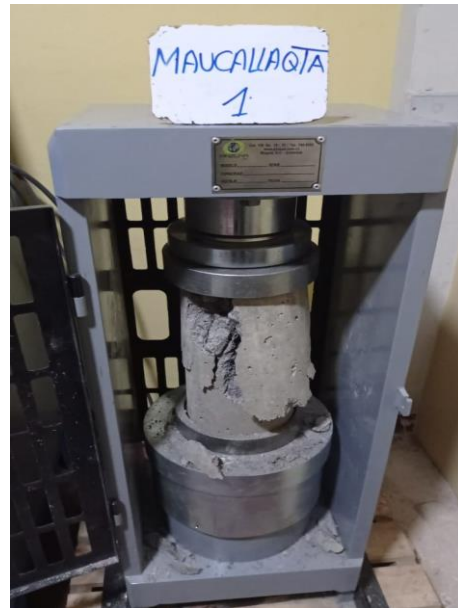
Figura 37. Rotura de probetas del concreto agua Maucallaqta a los 28 días
