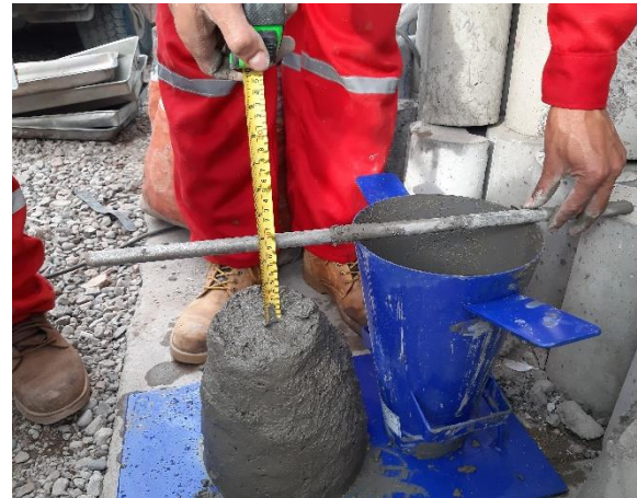
Fotografía N° 44: Medición de la altura del slump para el concreto preparado con agua patrón con resultado de 4"
