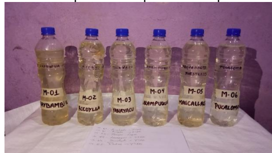
Fotografía N° 16: Otra vista de las 06 muestras de fuente de agua del distrito de socos, listos para el análisis químico de laboratorio, selección y preparado del concreto f'c = 210 \text{ kg/cm}^2
