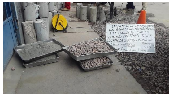
Fotografía N° 30: Cemento andino y piedra chancada ¾ listo para el preparado de la mezcla luego del pesaje
