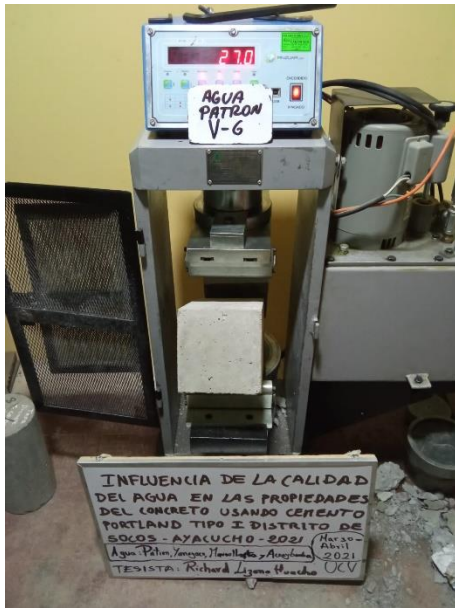
Fotografía N° 63: Rotura de prismas de concreto agua patrón a los 7 días
