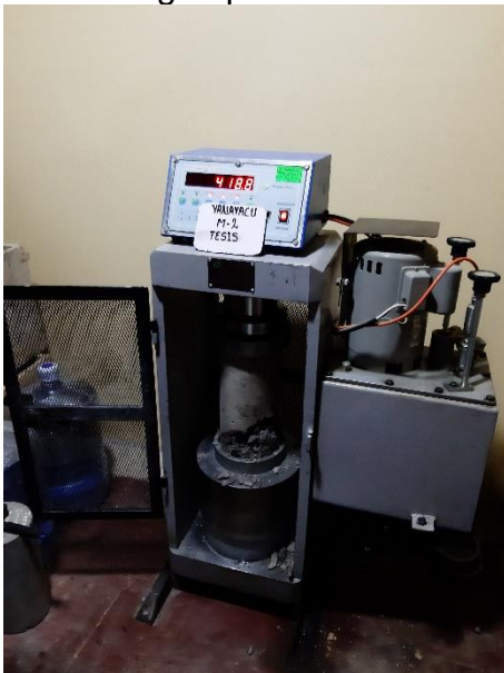
Figura 30. Rotura de probetas del concreto agua Yanayacu a los 7 días
