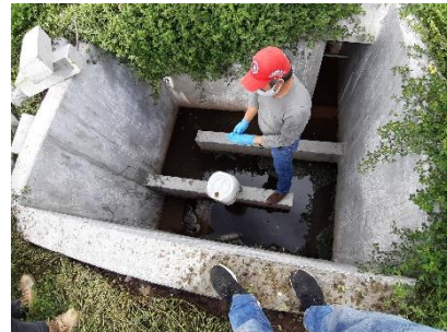
Fotografía N° 58: Curado final para los periodos de 7, 14 y 28 dias para el concreto preparado con agua del afluente PTAR Maucallaqta
