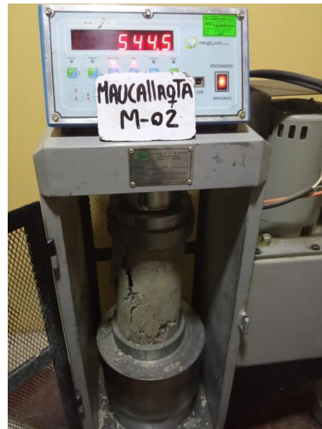
Fotografía N° 68: Rotura de probetas del concreto agua Maucallaqta a los 14 días
