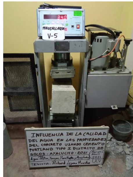
Figura 45. Rotura de prismas del concreto agua Maucaallaqta a los 14 días
