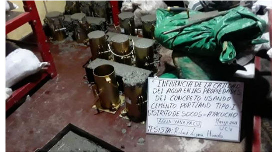
Fotografía N° 42: Vista de las probetas y vigueta lleno de concreto preparado con agua de la laguna de Yanayacu
