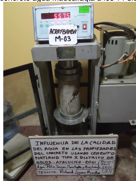
Fotografía N° 70: Rotura de probetas del concreto agua Acraybamba Simita a los 14 días
