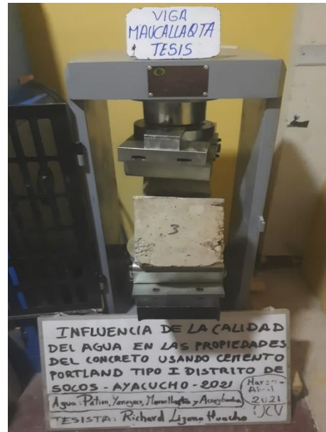
Fotografía N° 80: Rotura de prismas del concreto agua Maucallaqta a los 28 días
