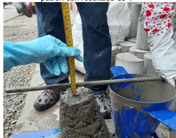
Fotografía N° 46: Medición de la altura del slump para el concreto preparado con agua del afluyente PTAR Maucallaqta con resultado de 1.5"
