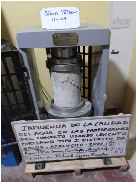
Figura 36. Rotura de probetas del concreto agua patrón a los 28 días
