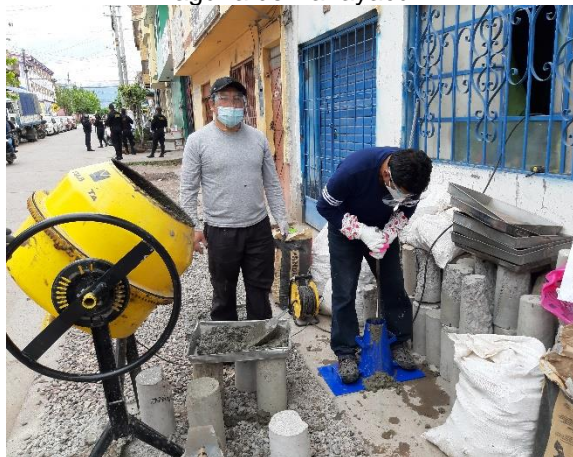
Fotografía N° 49: Ensayo de Asentamiento para el concreto preparado con agua del afluente PTAR Acraybamba Simita
