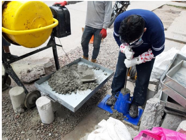
Figura 24. Ensayo de Asentamiento para el concreto preparado con agua de la Laguna de Yanayacu
