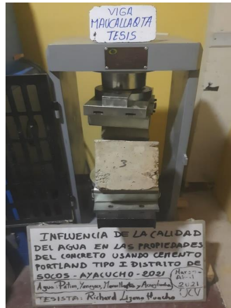
Figura 49. Rotura de prismas del concreto agua Maucallaqta a los 28 días
