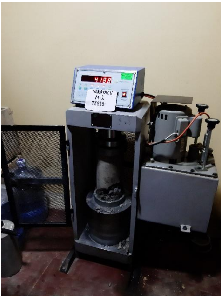
Fotografía N° 61: Rotura de probetas del concreto agua Yanayacu a los 7 días
