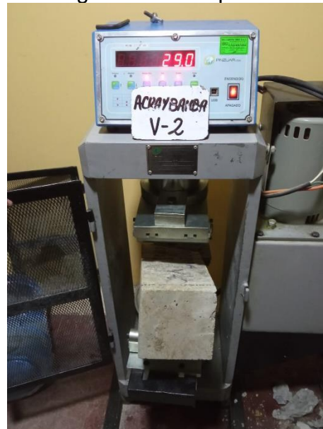
Figura 43. Rotura de prismas del concreto agua Acraybamba Simita a los 7 días
