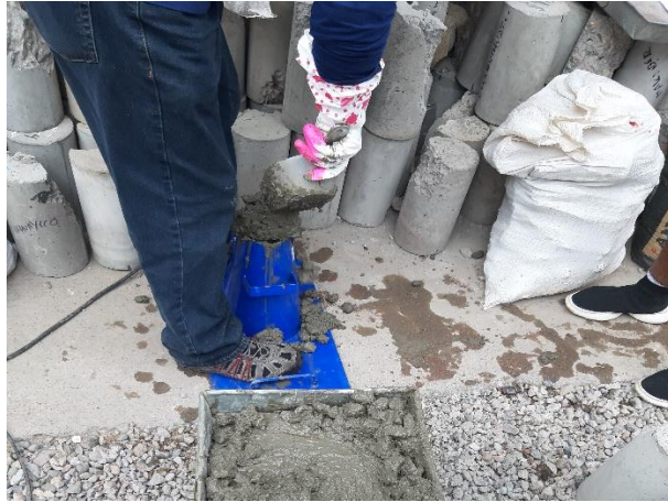
Figura 22. Ensayo de Asentamiento para el concreto preparado con agua del afluente PTAR Maucallaqta
