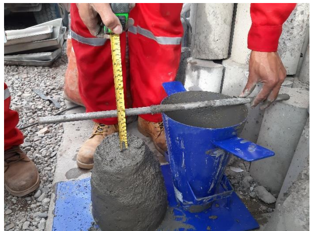
Figura 21. Medición de la altura del slump para el concreto preparado con agua patrón con resultado de 4"
