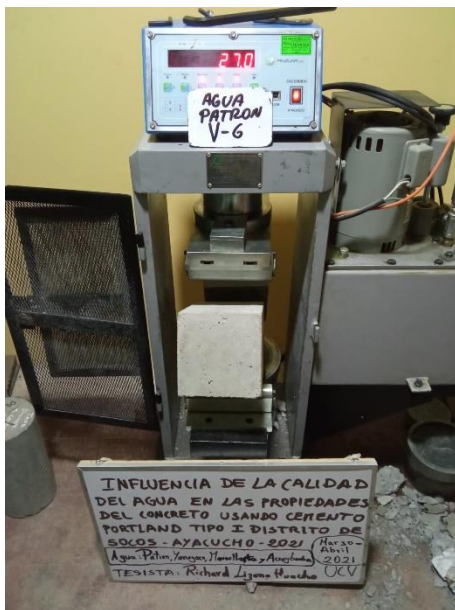
Figura 40. Rotura de prismas de concreto agua patrón a los 7 días
