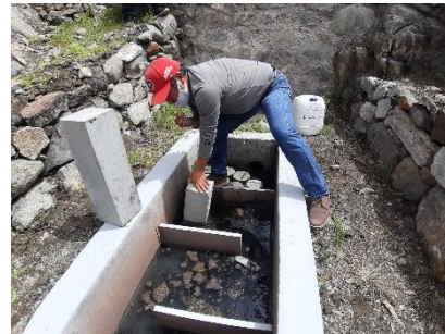
Fotografía N° 56: Curado final para los periodos de 7, 14 y 28 dias para el concreto preparado con agua del afluente PTAR acraybamba simita
