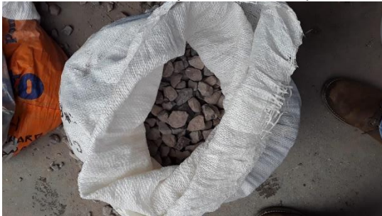
Fotografía N° 27: Compra de piedra chancada de ¾ de la ferretería más cercana, se observa la dimensión uniforme de la misma
