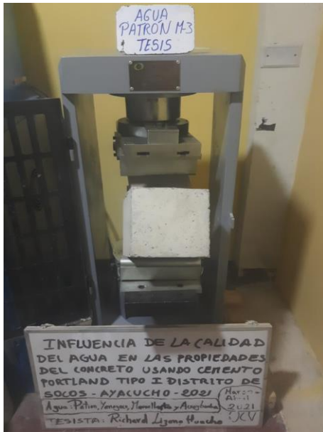
Fotografía N° 79: Rotura de prismas de concreto agua patrón a los 28 días
