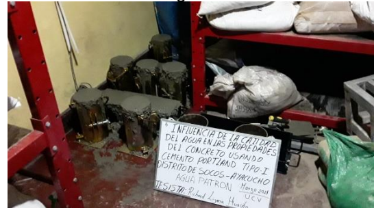
Fotografía N° 36: Vista de las probetas y vigueta lleno de concreto preparado con agua patrón
