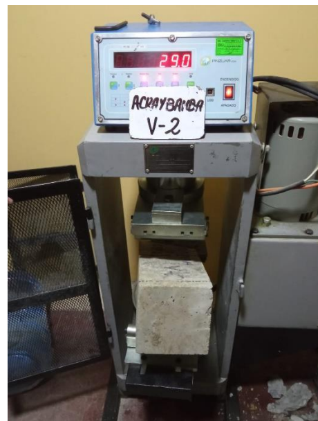
Fotografía N° 66: Rotura de prismas del concreto agua Acraybamba Simita a los 7 días
