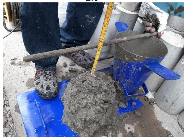
Figura 27. Medición de la altura del slump para el concreto preparado con agua del afluente PTAR Acraybamba Simita con resultado de 5.5"
