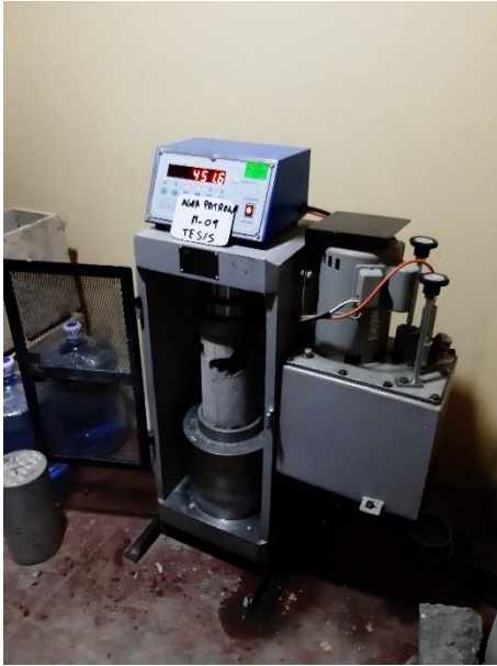
Fotografía N° 59: Rotura de probetas del concreto agua patrón a los 7 días
