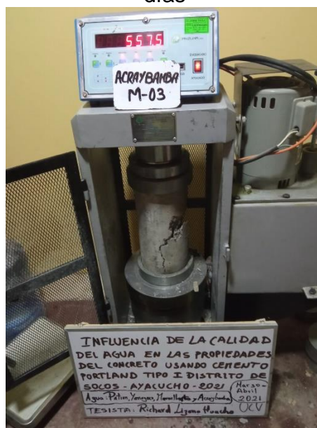
Figura 35. Rotura de probetas del concreto agua Acraybamba Simita a los 14 días
