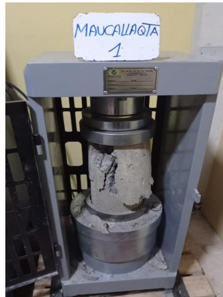
Fotografía N° 76: Rotura de probetas del concreto agua Maucallaqta a los 28 días
