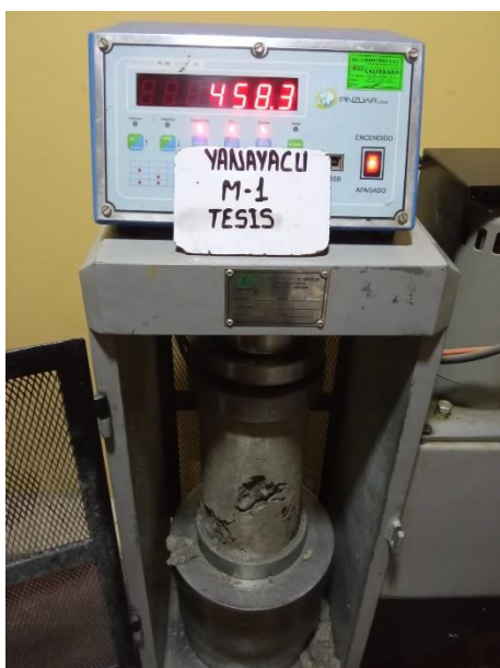
Figura 34. Rotura de probetas del concreto agua Yanayacu a los 14 días
