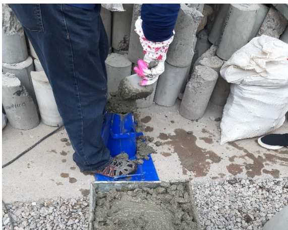
Fotografía N° 45: Ensayo de Asentamiento para el concreto preparado con agua del afluyente PTAR Maucallaqta
