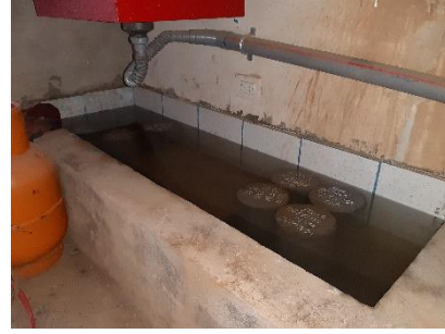
Fotografía N° 54: Curado final para los periodos de 7, 14 y 28 dias para el concreto preparado con agua patron
