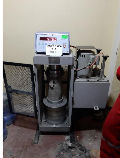
Fotografía N° 60: Rotura de probetas del concreto agua Maucallaqta a los 7 días
