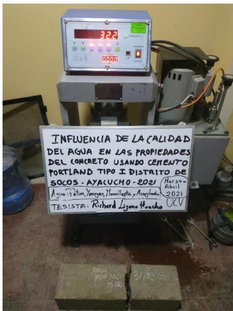
Figura 46. Rotura de prismas del concreto agua Yanayacu a los 14 días
