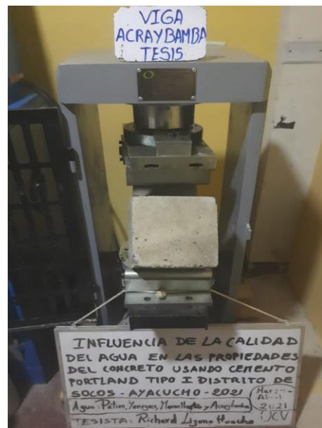
Fotografía N° 82: Rotura de prismas del concreto agua Acraybamba Simita a los 28 días
