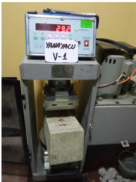
Fotografía N° 65: Rotura de prismas del concreto agua Yanayacu a los 7 días
