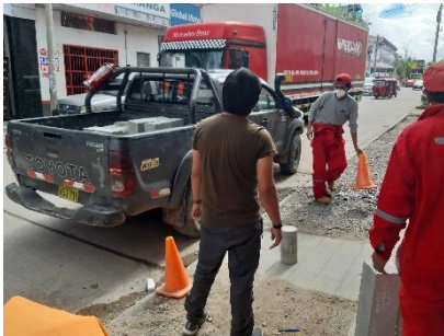
Fotografía N° 55: Traslado de las probetas y briquetas para el curado en las 03 fuentes de agua de las 03 localidades para 7, 14 y 28 dias
