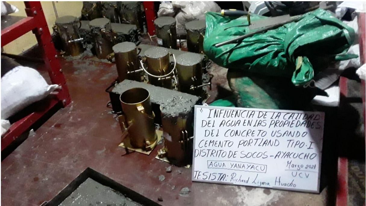
Figura 19. Vista de las probetas y viguetas de concreto preparados con las diferentes fuentes.
