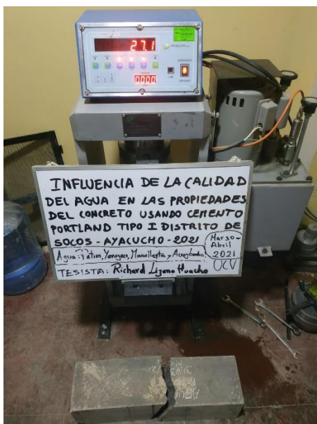
Fotografía N° 71: Rotura de prismas de concreto agua patrón a los 14 días
