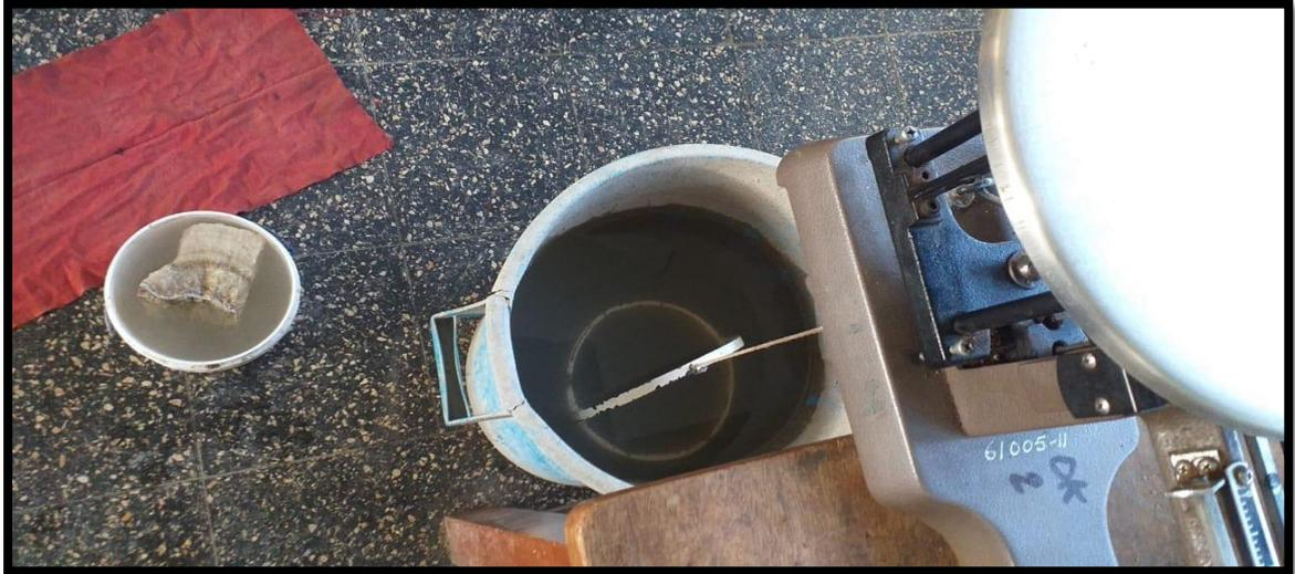
Material Sumergido en el Agua para Obtener el Grado de Absorción.
