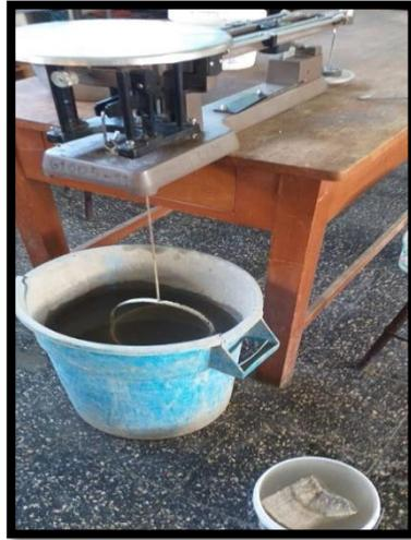
Obtención del Peso de Muestra Sumergida.
