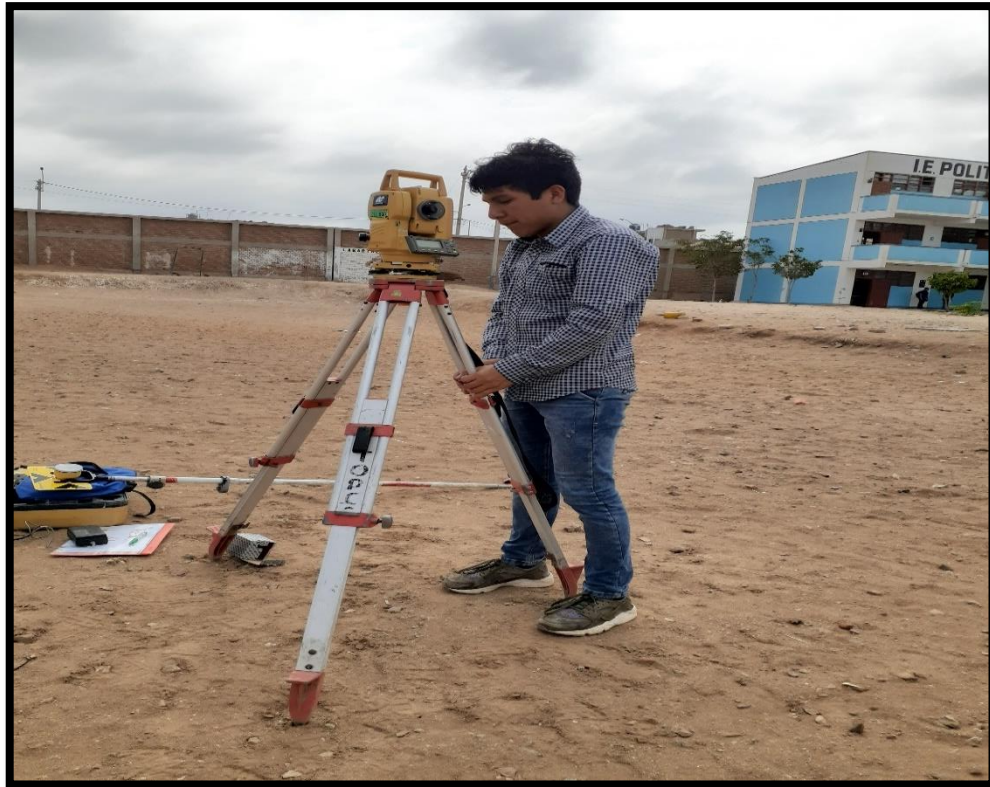
Figura 9. Nivelando la estación total en BM01, en la I.E Pedro Abel Labarthe Durand, Sede Pimentel.
