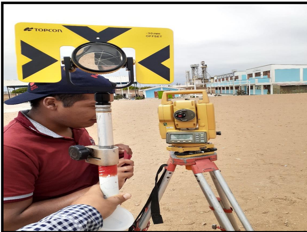
Figura 10. Estación total y prisma marca Topcon, utilizados para el levantamiento Topográfico.
