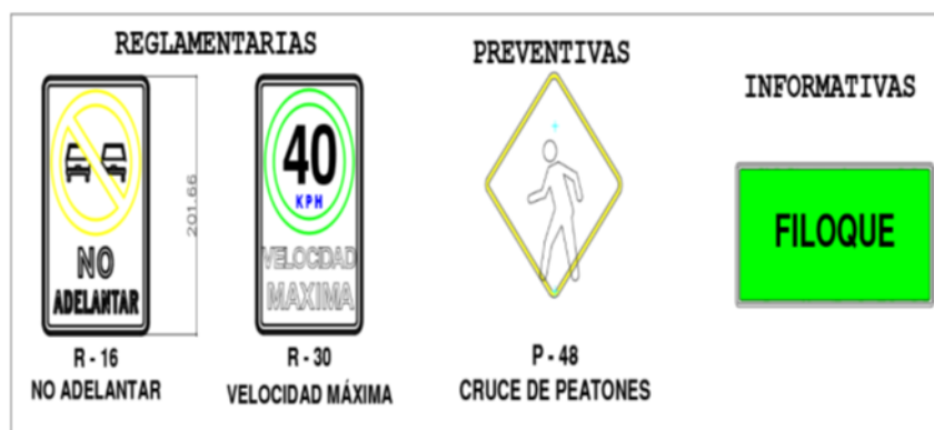
Figura 4: Señalización para la vía
