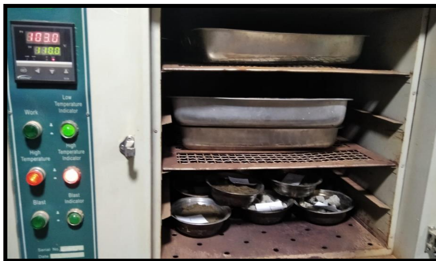
Imagen 15: PESO DEL AGREGADO FINO Y GRUESO EN HORNO A UNA TEMPERATURA 110 °C.
