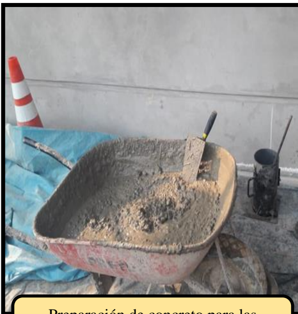
Preparación de concreto para las probetas
