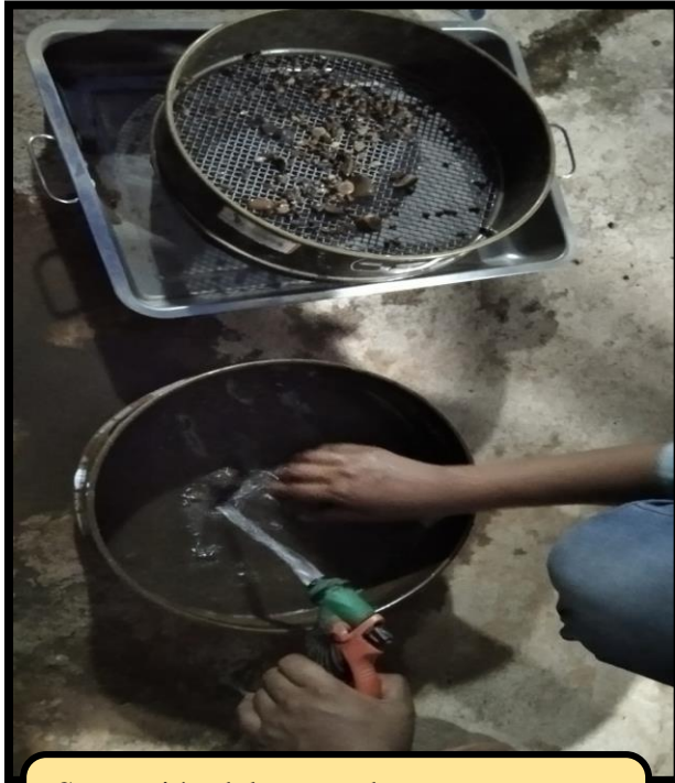
Saturación del agregado grueso en agua
