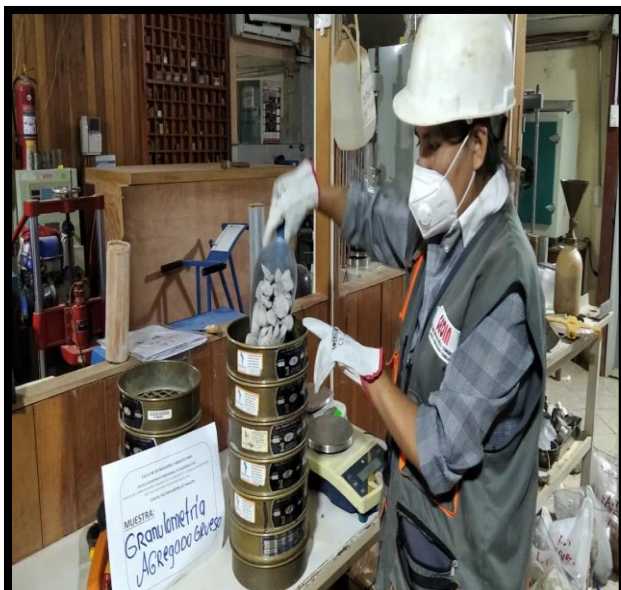
Se realiza el ensayo de tamizado
