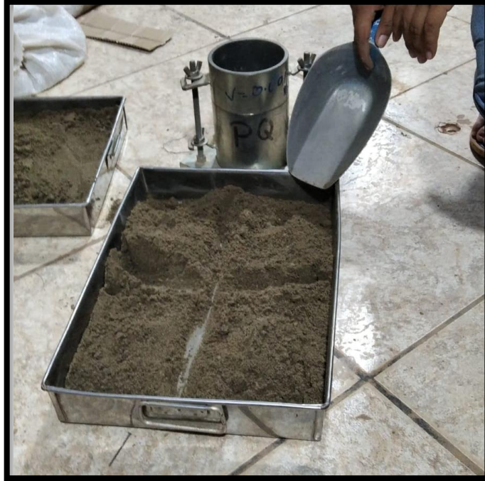
Imagen 19 "EL RECIPIENTE MOLDE PROCTOR ES LLENADO CON MATERIAL FINO.
