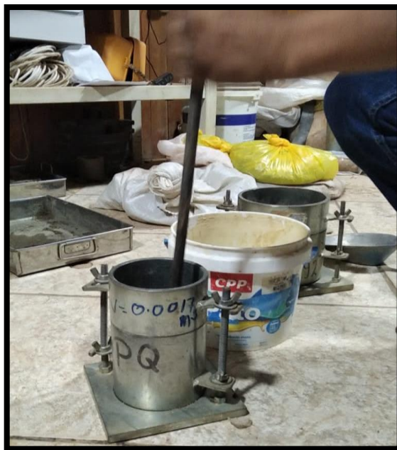
Imagen 20: EL RECIPIENTE MOLDE PROCTOR MAS EL AGREGADO GRUESO.
