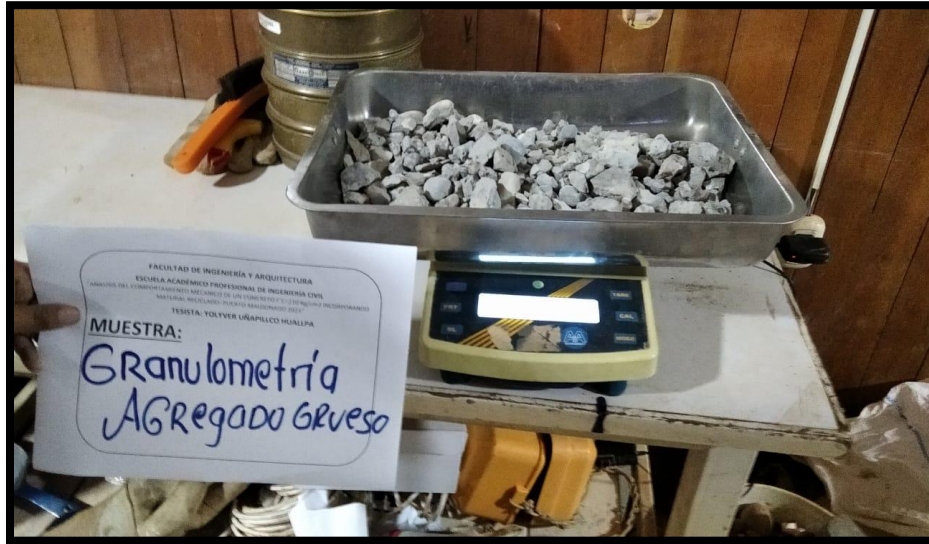
Imagen 8: ANÁLISIS GRANULOMETRÍA AGREGADO GRUESO RECICLADO DE DEMOLICIONES PESADO DE LA MUESTRA DESPUÉS DEL TAMIZADO.
