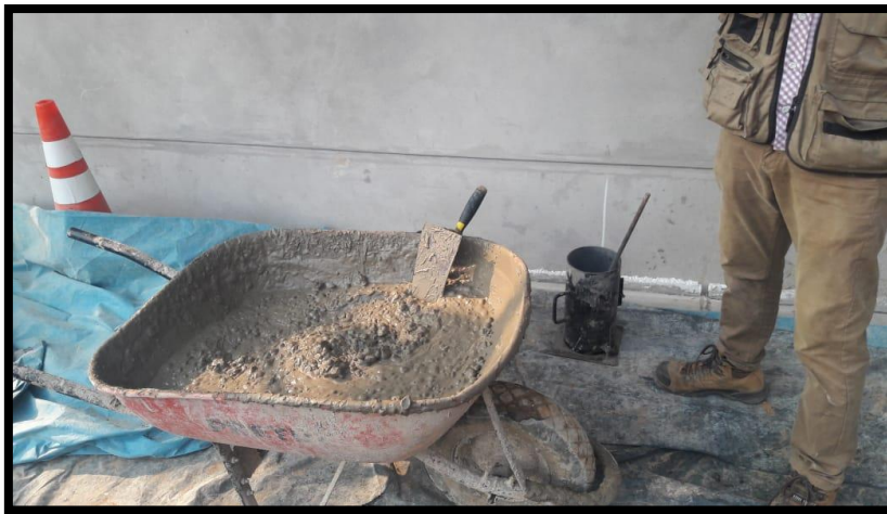
Imagen 23: PREPARACIÓN DE LA MEZCLA PARA LAS PROBETAS.
