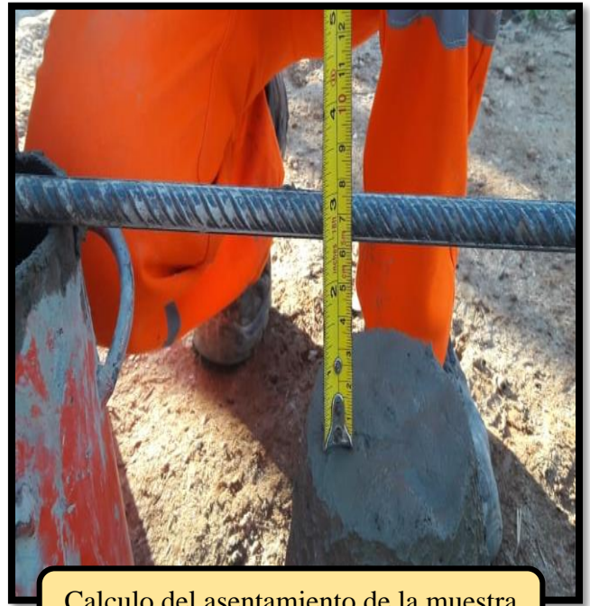
Calculo del asentamiento de la muestra de concreto
