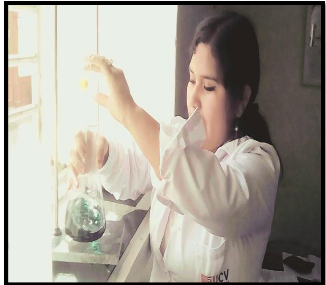
Figura 16: Titulando la mezcla de estiércol y lodo
