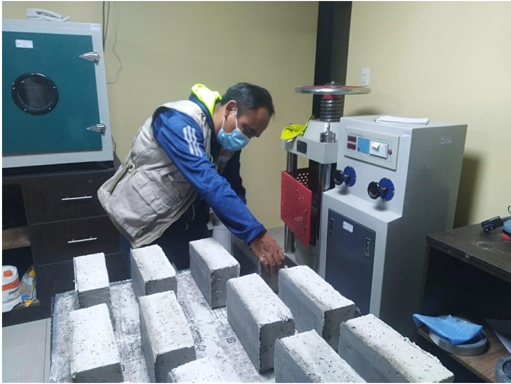
Figura 24. Medición de ladrillos de concreto para alabeo
