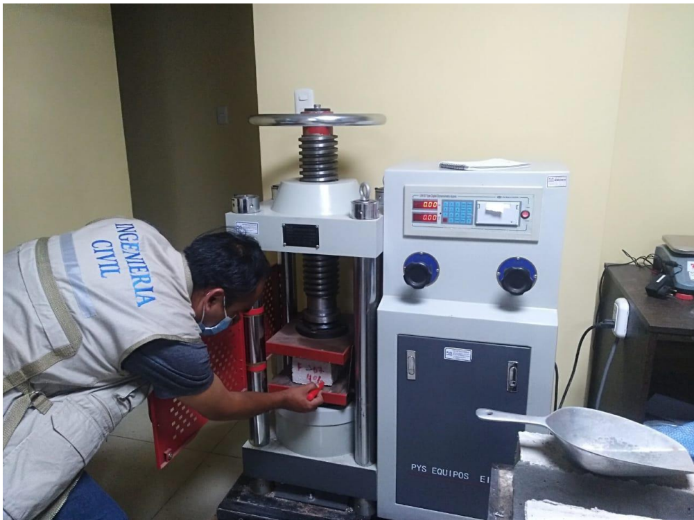
Figura 25. Ensayo de compresión de ladrillo de muestra patrón
