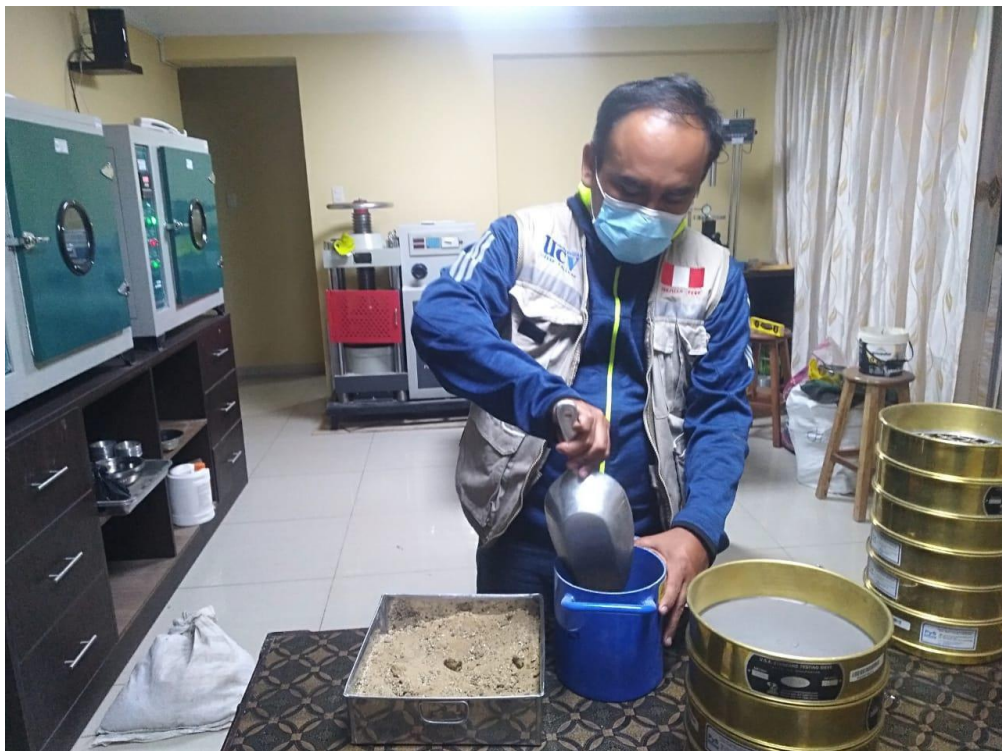
Figura 21. Tamizaje de los agregados
