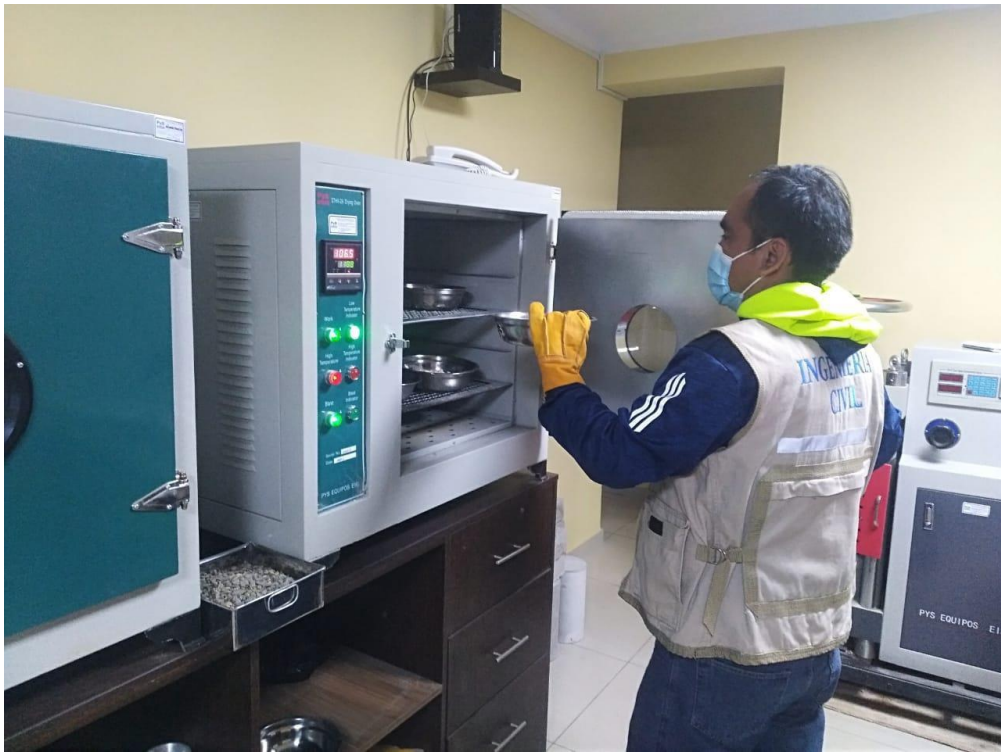
Figura 22. Secado en el horno de los materiales
