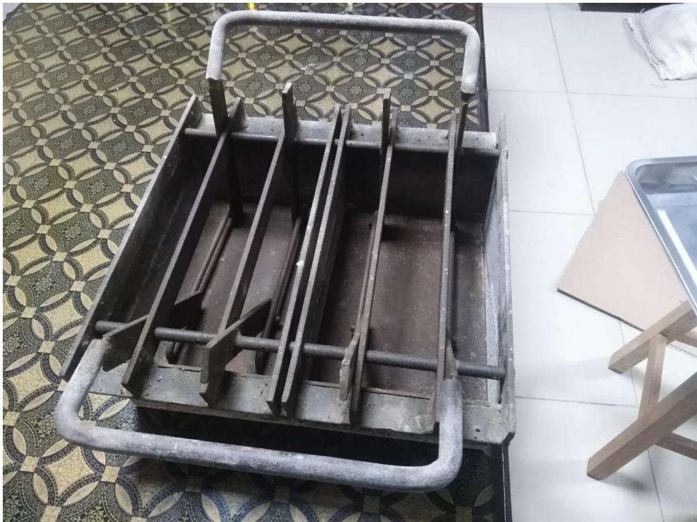
Figura 18. Molde para elaboración de ladrillo de concreto
