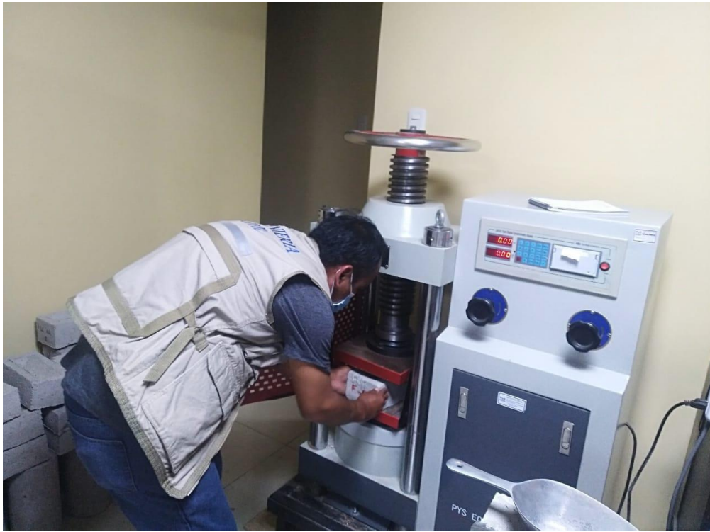
Figura 26. Ensayo de compresión de ladrillo con fibra óptica
