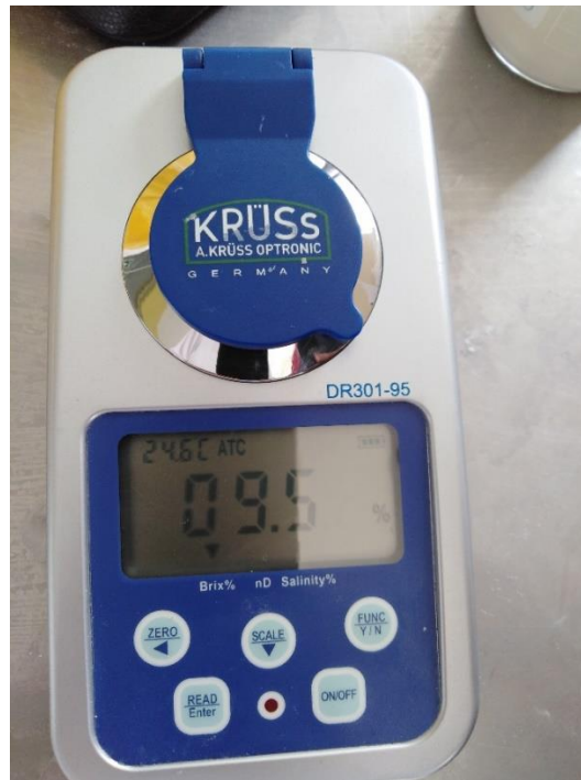
Figura 10. Medición de grados Brix en la muestra de leche fresca.
