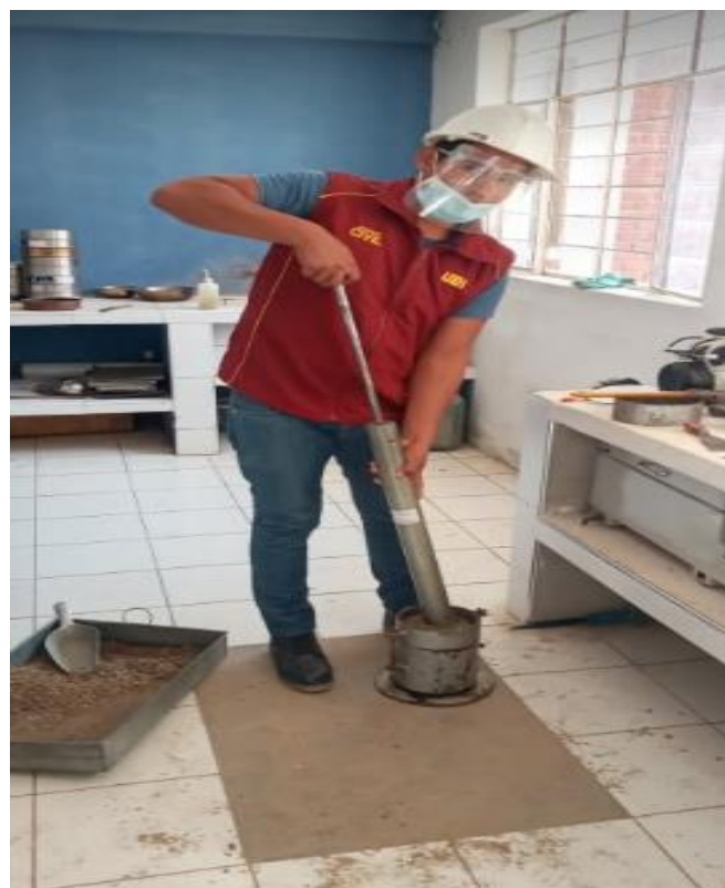
Figura: Ensayo de CBR
