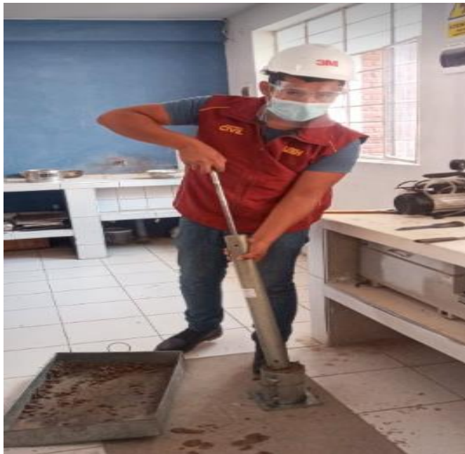
Figura: Ensayo de proctor modificado
