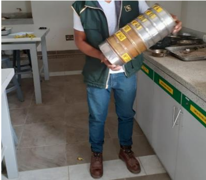
Figura: Ensayo de análisis granulométrico por tamizado
