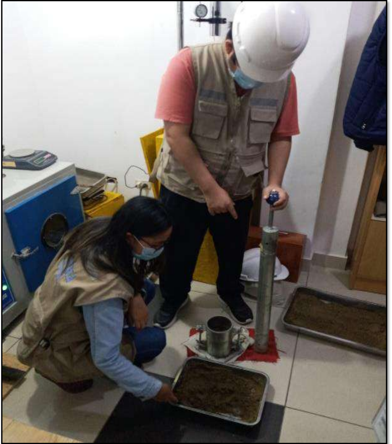
Figura 21: Compactación del material
