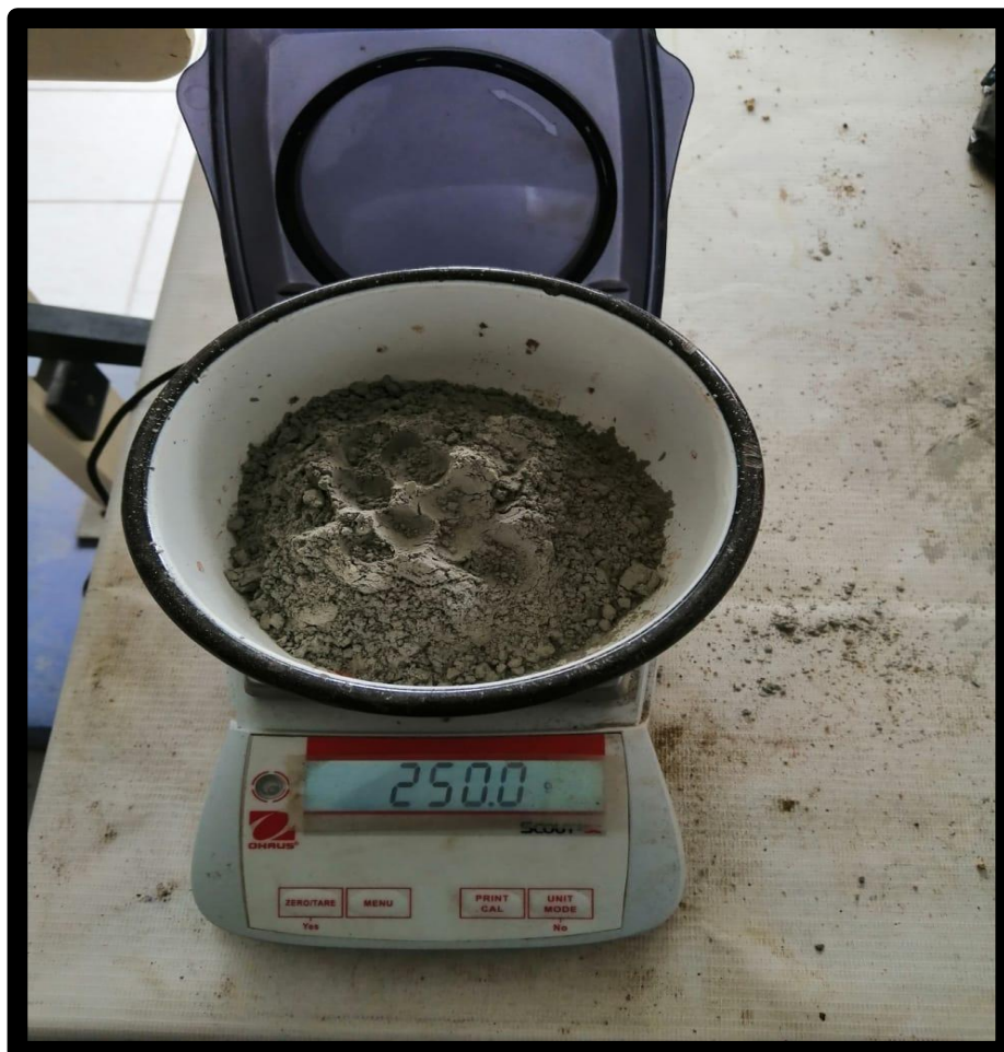
Foto 08: Peso de cemento para mortero patrón
