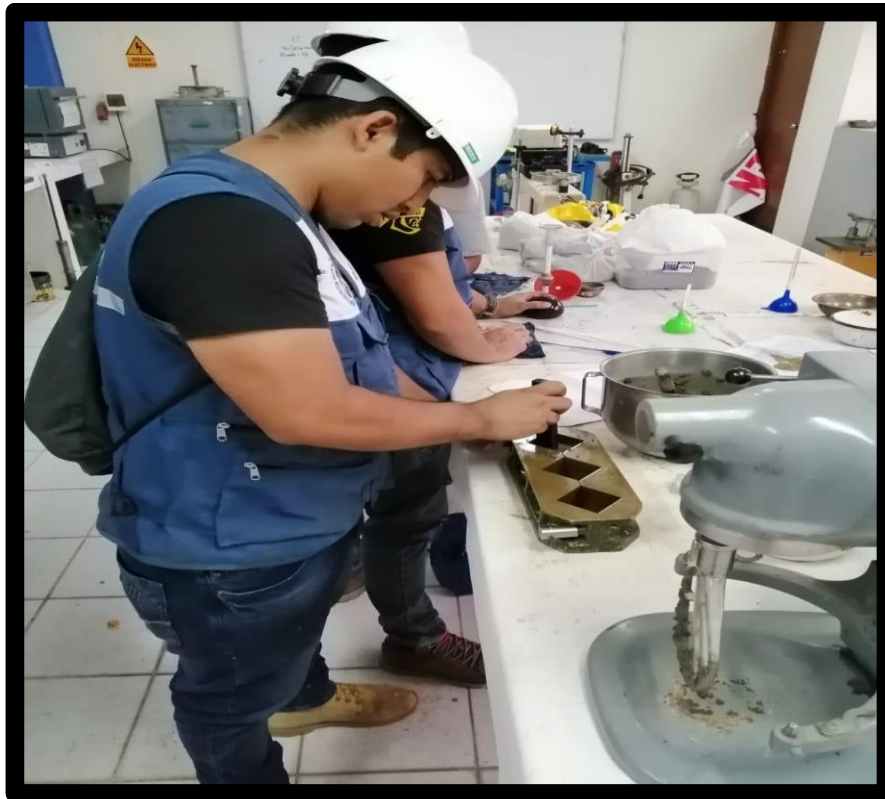
Foto 09: Vaciado de mortero patrón en moldes
