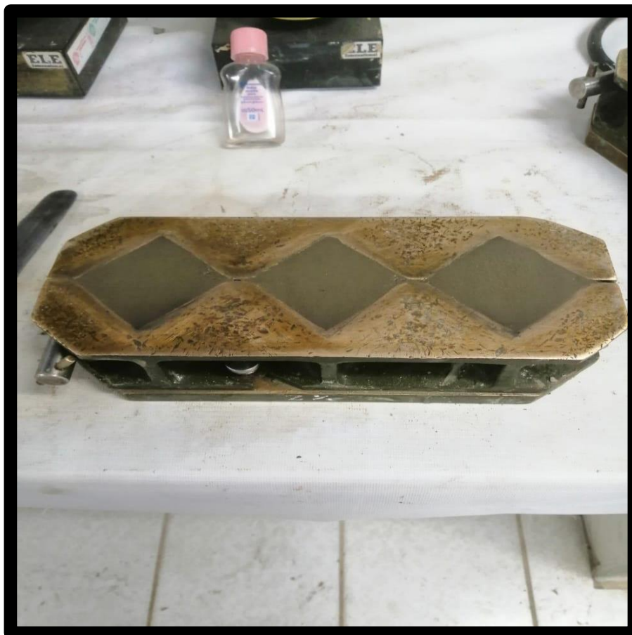
Foto 10: Fabricación de cubos de mortero patrón en moldes de 3 muestras
