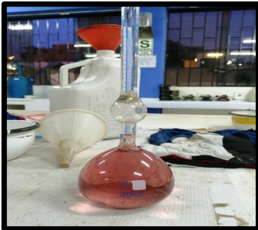
Foto 04: Ensayo de peso específico
