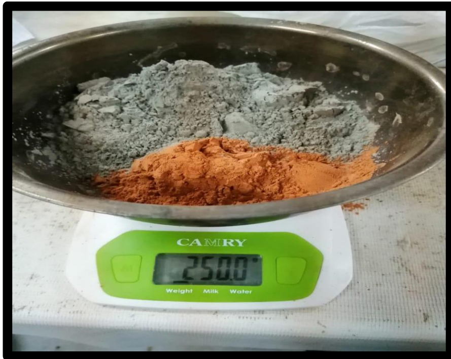
Foto 11: muestra de combinación de cemento y arcilla al 20% y 25 %.
