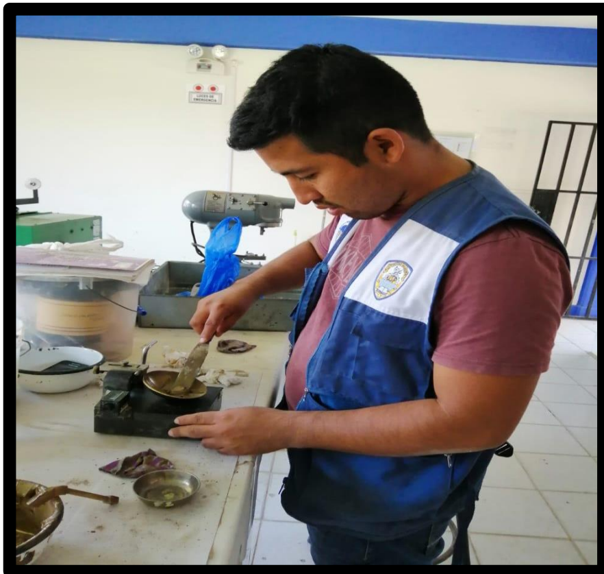
Foto 03: Ensayo limite liquido y plástico
