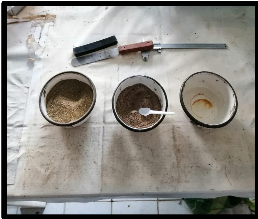
Foto 07: Dosificación de materiales para mortero patrón
