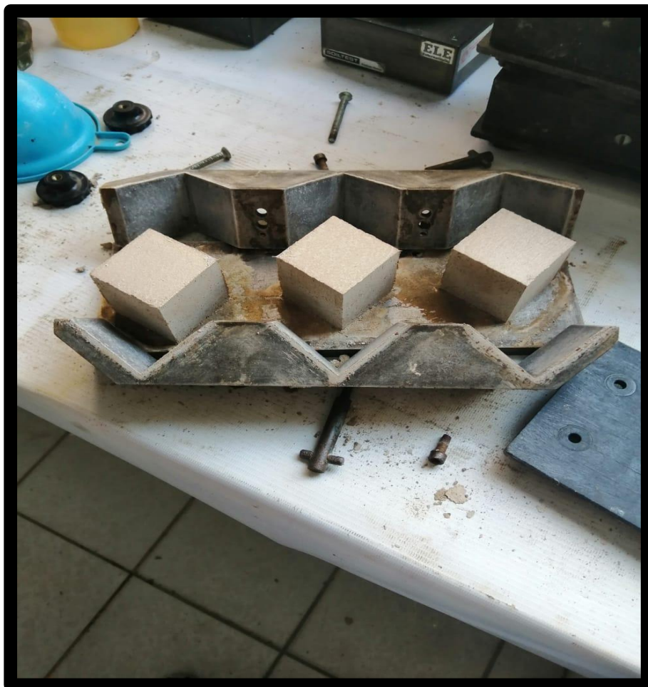
Foto 12: Desencofrado de moldes de mortero.
