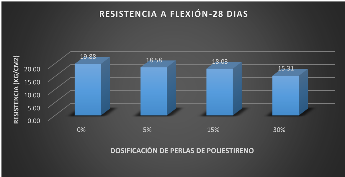
Figura 33. Ensayo de Resistencia a flexión ( F_r ) con edad de 28 días Fuente: Elaboración propia
