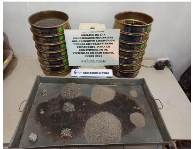
Fotografía 10. Tamizado de Agregado fino
