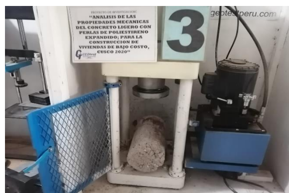
Figura 36. Rotura de briqueta a tensión indirecta 30%
