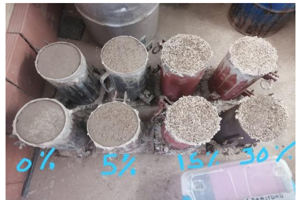
Fotografía 16. briquetas de concreto fresco
