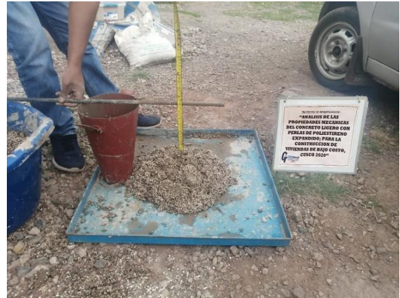
Fotografía 20. Slump concreto aligerado 30%
