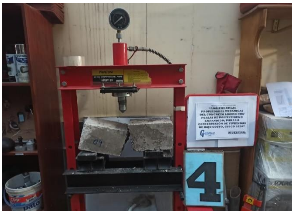
Figura 29. Rotura de vigueta 5%
