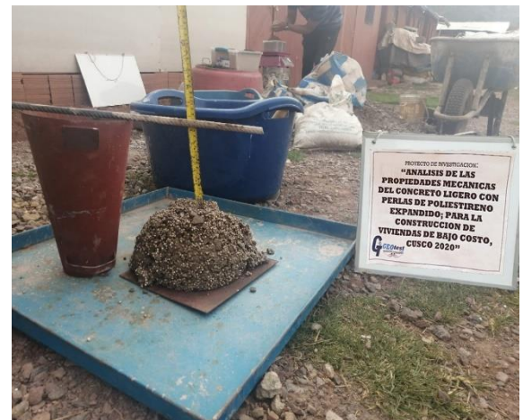
Fotografía 22. Slump concreto aligerado 15%
