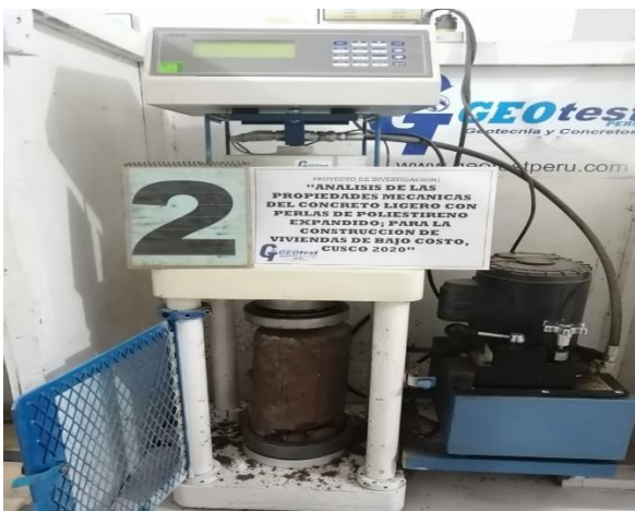
Fotografía 27. Ensayo a compresión 5%
