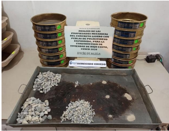
Fotografía 1. Tamizado de agregado grueso
