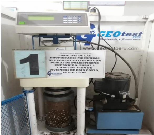
Figura 14. Rotura de briqueta 30%
