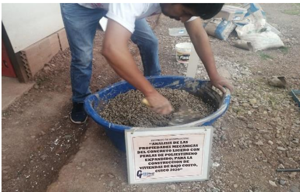
Fotografía 15. Preparando mezcla de concreto
