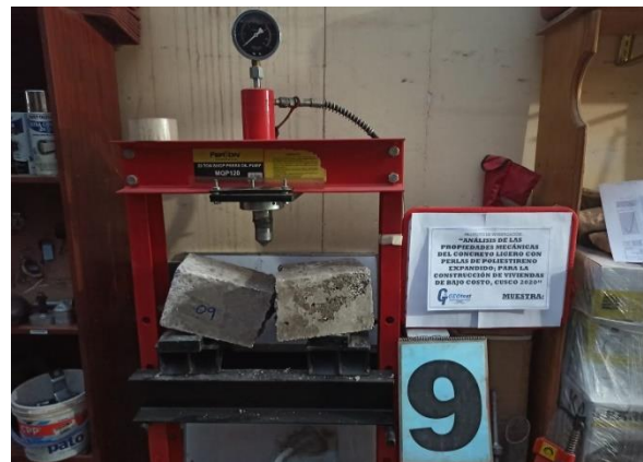
Figura 30. Rotura de vigueta 15%
