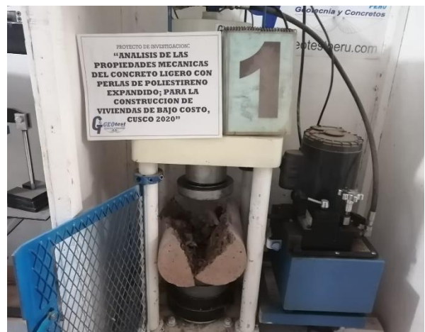
Fotografía 28. Ensayo tensión indirecta 5%
