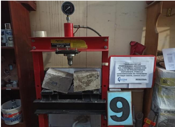
Fotografía 25. Ensayo a flexión 15%
