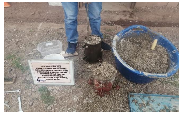
Fotografía 16. briquetas de concreto fresco
