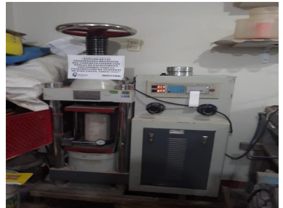
Fotografía 24. Ensayo modulo de elasticidad
