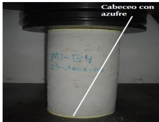
Figura 2. Ensayo de Resistencia a compresión ( f'c )
