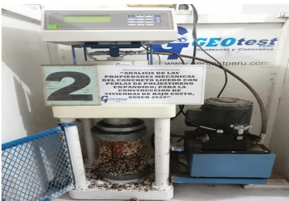
Fotografía 29. Ensayo a compresión 30%
