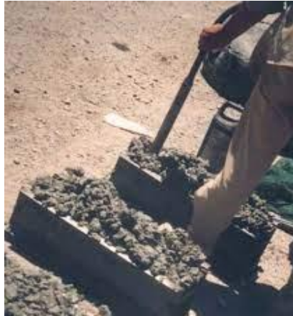
Figura 8. Compactación de los especímenes
