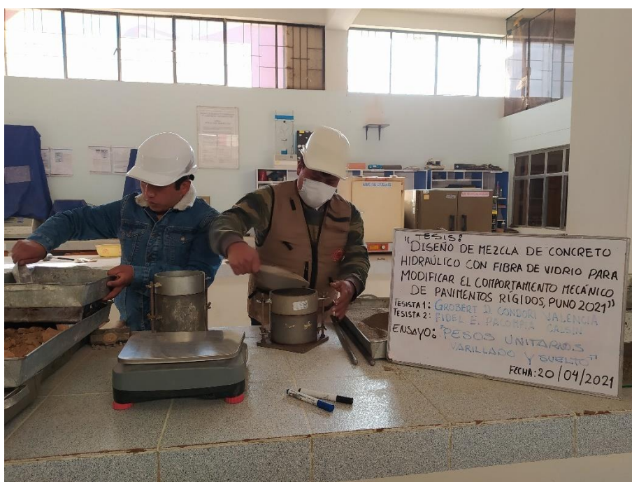
Figura 12. Ensayo del peso unitario agregado grueso
