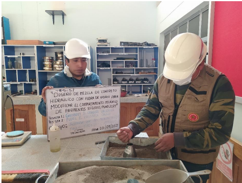
Figura 16. Prueba de revenimiento
