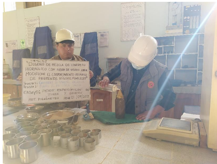
Figura 19. Incorporación del agua destilada
