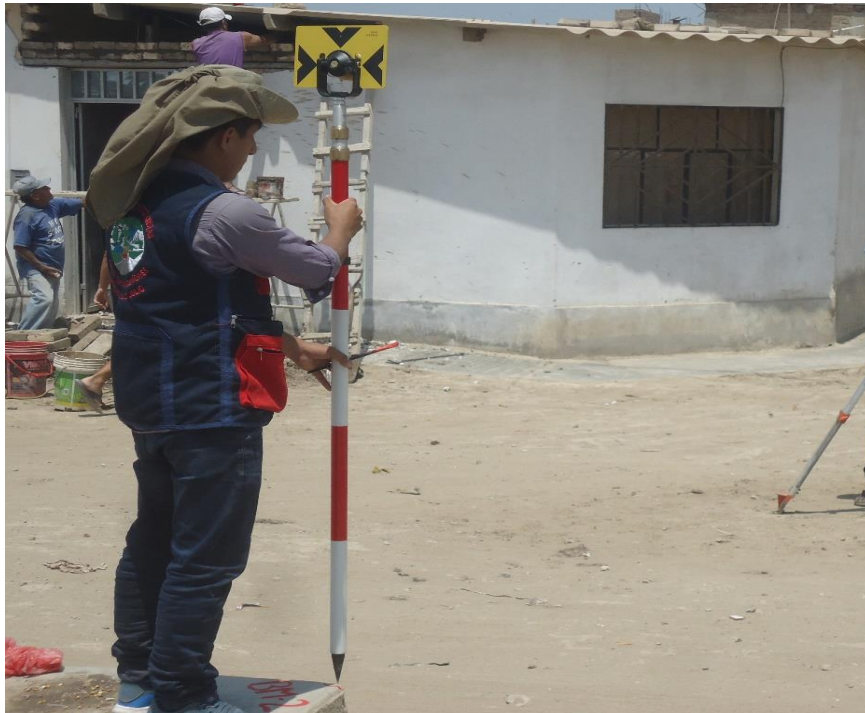
Foto N°1: Estudio Topográfico con lectura al BM-2
