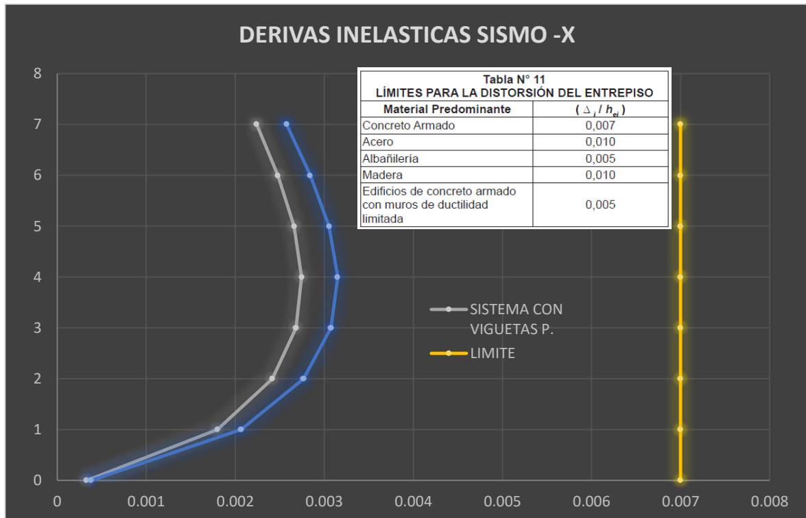
Figura: 49 Derivas Inelásticas en X-X
