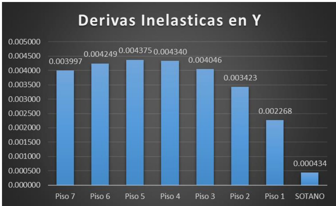
Figura: 46 Derivas Inelásticas en Y
