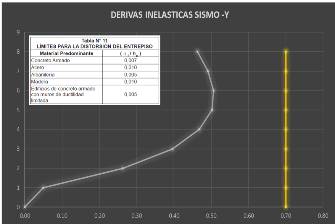
Figura: 43 Derivas con Respecto al Límite Permitido E-0.30 en Dirección Y
