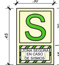
SEÑAL FOTOLUMINISCENTES ZONA SEGURA EN CASO DE SISMOS
