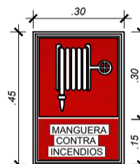
SEÑAL : GABINETE CONTRA INCENDIO
