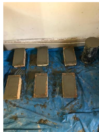
Figura 45: Diseño de mezcla de concreto patrón de adoquines terminado.
