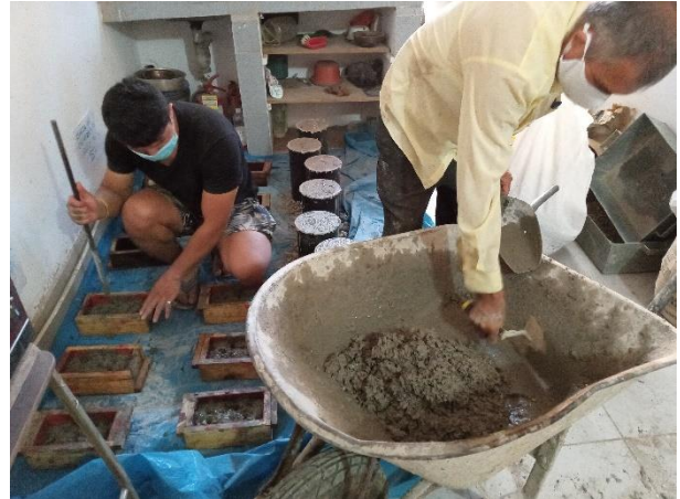
Figura 55: Preparación de mezcla con incorporación de ceniza de cascarilla de arroz al 10%.
