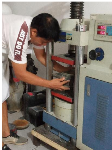
Figura 72: Adoquín listo para la rotura.
