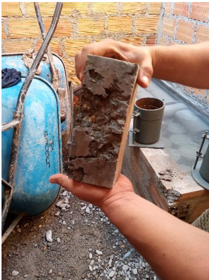
Figura 68: Rotura del adoquín de concreto patrón a los 7 días.
