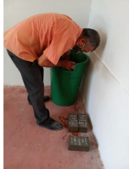
Figura 59: Colocación de los adoquines, para su respectivo curado a los 7, 14 y 18 días.
