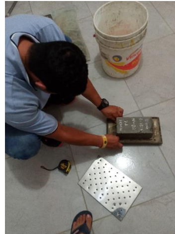
Figura 63: Medición y centrado para la prensa de rotura a compresión.
