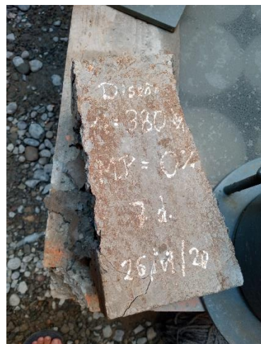
Figura 69: Estado del adoquín a rotura a los 7 días.
