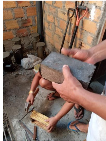
Figura 51: Adoquín terminado y listo para el curado respectivo.
