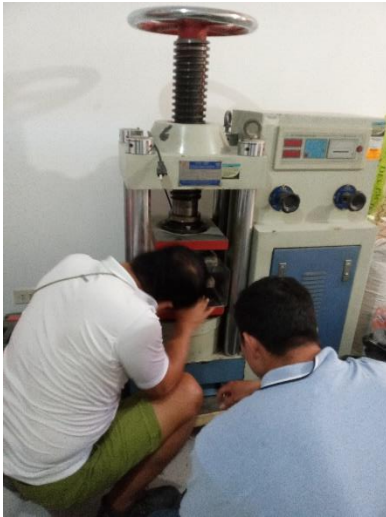
Figura 66: Retiro de la rotura a compresión del adoquín patrón.
