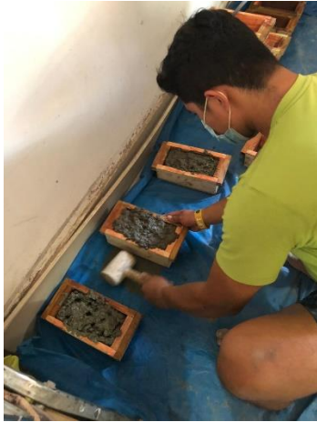
Figura 42: Golpes al molde con el martillo de goma, para evitar la cangrejera de la mezcla de concreto.
