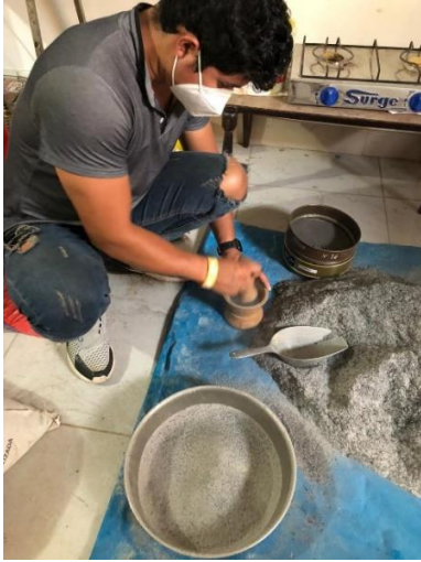
Figura 22: Machacado de la ceniza de cascarilla de arroz.
