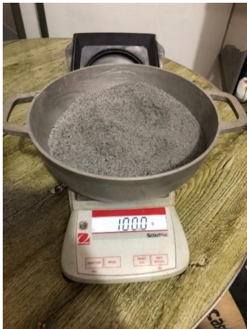
Figura 24: Pesado de la ceniza de cascarilla de arroz.
