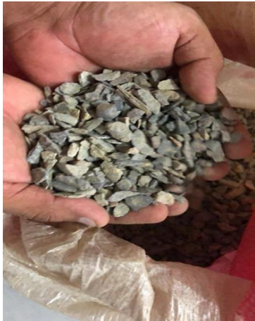
Figura 14: Agregado grueso para la mezcla de concreto.
