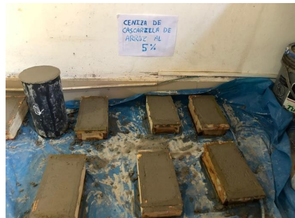
Figura 47: Diseño de mezcla con incorporación de ceniza de cascarilla de arroz al 5% terminado.
