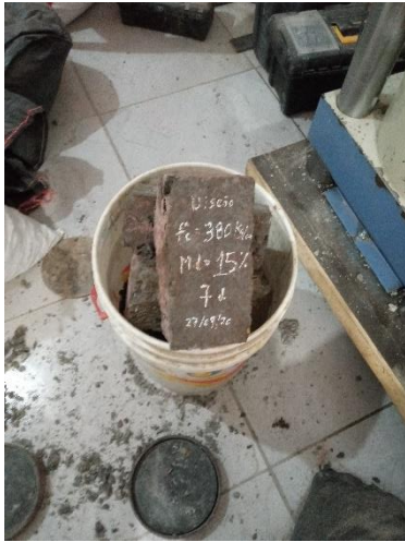
Figura 70: Roturas de los adoquines del 15% a los 7 días.
