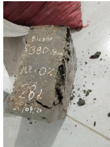
Figura 75: Rotura del adoquín al 0% a los 28 días.
