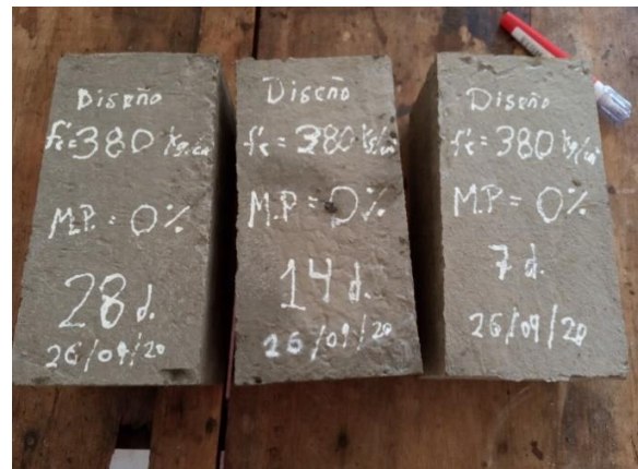
Figura 53: Adoquines al 0% que será curado a los 7, 14 y 28 días.
