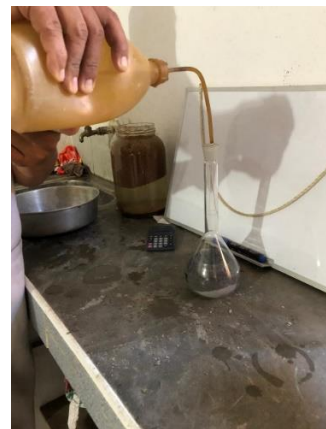
Figura 25: Introducción de la ceniza de cascarilla de arroz a la pipeta de ensayo.
