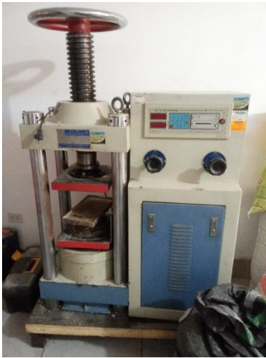
Figura 64: Prensa que mide la resistencia a la compresión.
