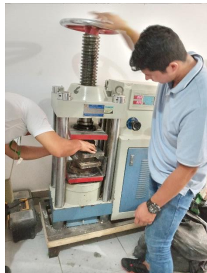
Figura 65: Colocación de los adoquines en la prensa de rotura.
