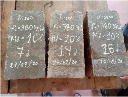
Figura 58: Adoquines al 10% que será curado a los 7, 14 y 28 días.
