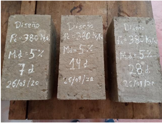
Figura 54: Adoquines al 5% que será curado a los 7, 14 y 28 días.
