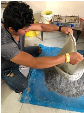
Figura 20: Verificación de la ceniza de cascarilla de arroz calcinada.
