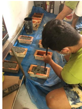
Figura 41: Compactación de la mezcla con una varilla de acero.
