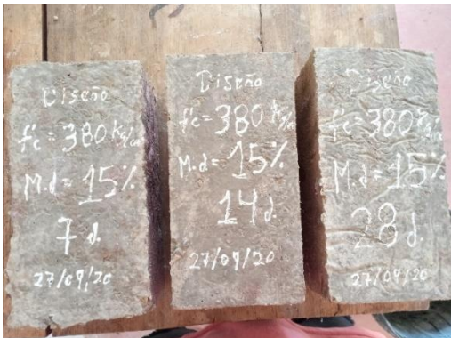
Figura 60: Adoquines al 15% que será curado a los 7, 14 y 28 días.
