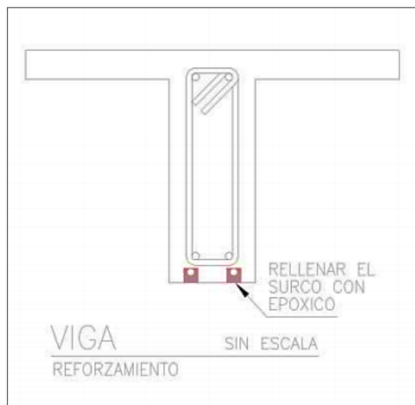
Figura 11. Relleno de surcos Fuente. Manual de técnicas de reforzamiento de estructuras
