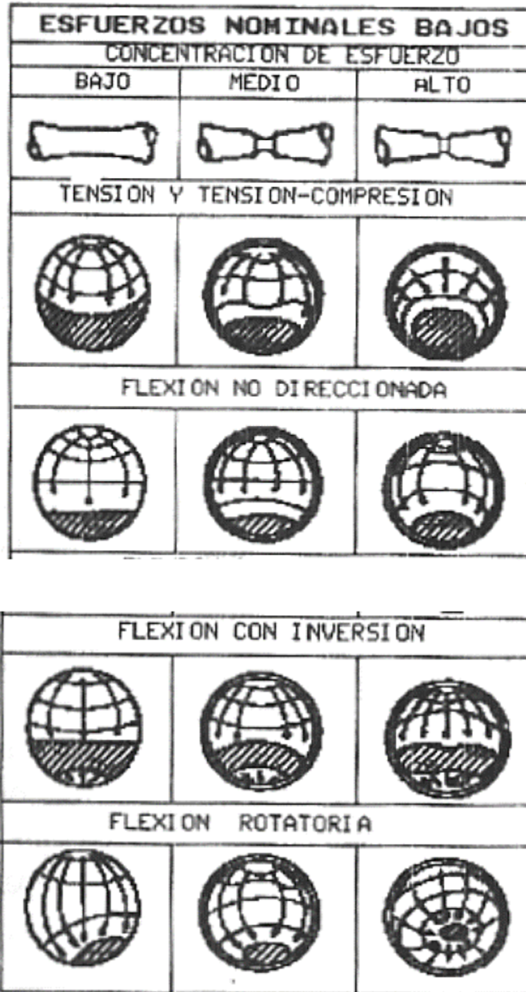
Figura 15. Estructuras esquematizadas de falla por fatiga para esfuerzos bajos. Fuente: https://bit.ly/3c4bIFN
