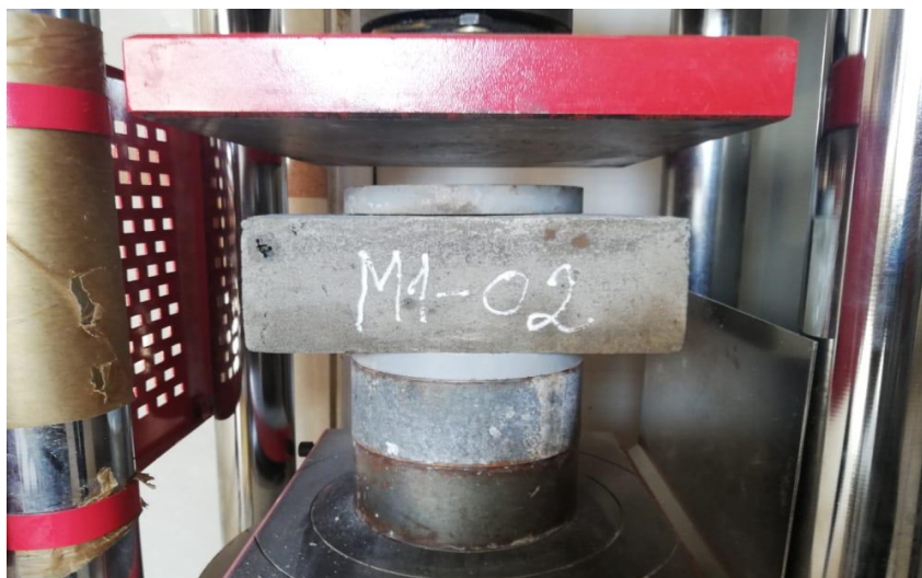
Fotografía 02: Ensayo de resistencia a la compresión
