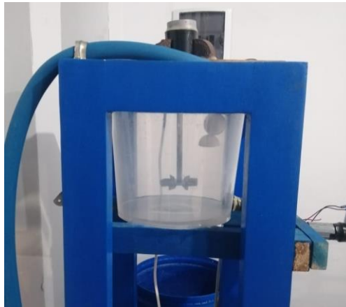
Ilustración III-3. Vista frontal del tanque reactor de mezcla rápida
