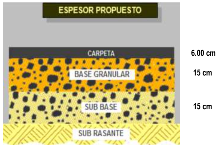
Figura 12. Espesor propuesto para el paquete estructural del pavimento flexible. Fuente: Elaboración propia
