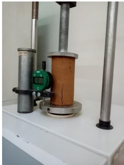
MUESTRA DEL SUELO DESPUES DEL ENSAYO DE COMPRESION SIMPLE
