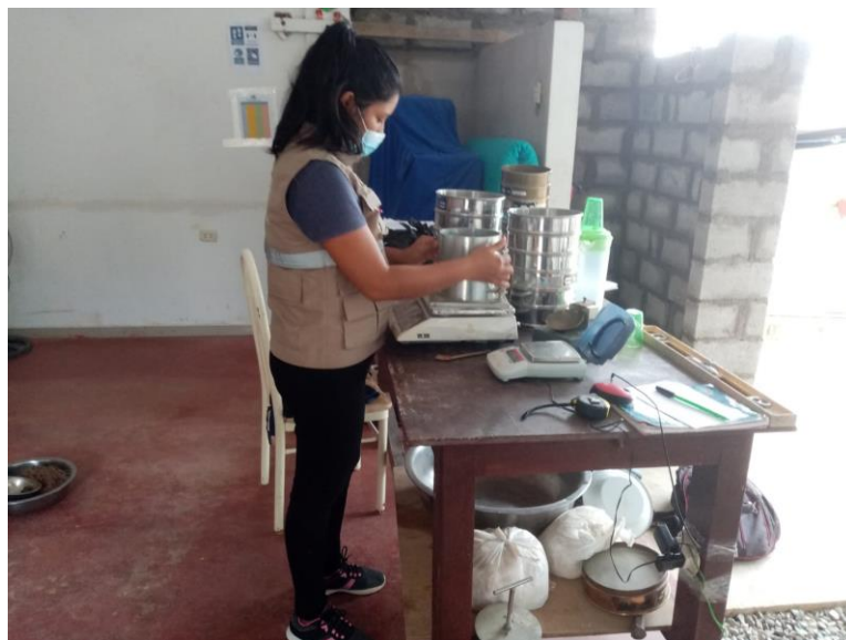
PESO DE LA MUESTRA PARA EL ENSAYO DE COMPACTACION
