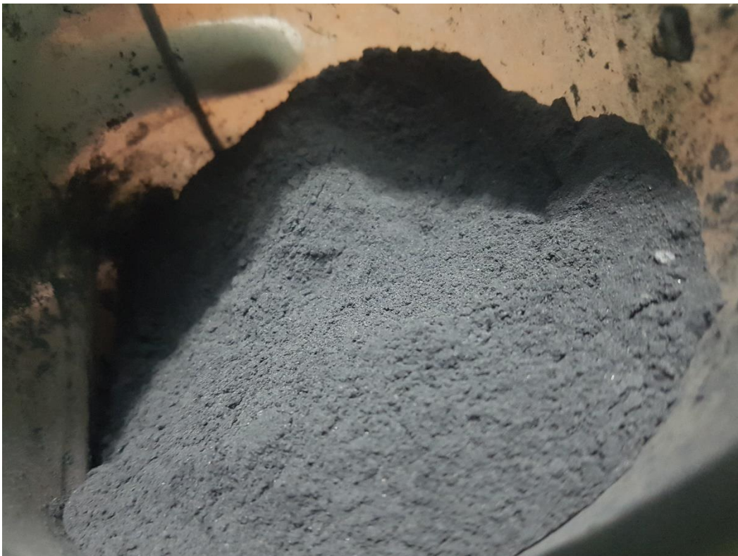
Imagen 2. Pulverización y calcinación de la cascara de naranja
