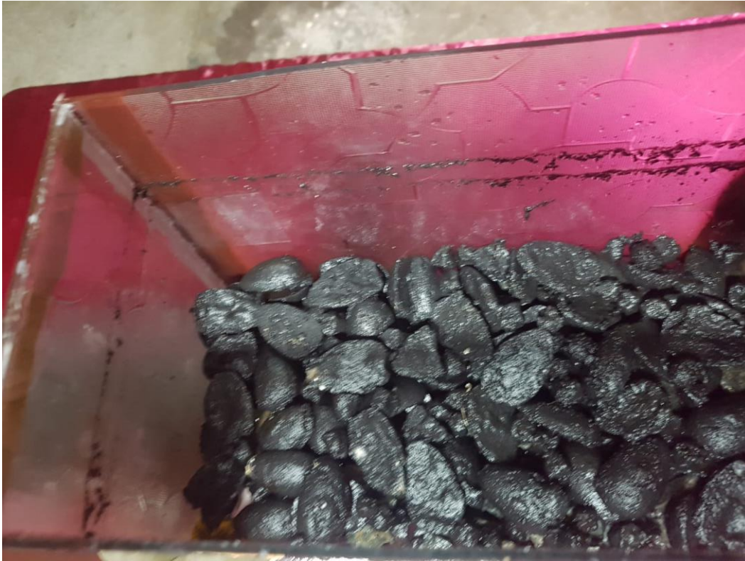
Imagen 15. Estado de las pastillas remediadoras posterior al tratamiento.
