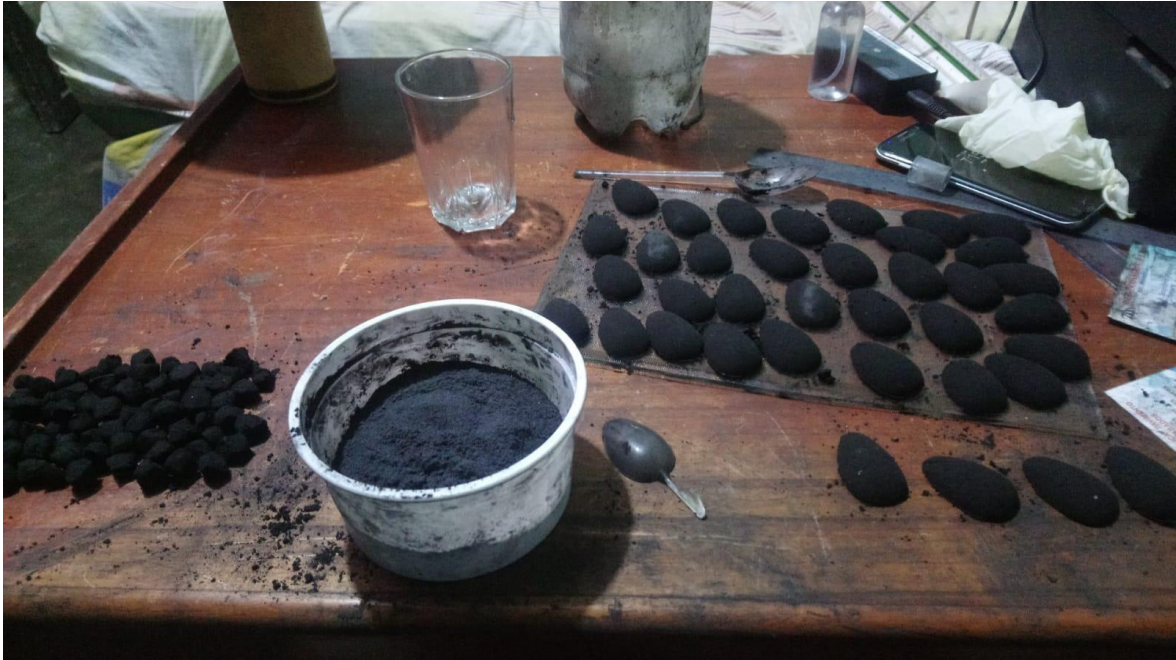
Imagen 5. Pastillas remediadoras previo a su secado.
