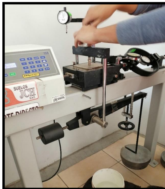
Figura 60: Colocación De Las Pesas Para Obtener El Esfuerzo Máximo
