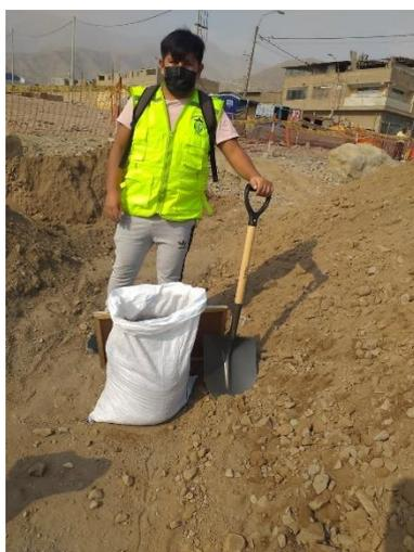
**Figura 16.** Obtención de la muestra, material granular. (Elaboración propia, 2021).
