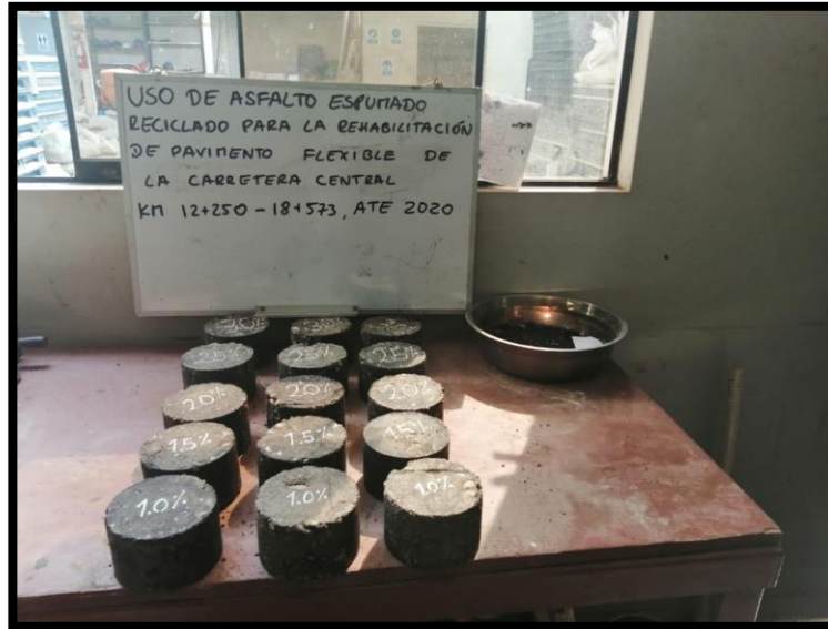
Figura 15. Briquetas con distintas dosificaciones de agua. Fuente: Propio
