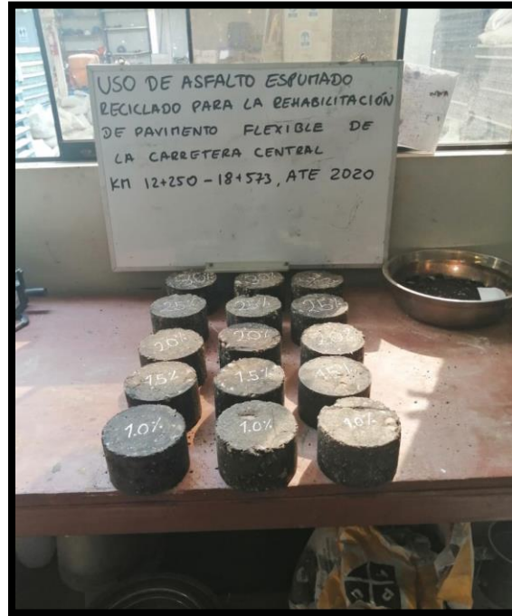
Figura 11. Muestras de las briquetas con sus respectivos % de agua. Fuente: Propia
