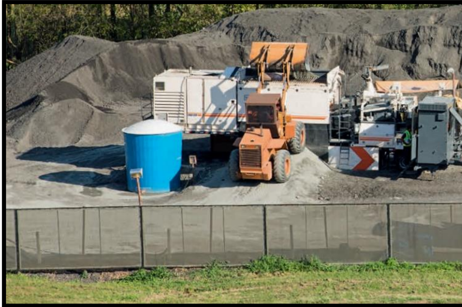
Figura 4. Planta móvil de reciclado en frío.
