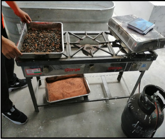
Fotografía 14. Secado de los agregados.
