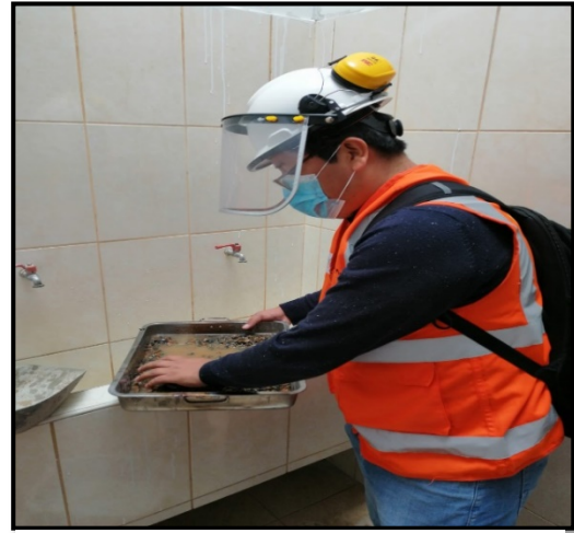
Fotografía 6. Muestra sumergida por 24horas.
