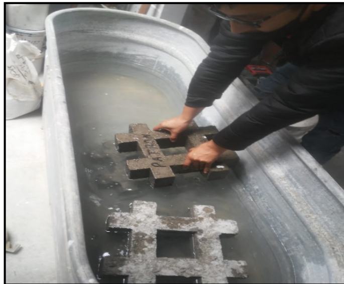
Fotografía 27. Ensayo de absorción sumergido 24 horas.
