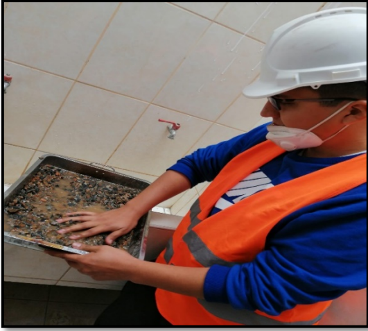
Fotografía 7. Muestra sumergida por 24horas.
