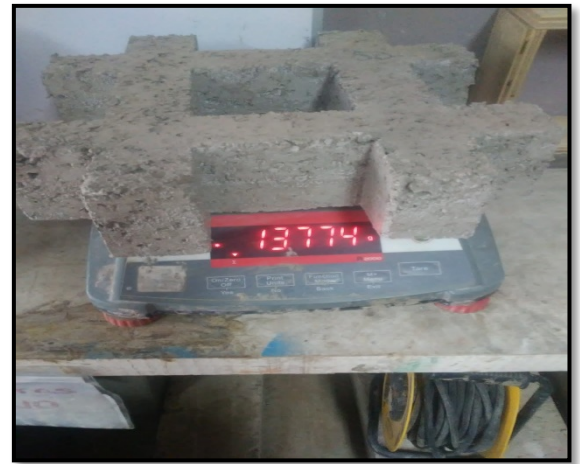
Fotografía 26. Ensayo de absorción pesado de block Grass.
