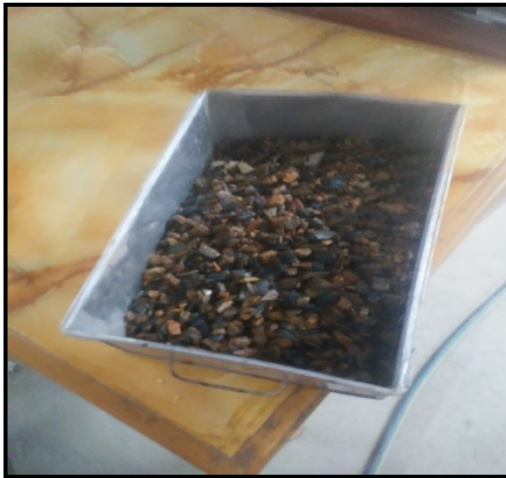
Fotografía 8. Muestra en estado triple sss del
