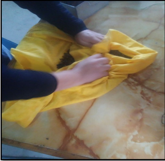
Fotografía 10. Secado superficial del agregado grueso
