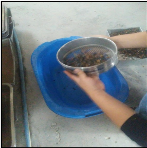
Fotografía 5. Ensayo de granulometría.
