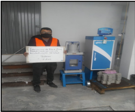
Fotografía 24.. Ensayo de resistencia de compresión de patrón de 7 Días.
