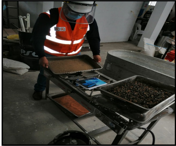
Fotografía 9. Secado de agregados.
