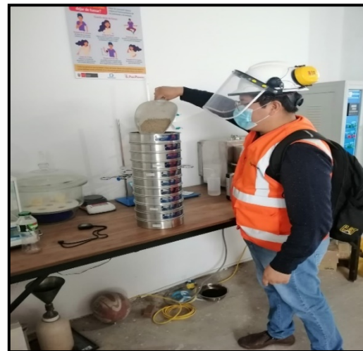
Fotografía 4. Ensayo de granulometría.
