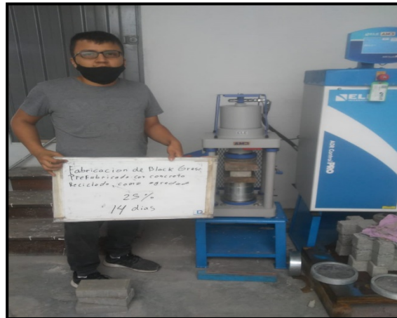
Fotografía 23. Ensayo de resistencia de compresión de 25% 14 Días.
