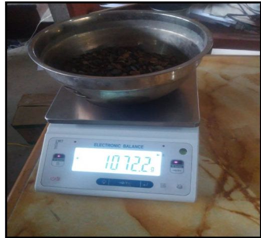
Fotografía 9. Peso de muestra en triple sss.
