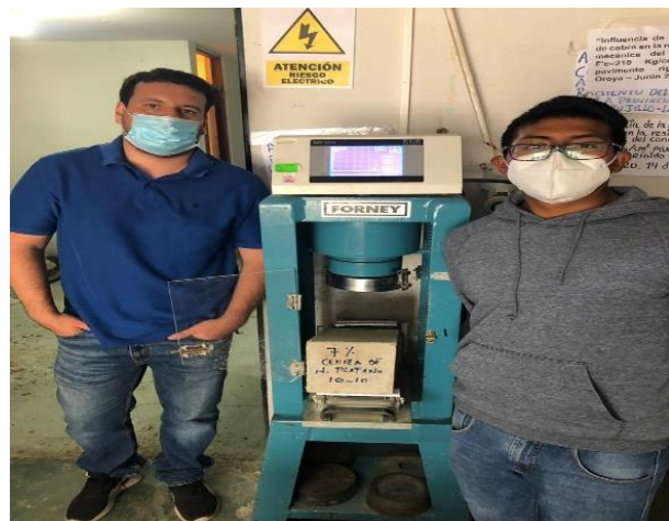
Figura 17. Ruptura de vigueta a los 28 días.
