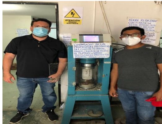
Ruptura de espécimen cilíndrico con adición de 21% del ceniza a los 28 días.
