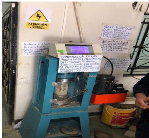
Ruptura de espécimen cilíndrico con reemplazo del 21% de vidrio a los 28 días.
