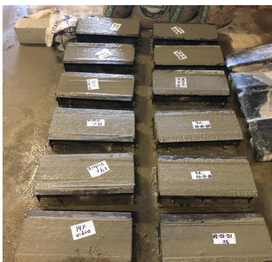
Especímenes prismáticos con reemplazo parcial del cemento de vidrio y ceniza en porcentajes de 7%, 14% y 21%.
