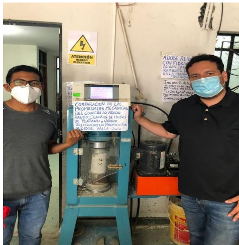
Ruptura de espécimen cilíndrico con reemplazo del 7% de vidrio a los 28 días.
