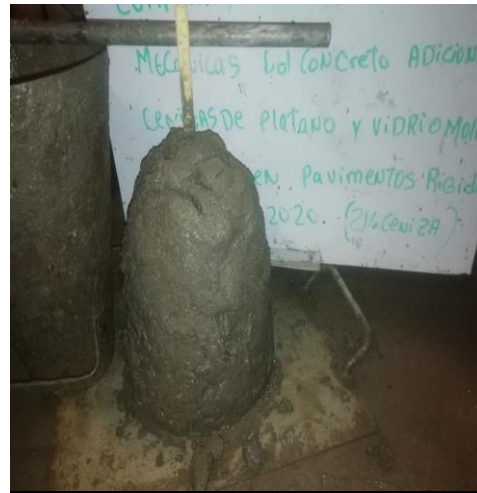
Ensayo slump para el concreto con 21% de ceniza.
