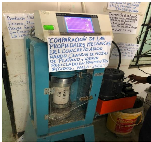
Ruptura de espécimen cilíndrico con reemplazo del 14% de vidrio a los 28 días.
