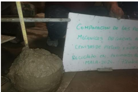
Ensayo slump para el concreto con 7% de vidrio.
