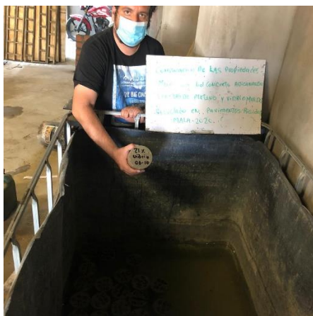
Colocado de especímenes cilíndricos en tanque de agua para curado a las edades de 7, 14 y 28 días.
