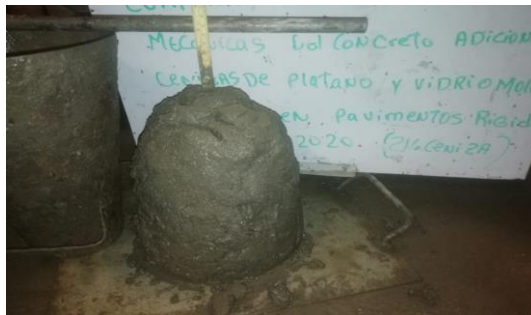
Ensayo slump para el concreto con 7% de ceniza.
