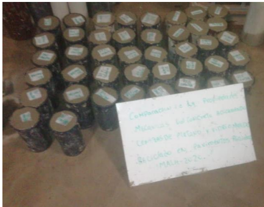
Vaciado en moldes de probeta 4" x 8" de los especímenes a compresión.
