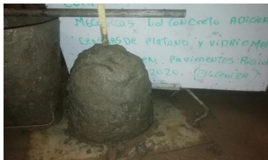
Figura 15. Ensayo slump para el concreto con 21% de ceniza.
