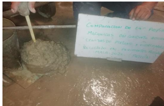
Ensayo slump para el concreto patrón.
