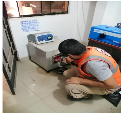
Figura 11. Incineración de las hojas de plátano a 500 ° C.
