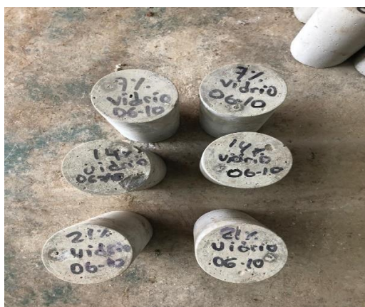
Especímenes cilíndricos con vidrio listo para el ensayo a compresión a los 28 días.
