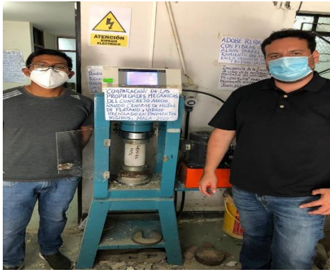
Ruptura de espécimen cilíndrico con reemplazo del 14% de ceniza a los 28 días.
