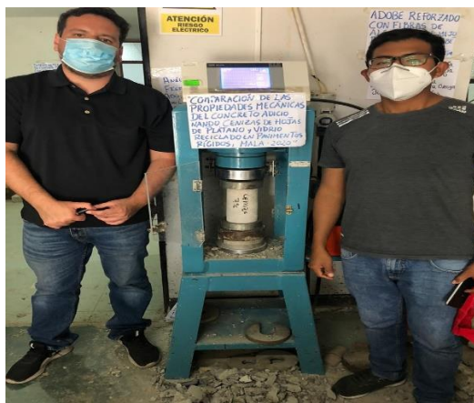
Ruptura de espécimen cilíndrico con reemplazo del 7% de ceniza a los 28 días.
