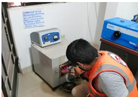
Calcinación y extracción de cenizas de hojas de plátano.
