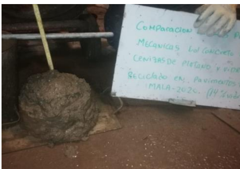
Ensayo slump para el concreto con 14% de vidrio.
