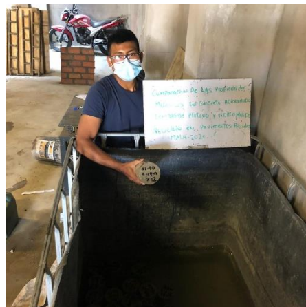
Colocado de especímenes cilíndricos en tanque de agua para curado a las edades de 7, 14 y 28 días.
