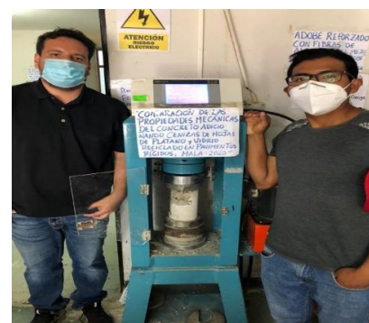
Figura 13. Ruptura del espécimen patrón con un f'c 234.07 kg/cm 2 a los 28 días.
