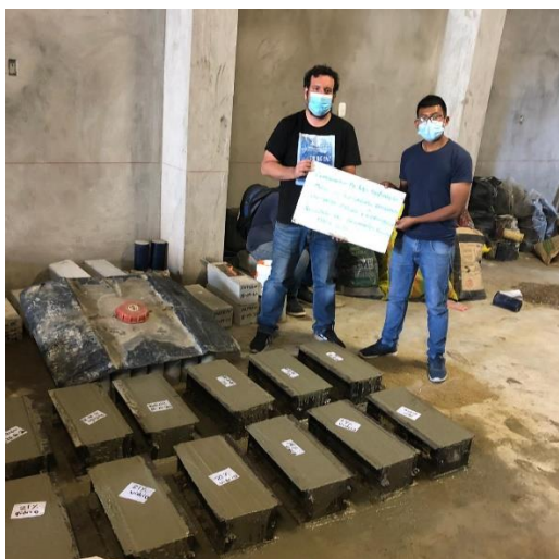
Vaciado en moldes prismáticos de 15 x 15 x 50 cm de los especímenes a ensayos de flexión.
