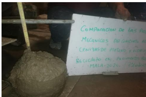
Figura 14. Ensayo slump para el concreto con 21% de vidrio.
