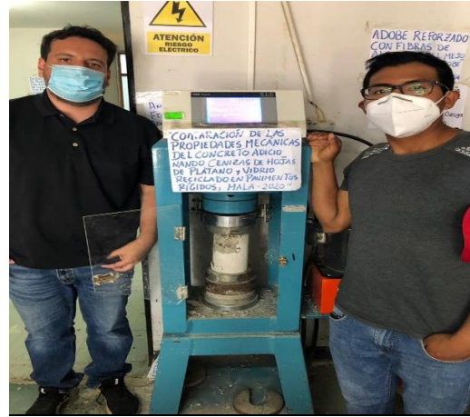
Ruptura del espécimen patrón con un f'c 234.07 kg/cm 2 a los 28 días.
