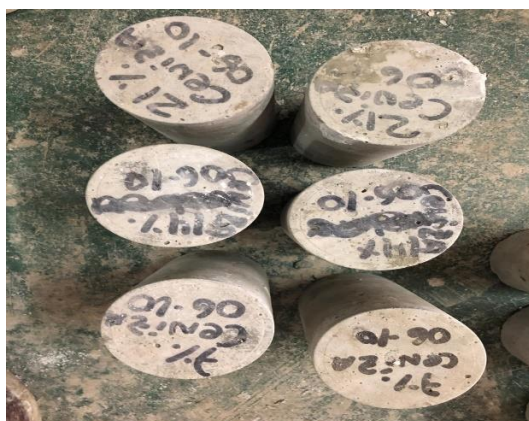
Especímenes cilíndricos con ceniza listo para el ensayo a compresión a los 28 días.
