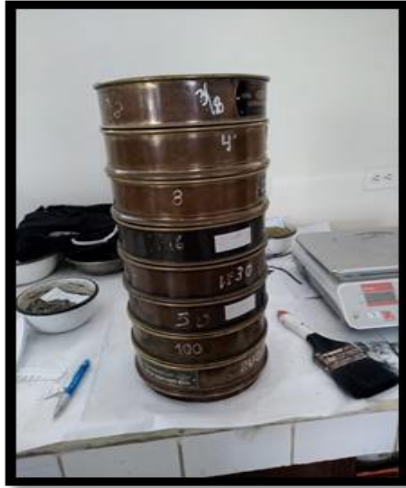
Figura N°08 : Ensayo de Granulometría de los agregados
