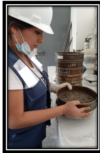
Figura N°08 : Ensayo de Granulometría de los agregados
