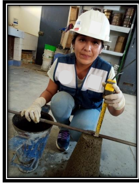
Figura N°14: Verificación del Asentamiento Como resultado un slump de 0.5”.
