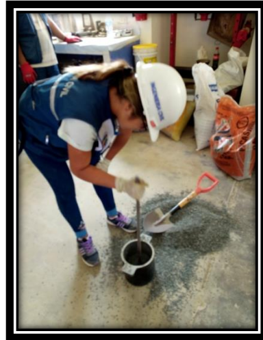
Figura N°07 : Ensayo de Peso unitario y compactado del Agregado fino y grueso
