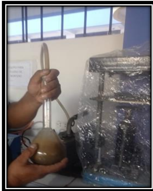
Figura N°13: Ensayo de Peso Específico y Absorción del Agregado Fino
