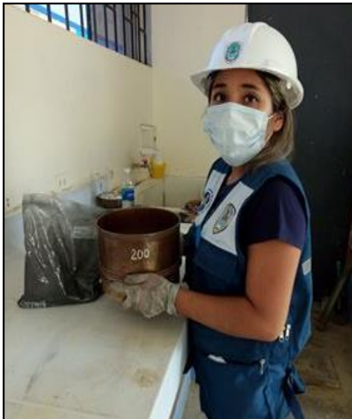
FIGURA Nº 06: Tamizando por la malla #200 para luego sacar la muestra para el ensayo de fluorescencia de rayos de la ceniza de carbón de piedra y ceniza de concha de abanico
