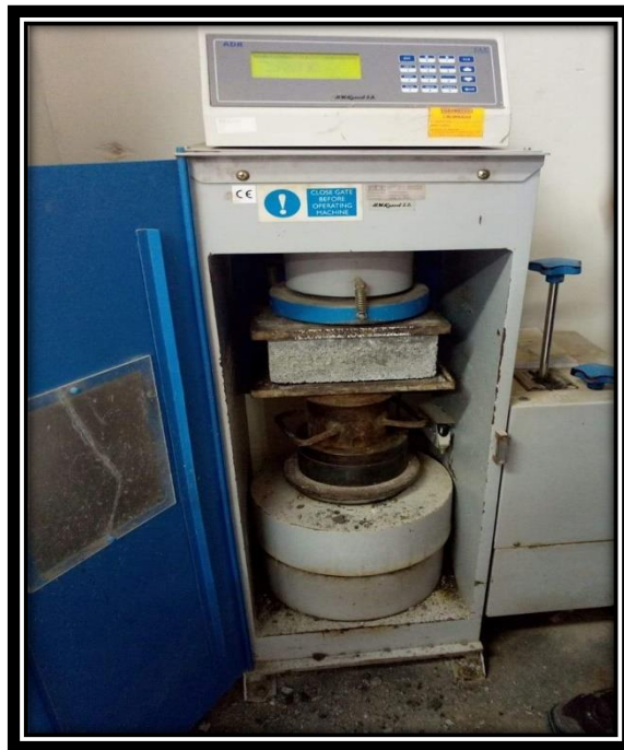
Figura N°17: Realizar el ensayo de compresión
