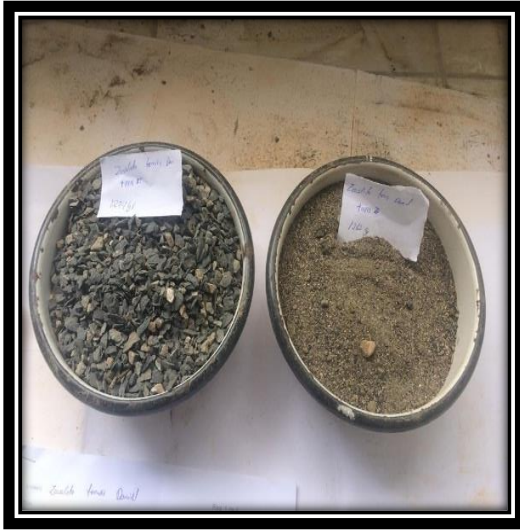
Figura N°09: Ensayo de contenido de humedad
