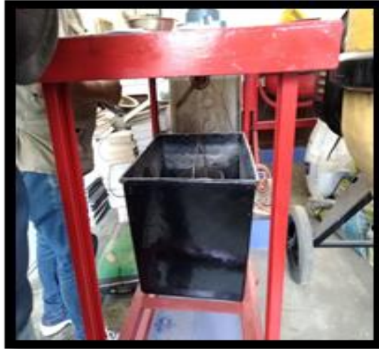
Figura N°12: Ensayo de Gravedad Específica y Absorción
