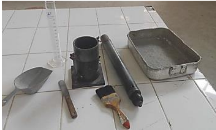
Fotografía N°11: Materiales para ensayo de Proctor
