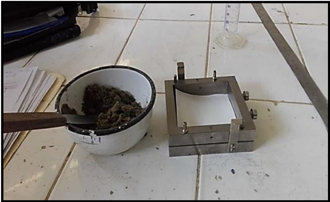
Fotografía N°12: Preparación de la muestra antes de ser colocada a la caja de corte directo
