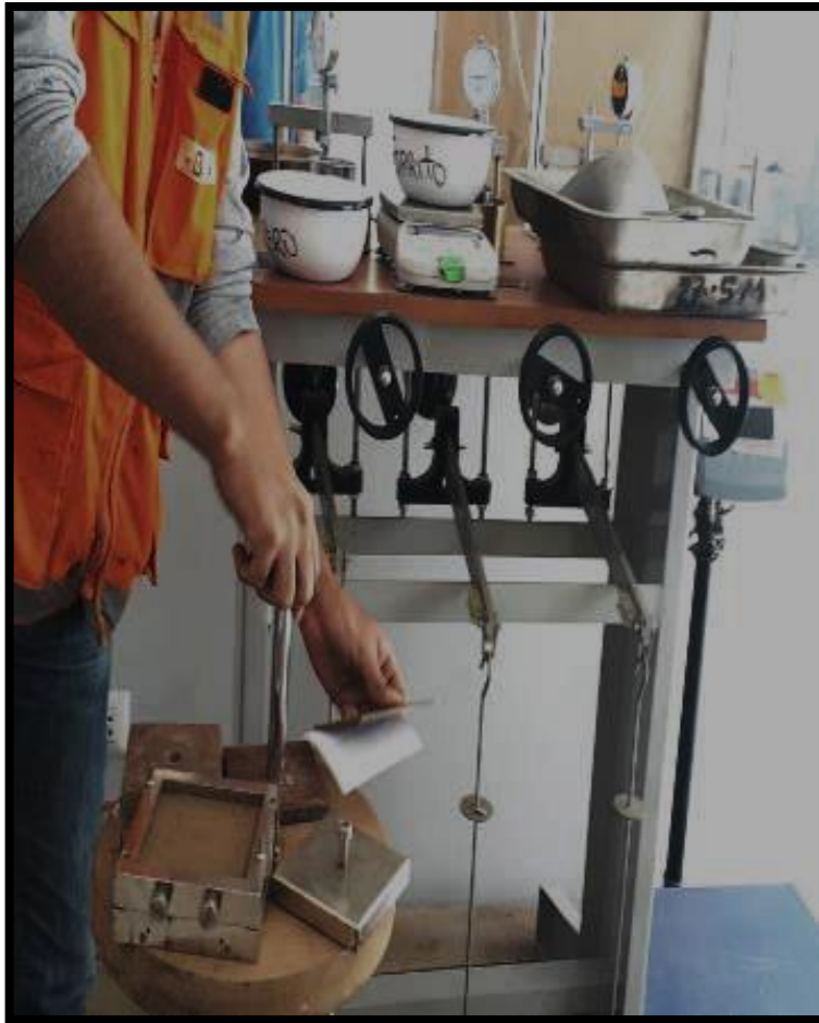
Fotografía N°13: Compactación de la muestra dentro de la caja de corte con un pisón.
