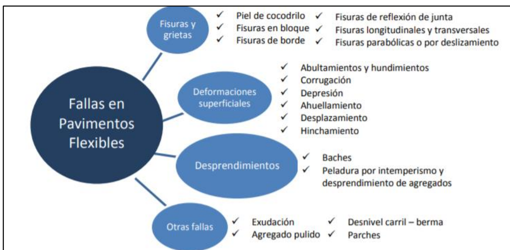
Figura 5: Fallas en pavimentos Flexibles
