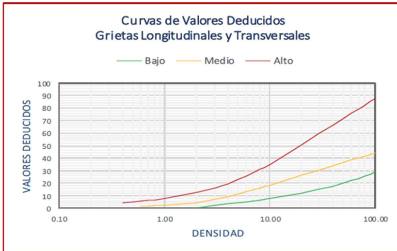
Figura 25: Valor deducido para grietas longitudinales y transversales severidad alta muestra 1
