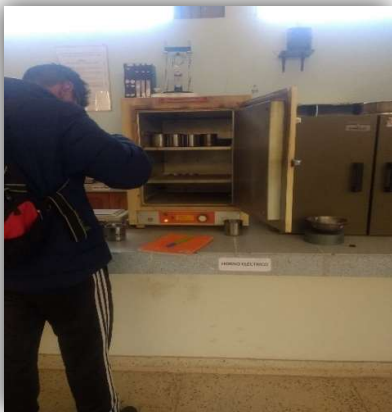
Realización de la prueba de laboratorio (contenido de humedad)
